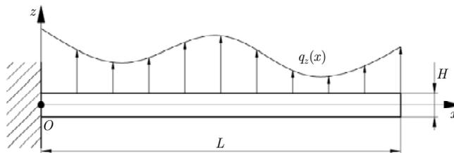
Slika 3.3 Poprečno ravno savijanje (jednostrano uklještene) monotone grede.
