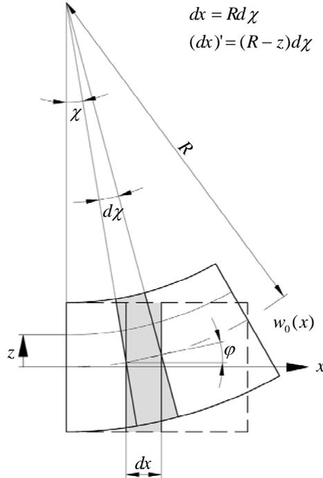
Slika 2.1 Linearizirana kinematika ravnog savijanja Euler-Bernoullijeve grede.
