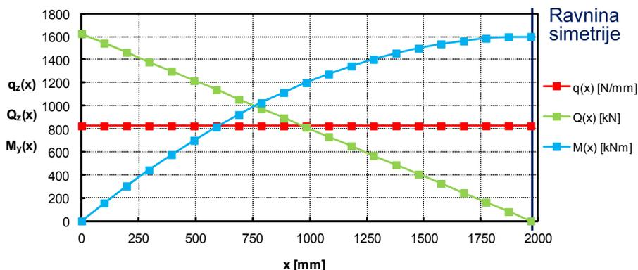
Slika 4.46 Kvantitativni prikaz poprečnog opterećenja sukladno raspodjeli R1.
