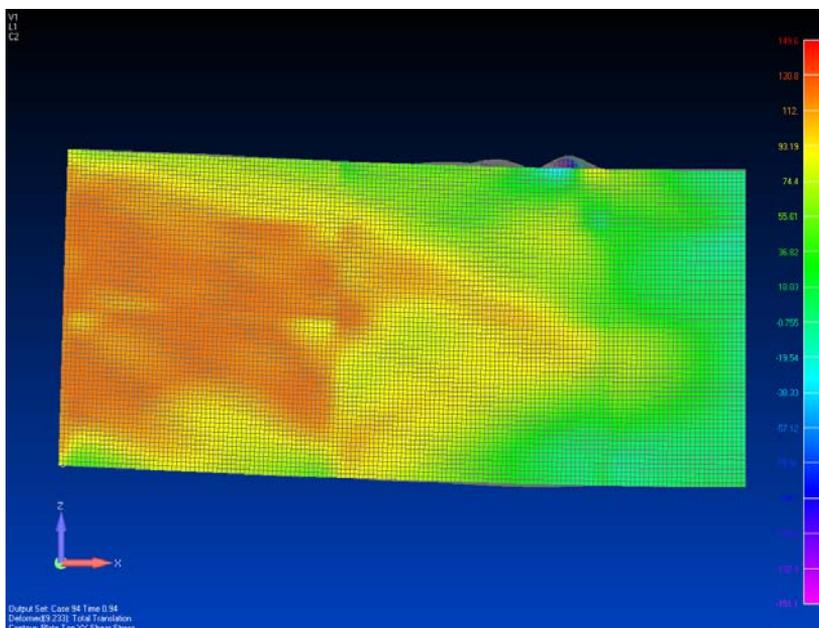
Slika 4.65 Deformirani NLMKE model konstrukcije P1A u graničnom stanju nosivosti (R2):  $\tau_{xy}$   $[\text{N/mm}^2]$ .
