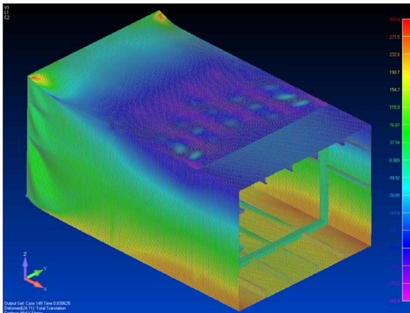
Slika 4.59 Deformirani NLMKE model konstrukcije P1A u graničnom stanju nosivosti (R1):  $\sigma_x$  za središnju plohu (eng. *mid-plane*) elemenata [N/mm<sup>2</sup>].
