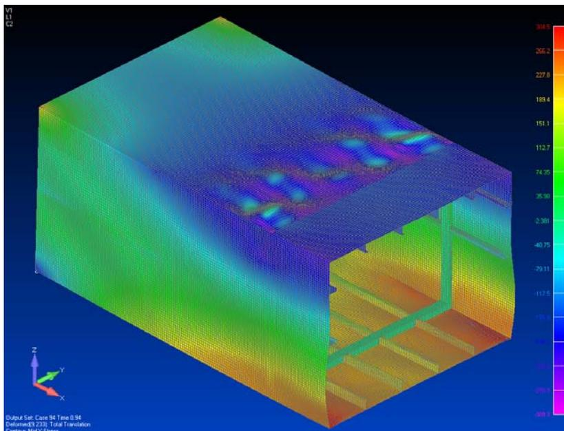
Slika 4.63 Deformirani NLMKE model konstrukcije P1A u graničnom stanju nosivosti (R2):  $\sigma_x$  za središnju plohu (eng. *mid-plane*) elemenata [N/mm<sup>2</sup>].
