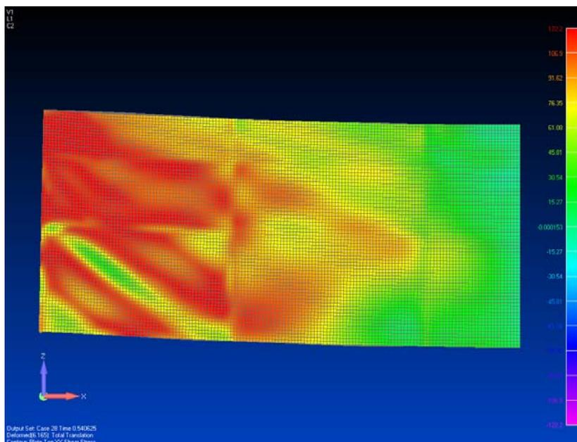
Slika 4.44 Deformirani (polovinski) NLMKE model konstrukcije P1 opterećen raspodjelom R2 u graničnom stanju nosivosti (54.1 % opterećenja):  $\tau_{xy}$  [N/mm<sup>2</sup>].
