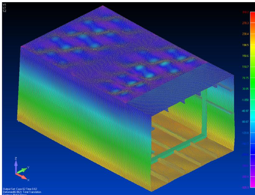
Slika 4.57 Deformirani NLMKE model konstrukcije P1A u graničnom stanju nosivosti (čisto savijanje):  $\sigma_x$  za središnju plohu (eng. *mid-plane*) elemenata [N/mm<sup>2</sup>].
