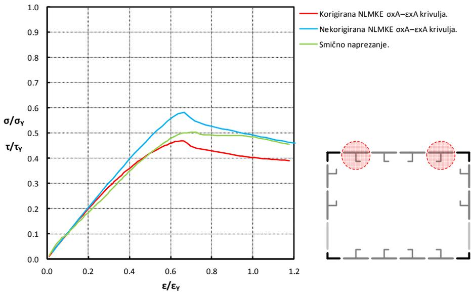
Slika 4.69 Uzdužna i smična nosivost diskretnih sastavnih elemenata („vanjskih“) ukrepa sa sunosivom širinom oplata gornjeg pojasa konstrukcije P1A pri R1.
