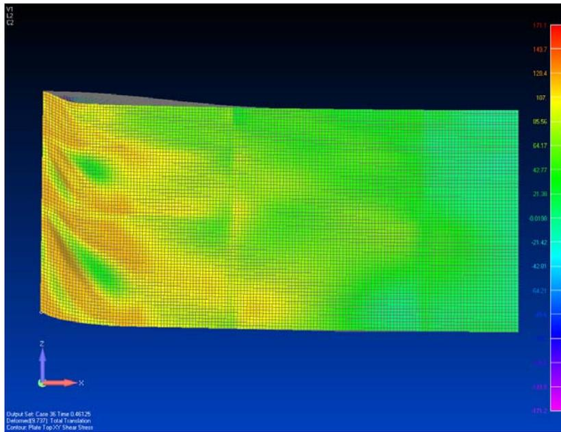
Slika 4.43 Deformirani (polovinski) NLMKE model konstrukcije P1 opterećen raspodjelom R1 u graničnom stanju nosivosti (46.1 % opterećenja):  $\tau_{xy}$  [N/mm<sup>2</sup>].
