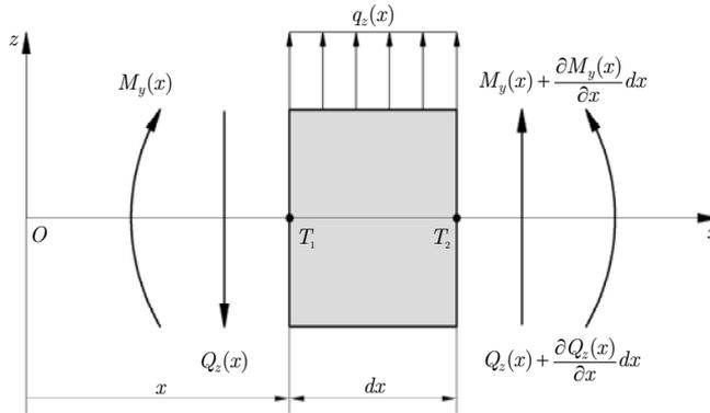
Slika 3.9 Opterećenje diferencijalnog segmenta grede pri poprečnom savijanju.
