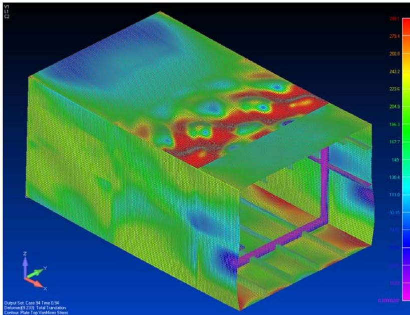
Slika 4.64 Deformirani (polovinski) NLMKE model konstrukcije P1A u graničnom stanju nosivosti (R2): Ekvivalentna (VonMises) napreznja  $[\text{N/mm}^2]$ .
