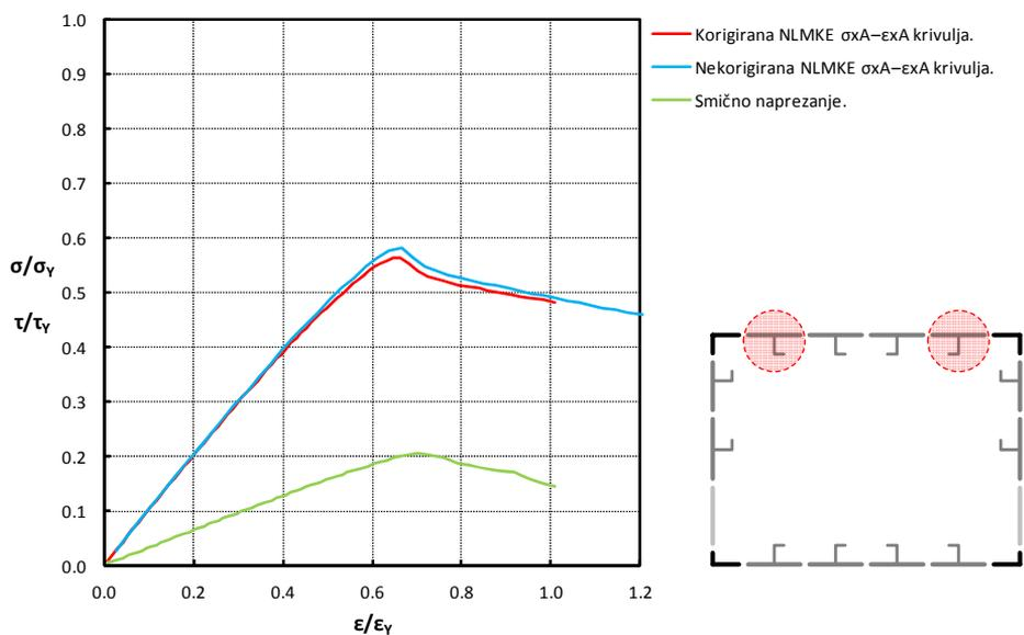
Slika 4.73 Uzdužna i smična nosivost diskretnih sastavnih elemenata („vanjskih“) ukrepa sa sunosivom širinom oplata gornjeg pojasa konstrukcije P1A pri R2.
