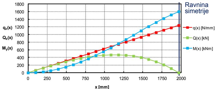
Slika 4.47 Kvantitativni prikaz poprečnog opterećenja sukladno raspodjeli R2.
