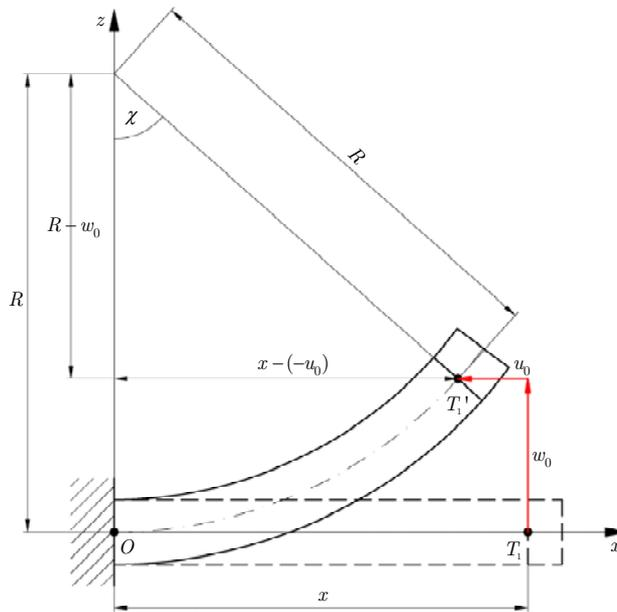
Slika 3.5 Čisto ravno savijanje (jednostrano uklještene) monotone grede.
