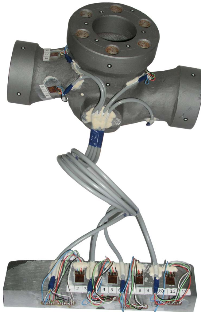
Slika 4.12 Kućište s zalijepljenim tenzometrima spojenim u polu-most s kompenzacijskim tenzometrima
