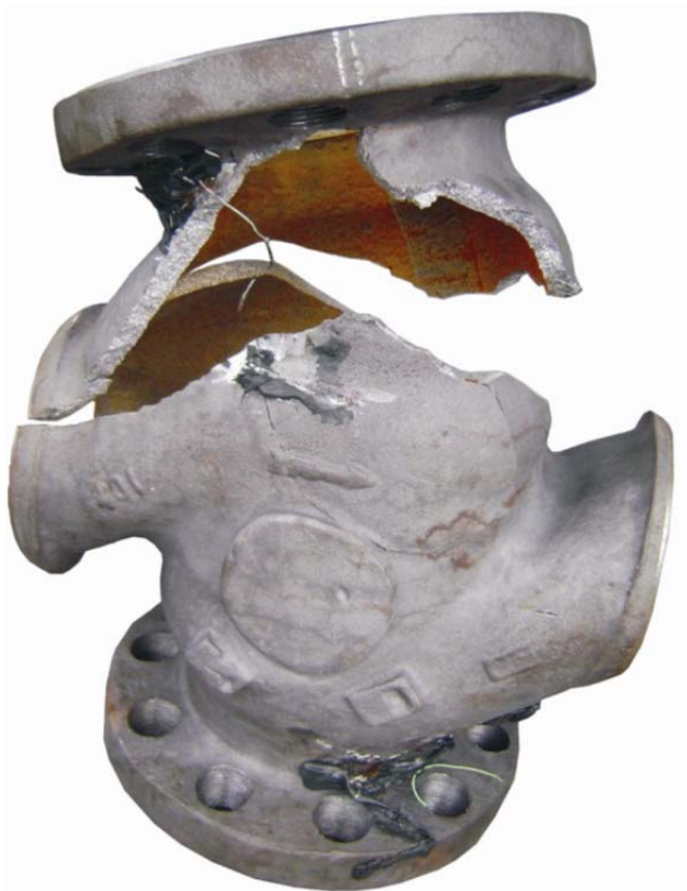
Slika 4.4 Prikaz slomljenog kućišta
