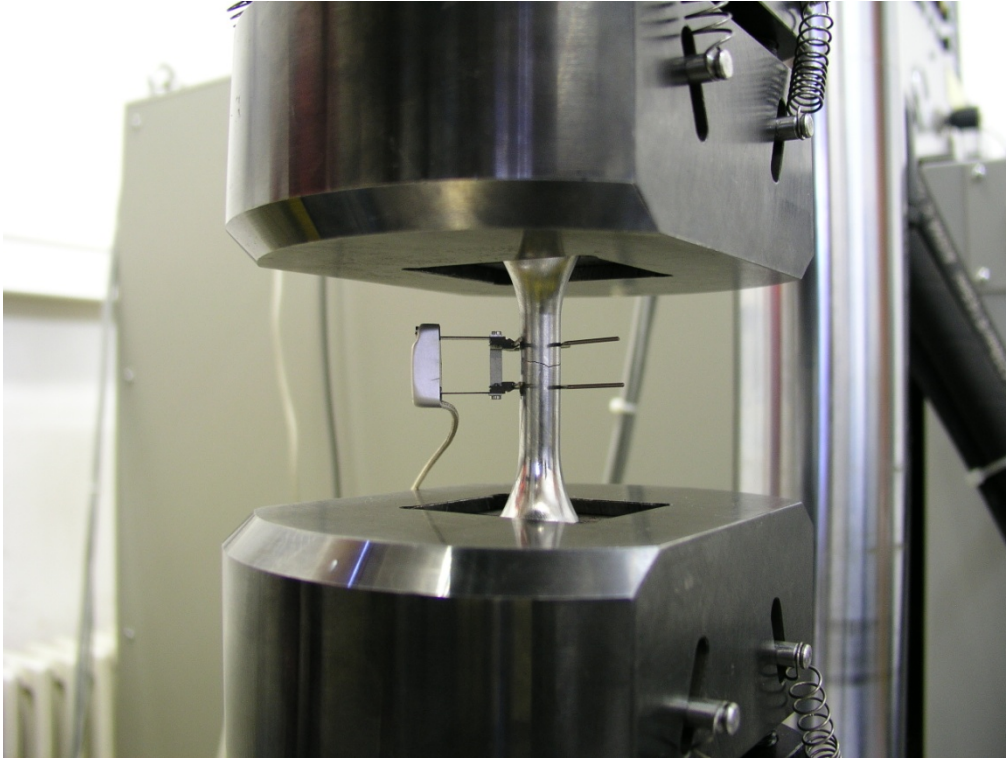
Slika 3.3 Ispitana epruveta s mjernim ekstenzometrom i nastalom pukotinom
