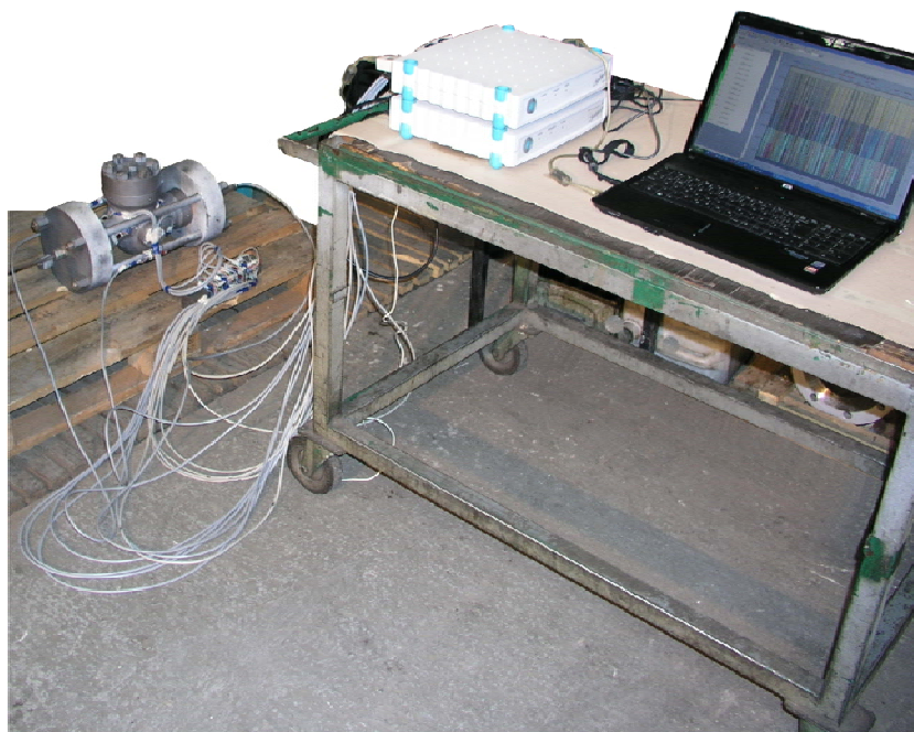
Slika 4.15 Ispitivanje deformiranja kućišta ventila
