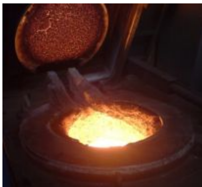
Slika 6. Elektropeč za taljenje metala
