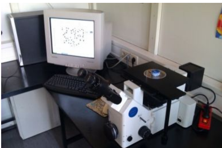
Slika 11. Svjetlosni mikroskop Olympus GX51
