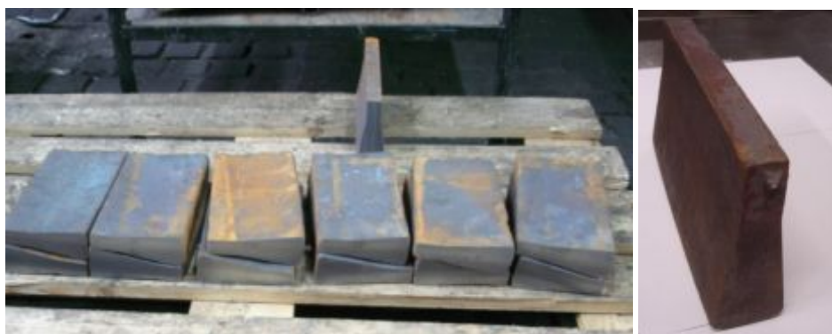
Slika 7. Odlivene Y probe za izradu ispitnih uzoraka (epruveta)
