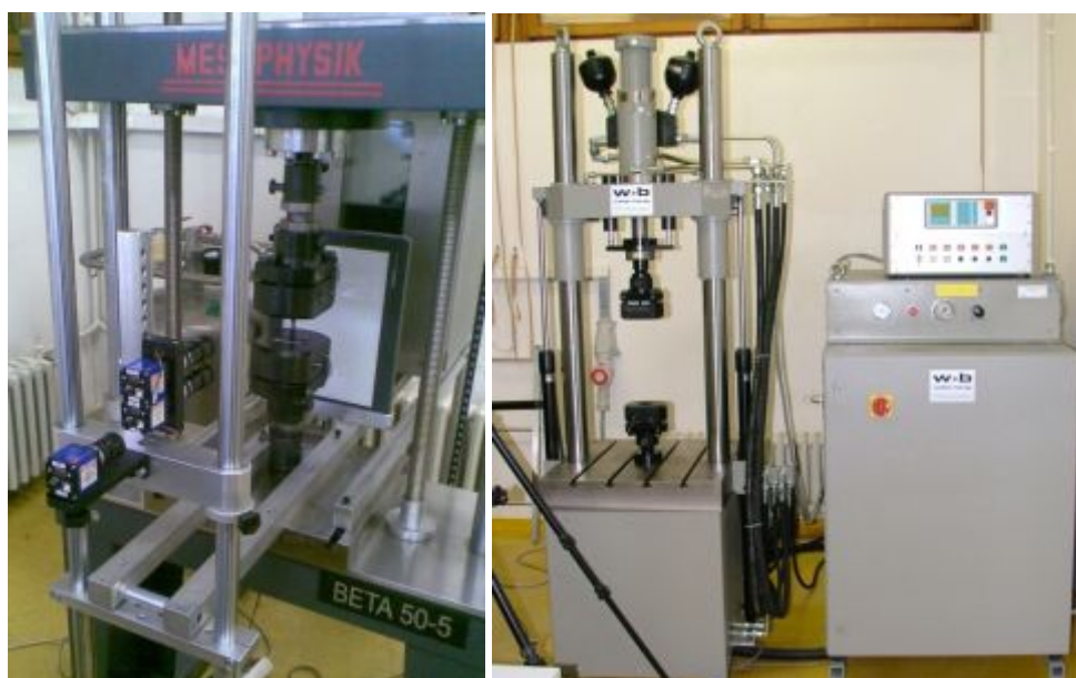
Slika 13. Kidalice za ispitivanje materijala: a) statička, Beta 50-5, Messphysik Austrija; b) dinamička, LFV 50-HH; Walter, Bai AG
