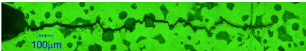
Slika 65. Pukotina u sekundarnoj mikrostrukturi ispitivanog nodularnog lijeva
