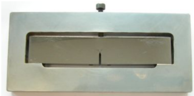
Slika 48. Naprava za opterećenje SENB epruveta
