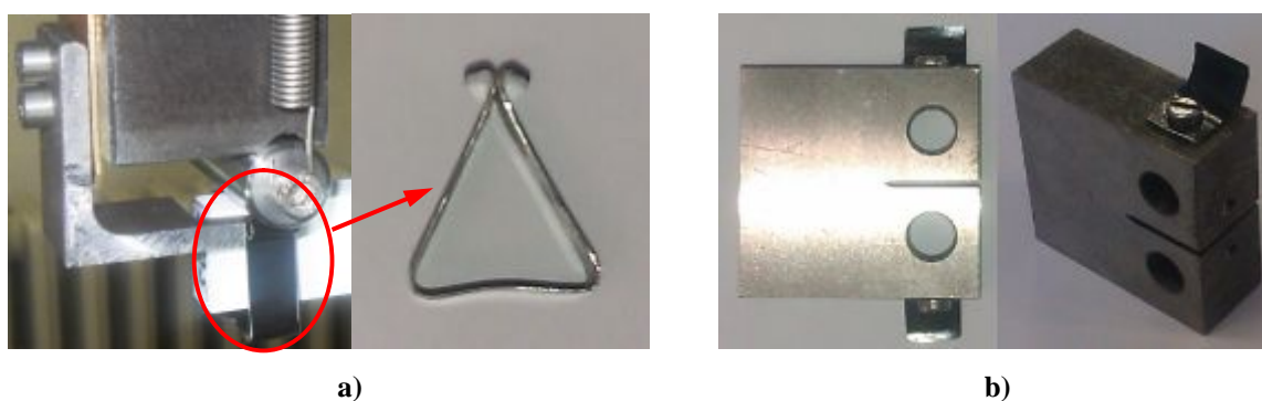
Slika 57. Pozicioniranje epruveta lisnatim oprugama: a) SENB epruvete, b) CT epruvete
