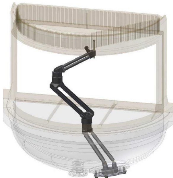
Slika 15. Prototip Spyder M1 u radnom položaju [18]
