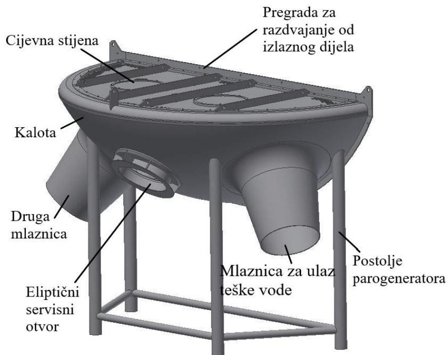
**Slika 6. CAD model makete polovice kalote parogeneratora s karakterističnim dijelovima**
