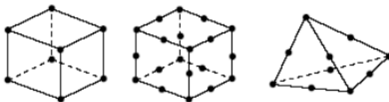
Slika 15. Najčešće korišteni 3D ( continuum elements ) konačni elementi, [20]
