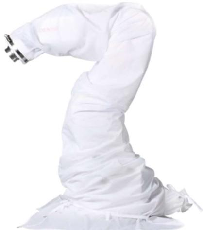
Slika 39: Zaštitni rukav robotske ruke [40]
