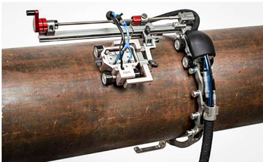
Slika 1. Nerazorna servisna inspekcija [6]
