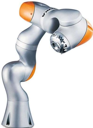
Slika 38: KUKA IIWA robotska ruka [39]
