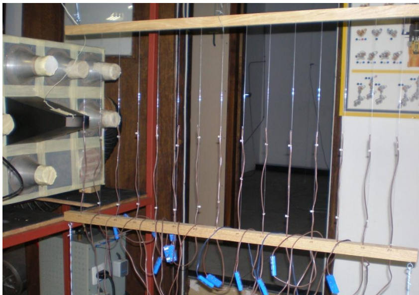
Slika 14. Termoparovi u struji zraka, pravokutni istrujni otvor
