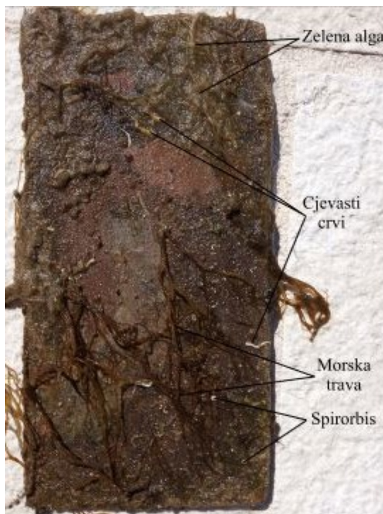
Slika 22. Detaljan prikaz obraštaja na SPC2 uzorku
