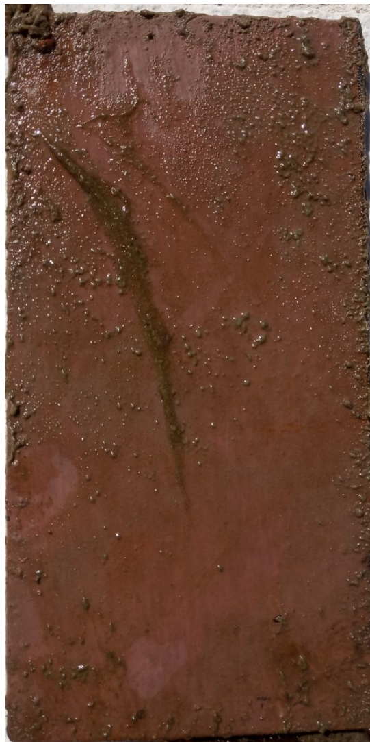
Slika 21. Detaljan prikaz obraštaja na SPC1 uzorku
