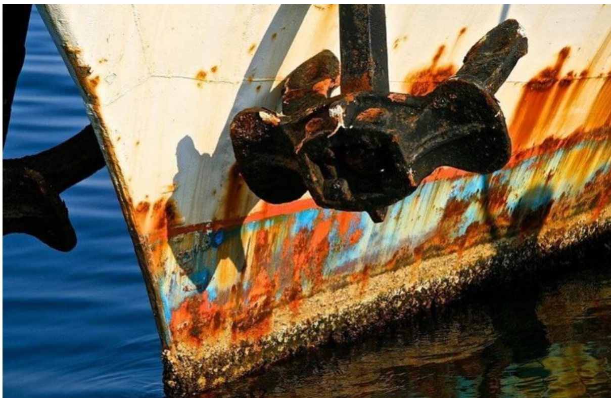
Slika 2. Korozija razvijena na trupu broda [6]
