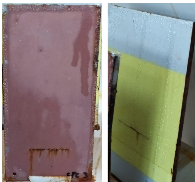
Slika 30. Izgled uzoraka nakon 14 dana ispitivanja u slanoj komori
