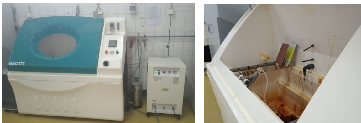
Slika 28. Komora Ascott S450 (lijevo); smještaj uzoraka u komoru (desno), Laboratorij za zaštitu materijala, FSB
