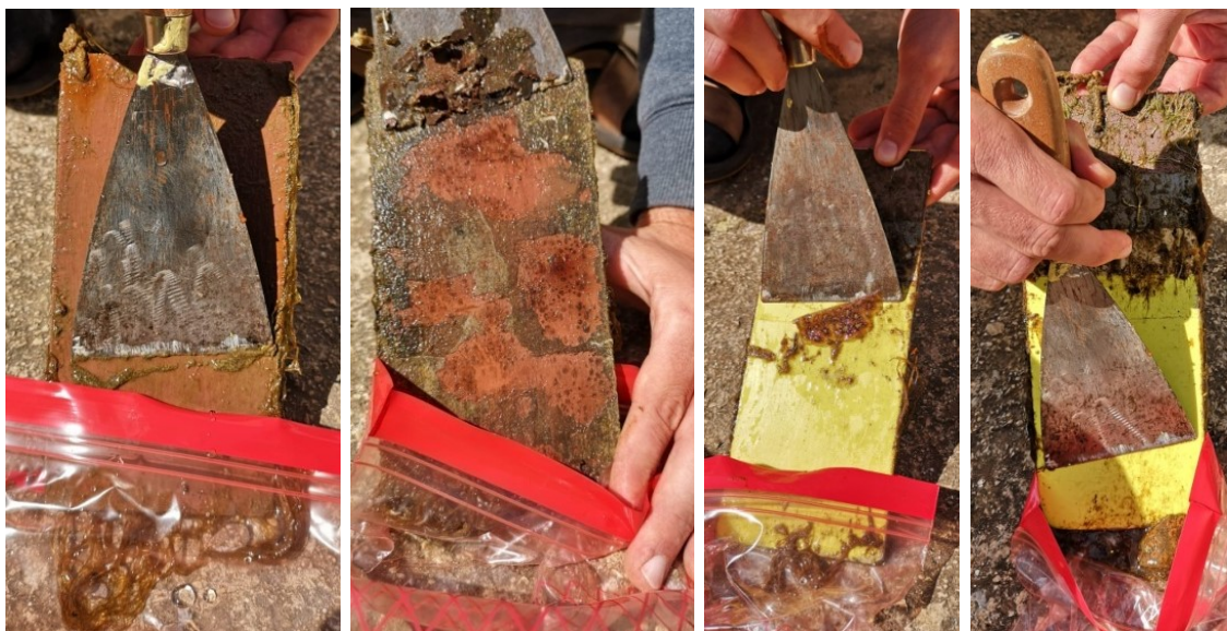
Slika 25. Skidanje obraštaja s uzoraka za terensko ispitivanje
