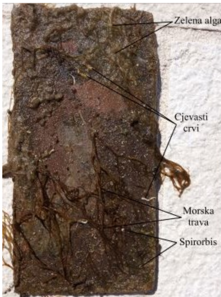
Slika 22. Detaljan prikaz obraštaja na SPC2 uzorku
