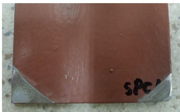
Slika 34. Izbrušeni rubovi uzorka
