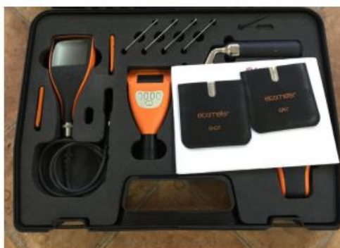
Slika 19. Mjerni set s uređajem Elcometer 456 za ispitivanje debljine prevlake
