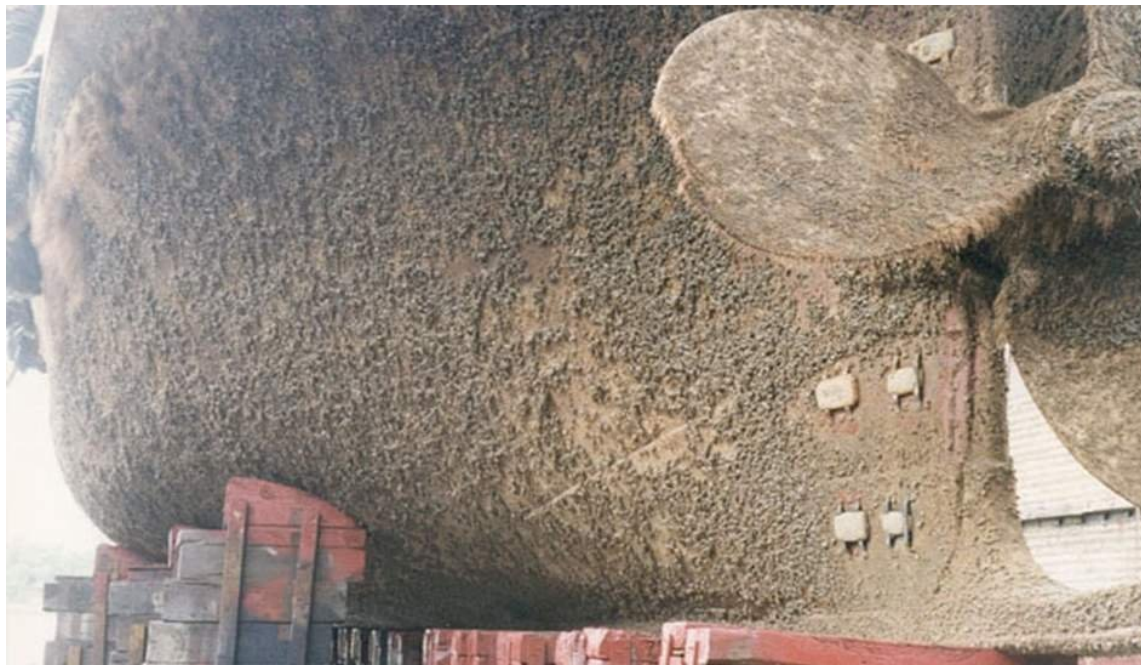
Slika 3. Oblasli propeler i podvodni dio trupa
