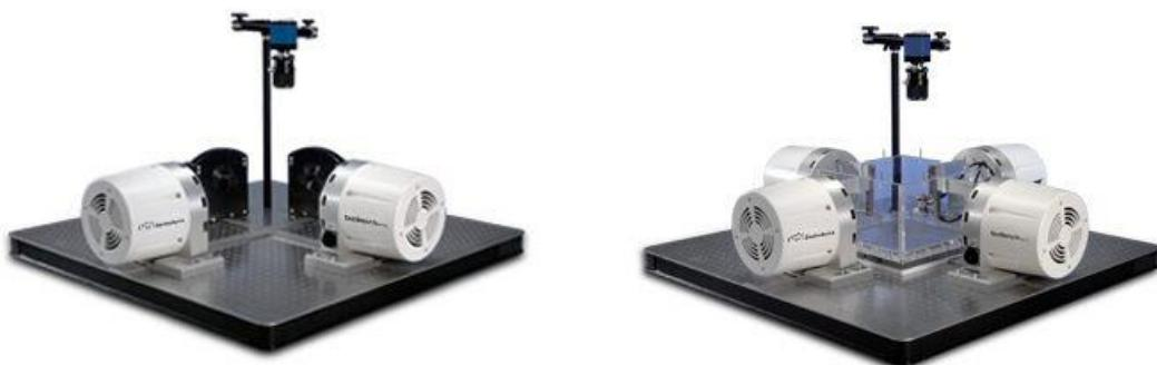
Slika 8. Konfiguracije *ElectroForce*-a s 2 i 4 aktuatora [6]
