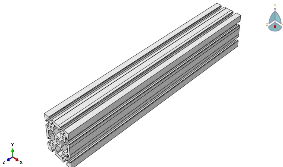
Slika 127. Aluminijski profil 90x90H, L=650 mm
