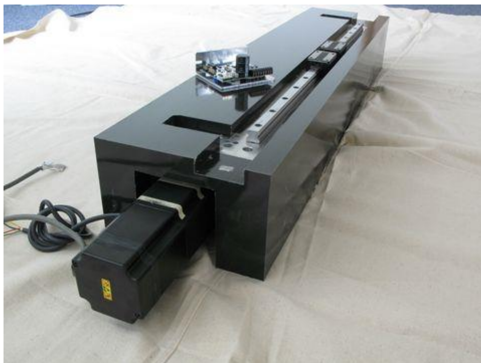
Slika 10. Primjer linearnog vođenja na postolju mineralnog lijeva [11]
