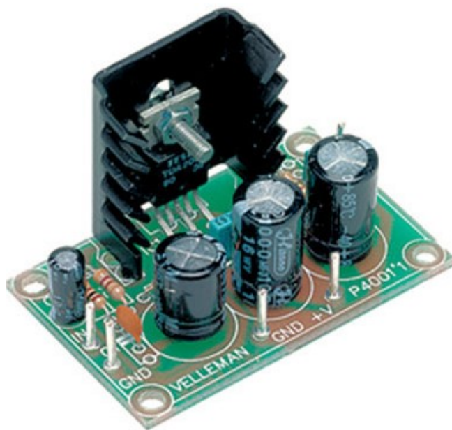
Slika 45. Sklop pojačala za zvučnik
