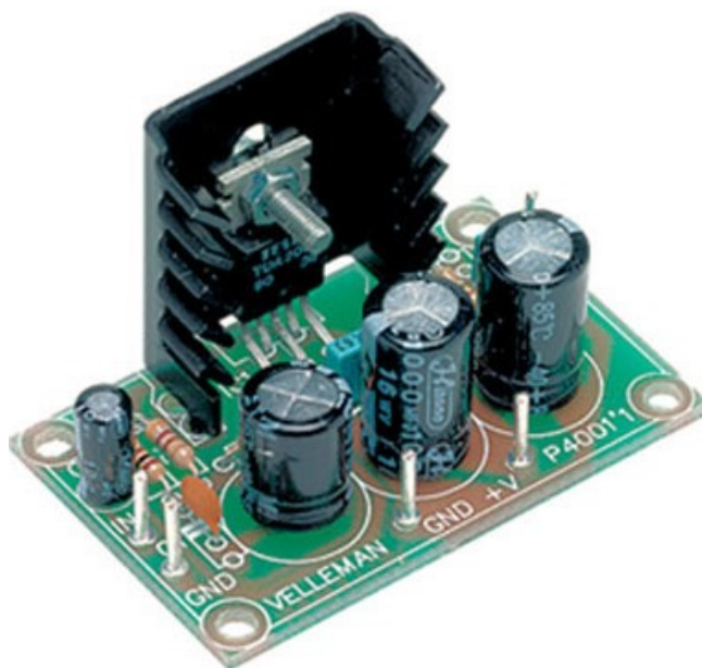
Slika 45. Sklop pojačala za zvučnik
