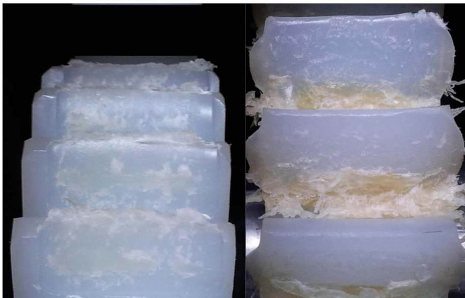
Slika 5.32 Toplinsko zaribavanje polimernih zupčanika gonjenog i pogonskog zupčanika, bok zuba nakon zadovoljavanja radnog uvjeta
