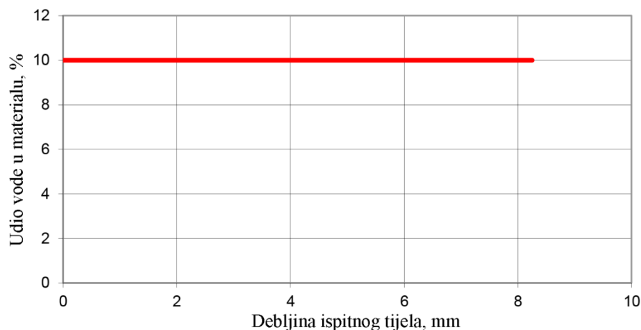
Slika 5.5 Koncentracija vode u poliamida PA 6 za debljinu stjenke 8,25 mm
