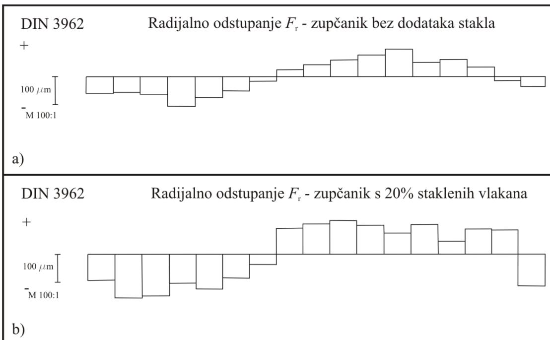
Slika 3.5 Radijalno odstupanje ozubljenja  $F_r$ , PA 66: a) bez dodataka stakla, b) sa 20% staklenih vlakna [47]
