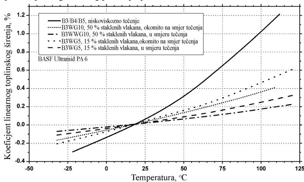
Slika 3.7 Koeficijenti linearног toplinskog širenja za poliamid PA6 kod različitih sadržaja vlakana i linija tečenja materijala u zavisnosti od temperature [61]
