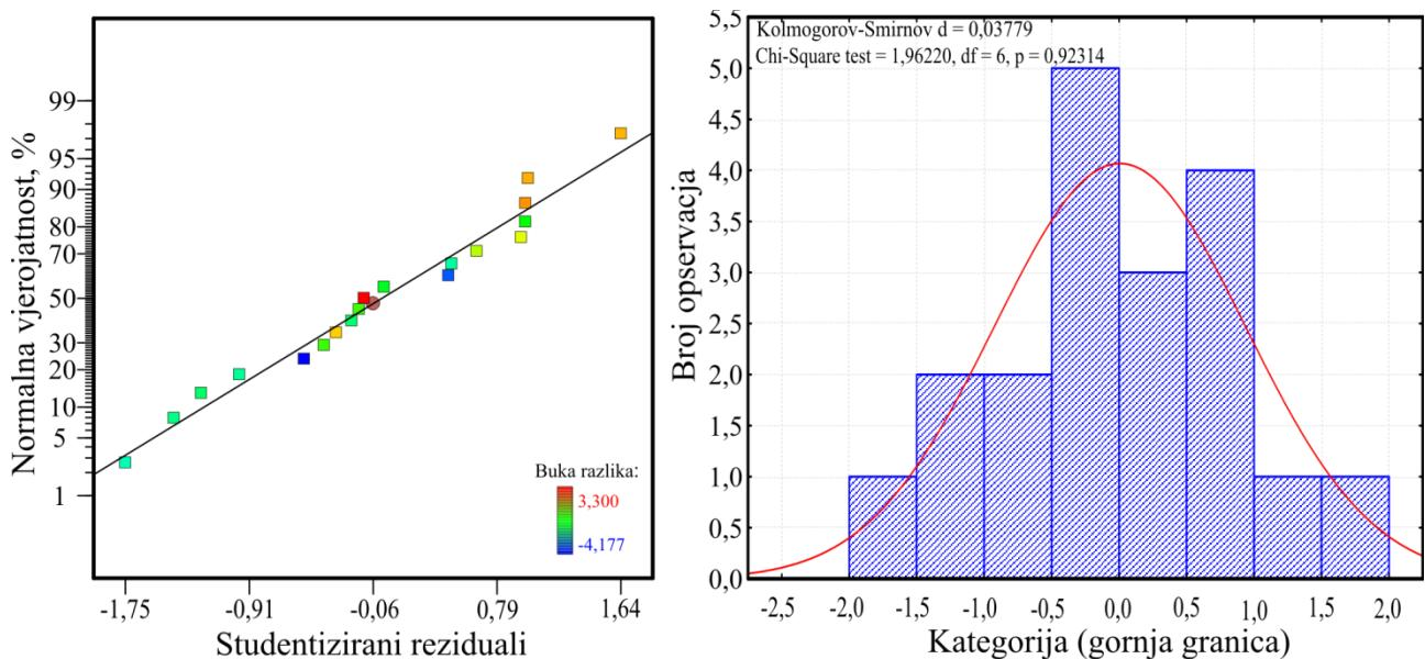
Slika 5.40 Vjerodostojnost ostataka i statistički testovi: a) Papir vrijednosti ostataka modela te Kolmogorov - Smirnov test (K-S test) i provjera varijance  $\chi^2$  prema normalnoj razdiobi predloženog modela
