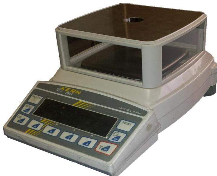
**Slika 5.7 Vaga za mjerenje mase PRJ 1200-3N proizvodača Kern & Sohn GmbH**
