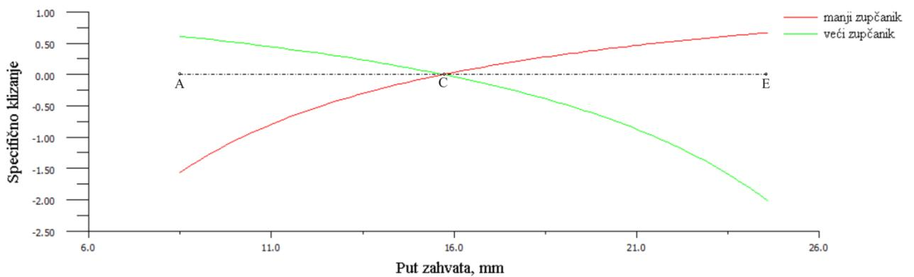
Slika 5.8 Varijacija optimalnih brzina klizanja, pomak profila  $J_1$
