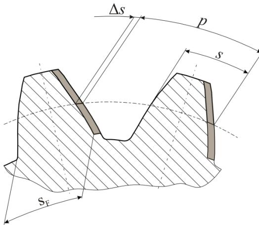
Slika 5.14 Pojednostavljena slika smanjenja debljine zuba, porastom istrošenosti
