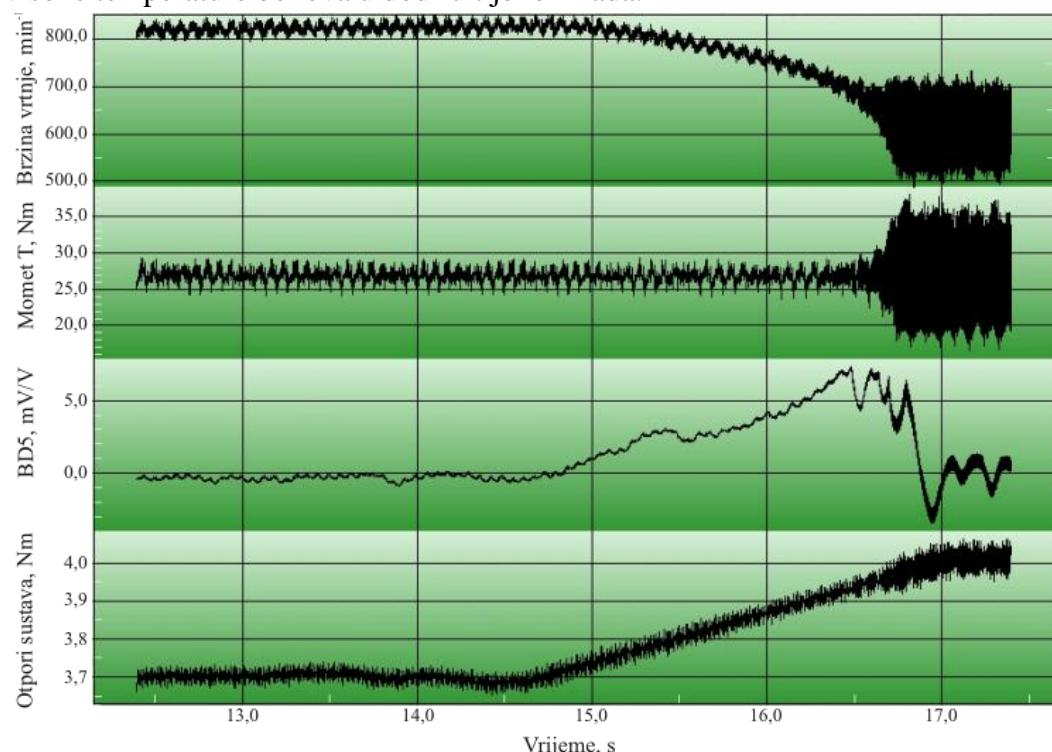
**Slika 5.13 Povećanje otpora u sustavu ispitnog postolja kao rezultat zaribavanja polimernih zupčanika**
