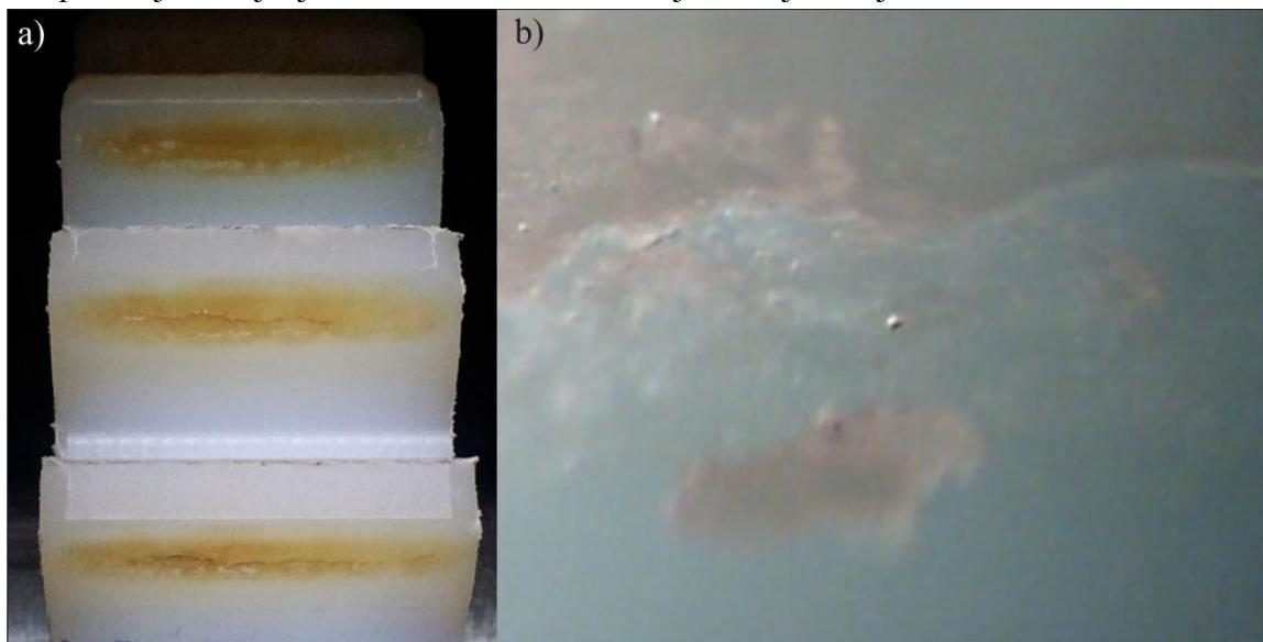
Slika 5.48 Izgled boka zuba zupčanika nakon  $3 \cdot 10^6$  ciklusa,  $T = 20 \text{ Nm}$ ,  $n = 1000 \text{ min}^{-1}$ : a) bok zuba, b) uvećanje boka zuba
