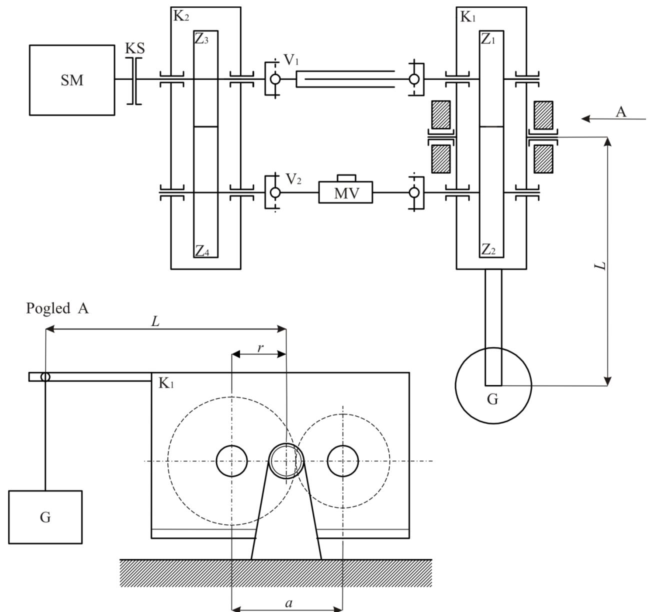
Slika 4.3 Shema postolja za ispitivanje polimernih zupčanika
