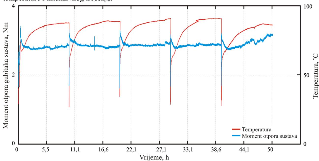
Slika 5.45 Raspored srednjih temperatura boka zuba i momenta otpora sustava tijekom radnog vijeka zupčanika uz opterećenje  $T = 20 \text{ Nm}$  pri pomaku profila  $J_2$  i brzini vrtnje  $n = 1000 \text{ min}^{-1}$
