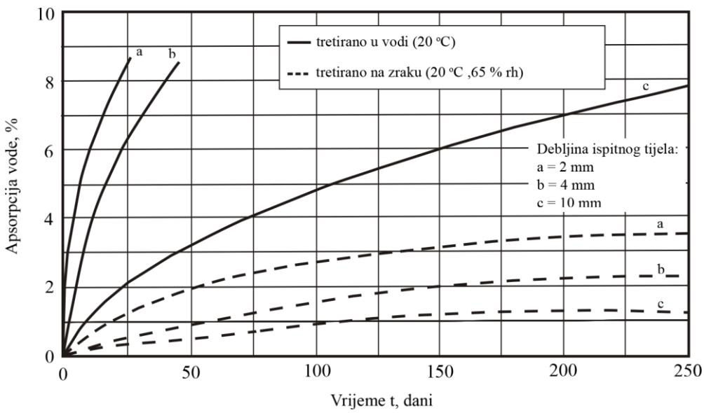
Slika 2.6 Apsorpcija vode PA 6 za različite debljine ispitnih tijela, dimenzijsi 120 x 20 mm [31]
