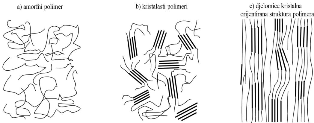
Slika 2.1 Strukture plastomera [60]
