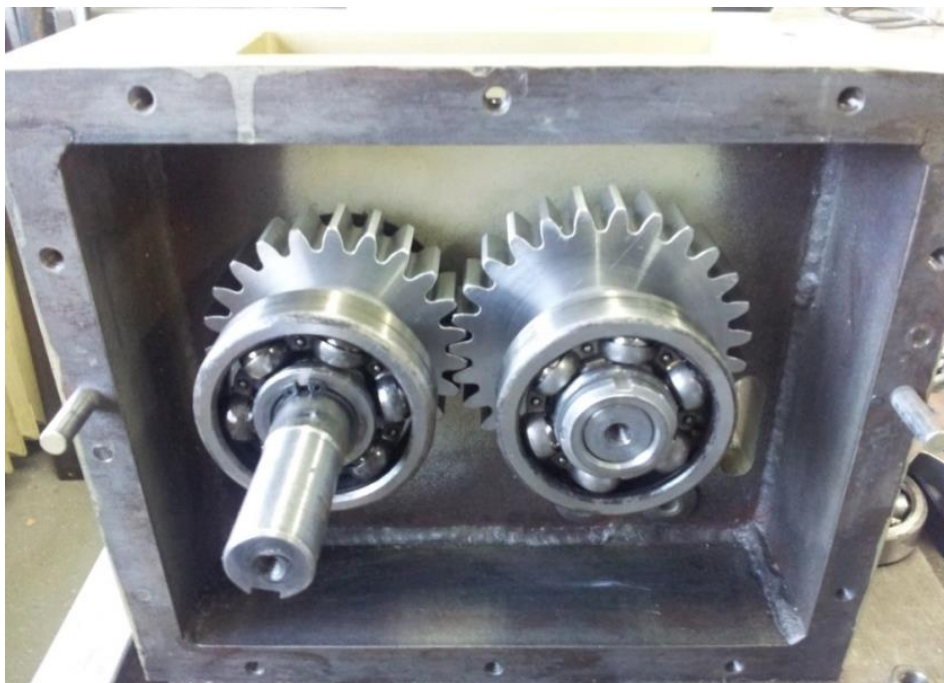
Slika 4.6 Pomoćni prijenosnik, montaža zupčanika
