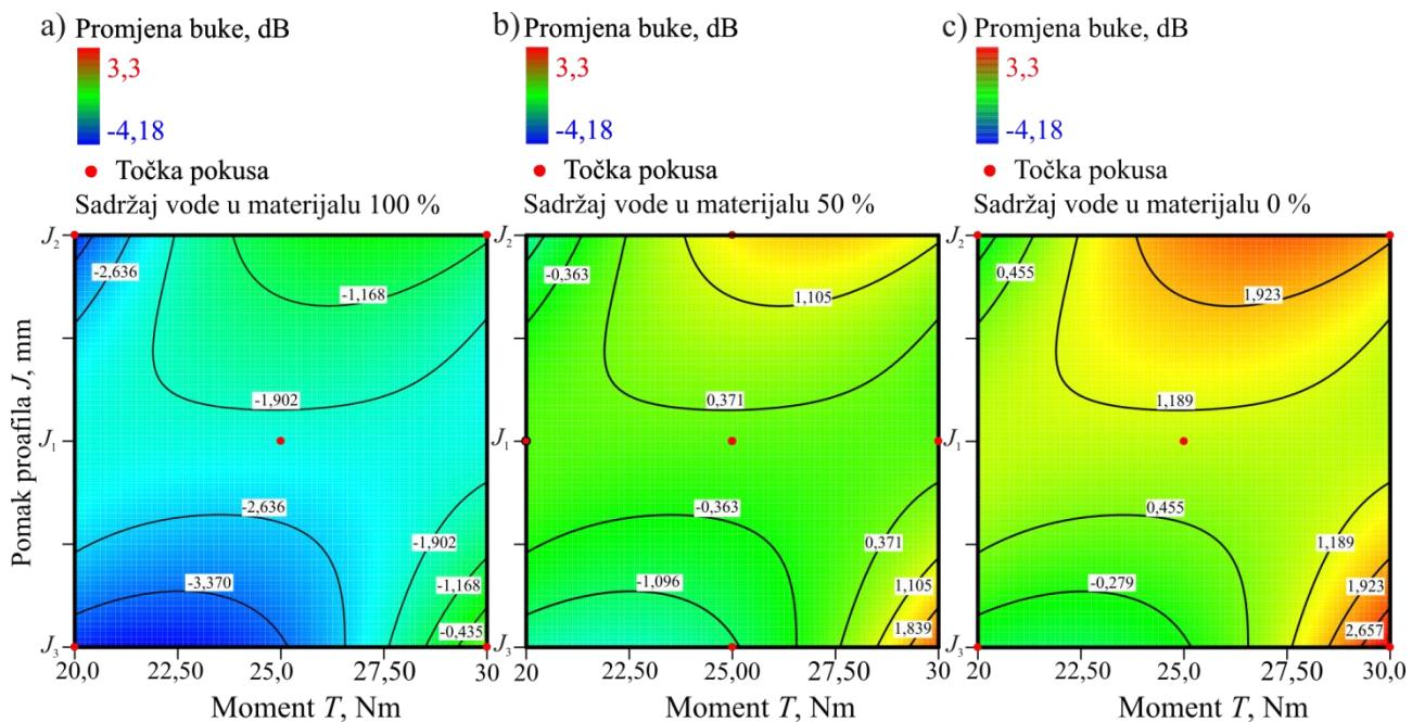
Slika 5.41 Grafički prikaz modela promjene buke u odnosu na početak i sredinu radnog vijeka: a) 100%-tina zasićenost materijala vodom; b) 50%-tina zasićenosti materijala vodom; c) 0%-tina zasićenosti materijala vodom
