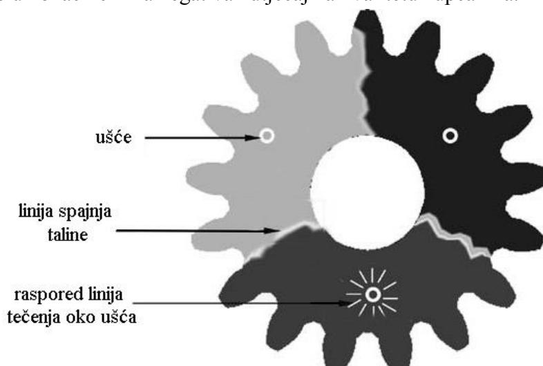
Slika 3.2 Linije spajanja kod injekcijskog prešanja [48]
