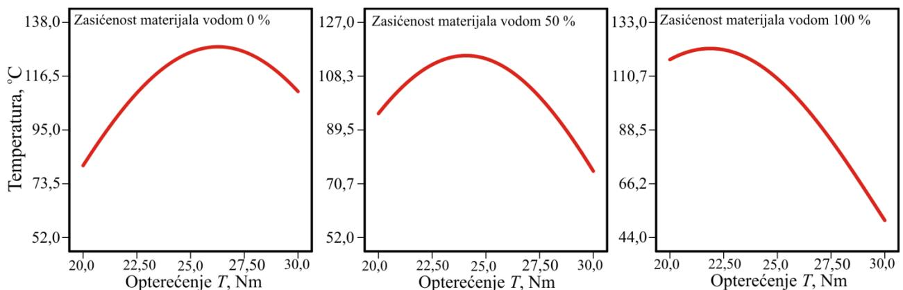
**Slika 5.38 Očekivane srednje temperature boka zuba za ispitni raspon opterećenja kod karakterističnih zasićenosti poliamida PA 6**
