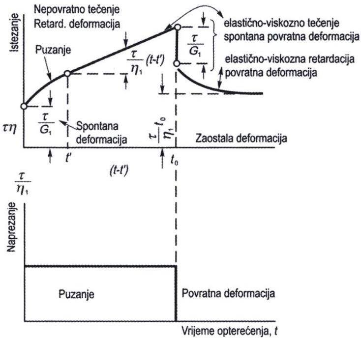
Slika 2.9 Viskoelastičnost polimernih materijala [6]
