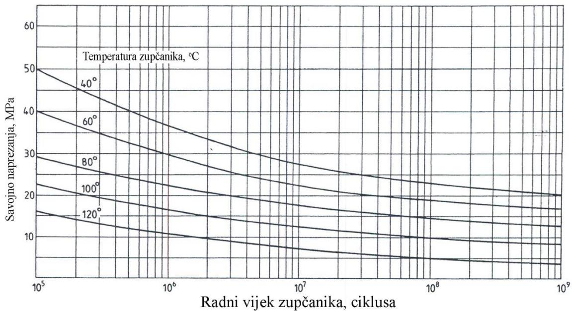
**Slika 5.12 Savojno naprezanje kod zupčanika od poliamida PA 66, za nepodmazivane zupčanike, modul  $m = 3 \text{ mm}$  u sprezi s metalnim zupčanicima**
