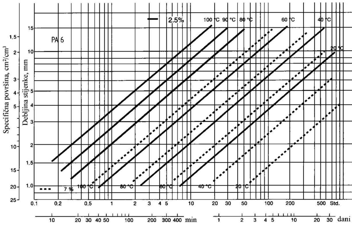
Slika 2.7 Vrijeme kondicioniranja poliamida PA 6 [56]
