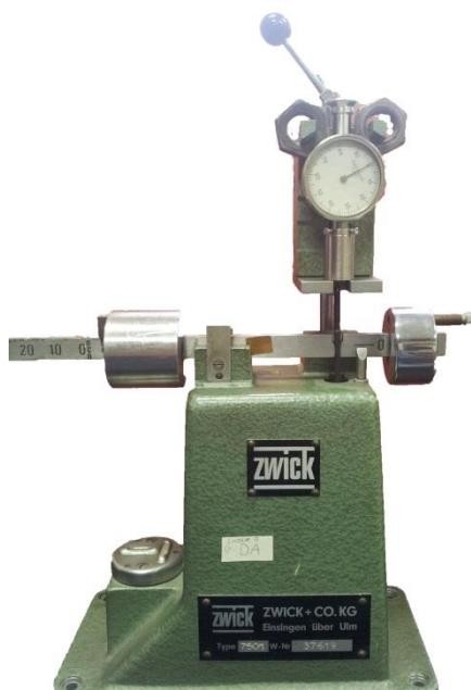
Slika 5.18 Kalibracijski uređaj za durometre prema Shore-u D
