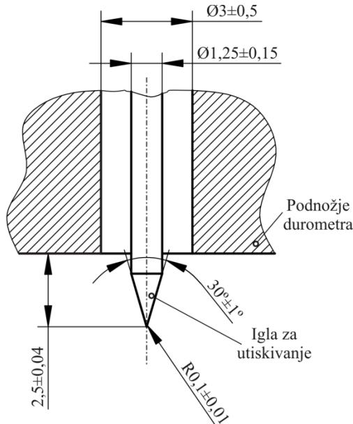
Slika 5.17 Durometar i izgled igle za mjerenje prema Shore-u D [92]
