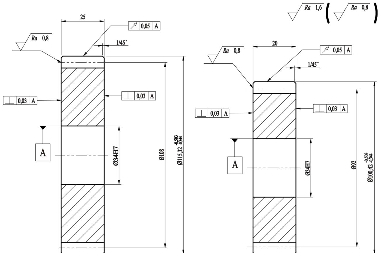
Slika 4.5 Crteži pomoćnih zupčanika izrađenih od čelika 34CrNiMo6
