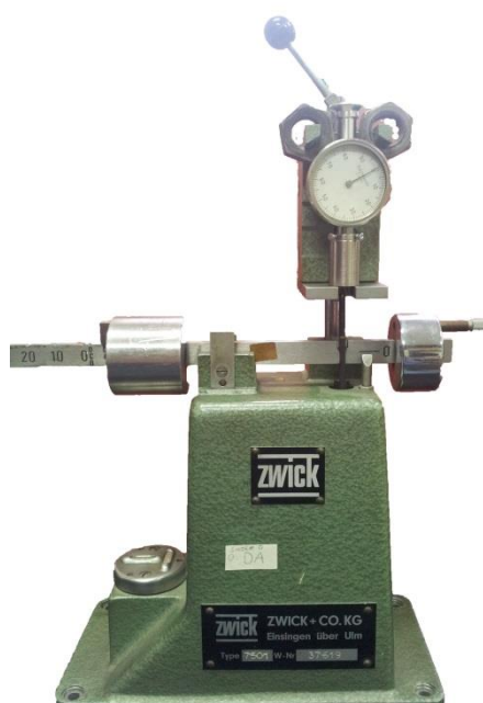
Slika 5.18 Kalibracijski uređaj za durometre prema Shore-u D
