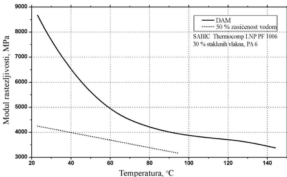
Slika 2.16 Modul rastezljivosti u zavisnosti od temperature [61]
