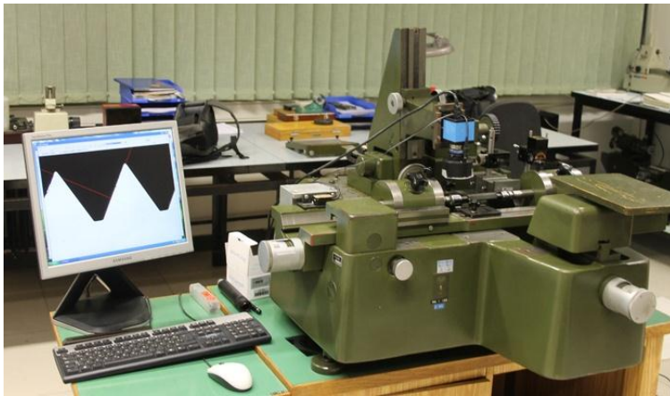
Slika 3-8 2D mjerni uređaj (mjerjenje pomaka laserskim interferencijskim sustavom)
