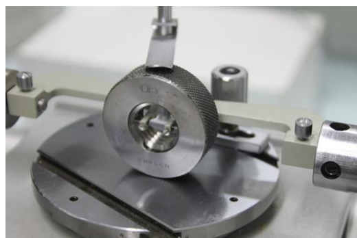
Slika 3-6 Mjerenje srednjeg promjera metodom s mjernim čeljustima
