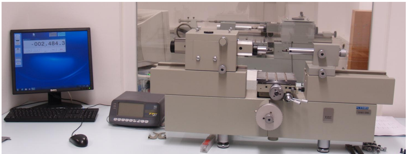
Slika 4-1 Univerzalni mjerni uređaj Joint DMS 680
