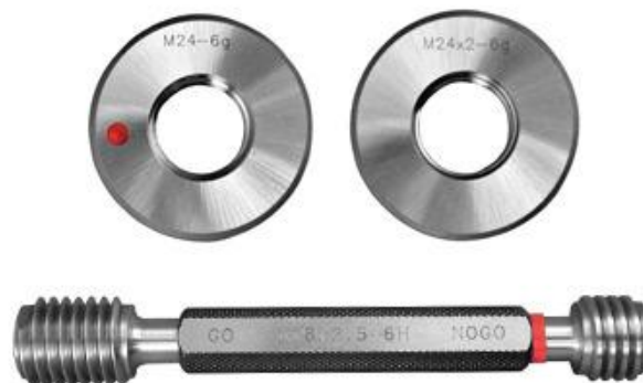
Slika 3-1 Granična mjerila za srednji promjer
