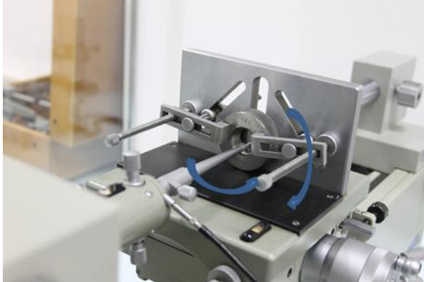
Slika 4-8 Mjerenje koraka unutarnjih navoja
