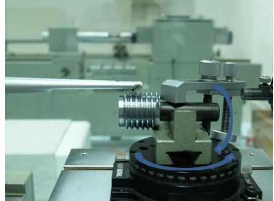
Slika 4-9 Mjerenje koraka vanjskih navoja
