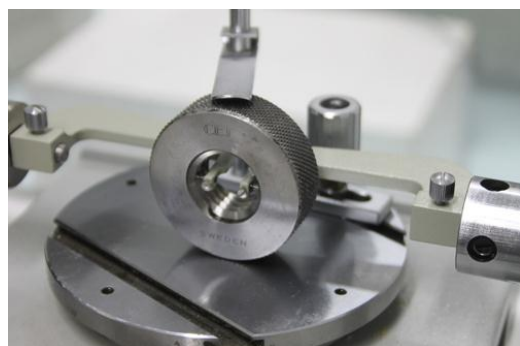
Slika 3-6 Mjerenje srednjeg promjera metodom s mjernim čeljustima
