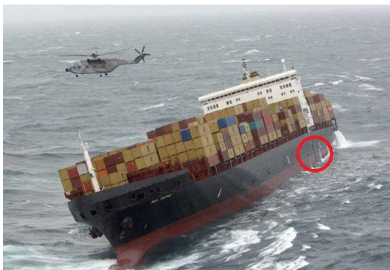
Slika 6.11 Fizičko oštećenje konstrukcije kontejnerskog broda MSC Napoli [48].
