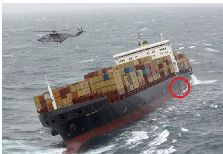
Slika 6.11 Fizičko oštećenje konstrukcije kontejnerskog broda MSC Napoli [48].
