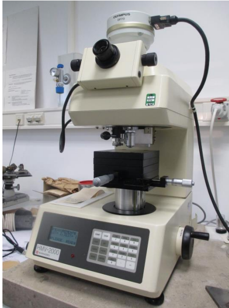
Slika 5.49. - Primarni etalon mikrotvrdoće u PTB-u
