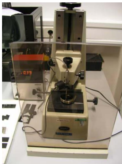
Slika 5.53. - Uređaj za mjerenje planparalelnosti površine [5]
