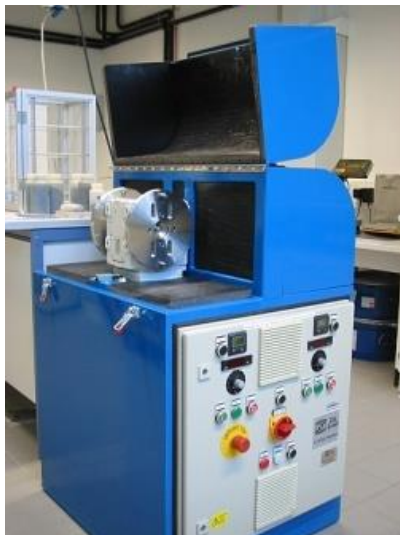
Slika 5.13. - Horizontalni kuglični mlin korišten pri sinter HIP- postupku
