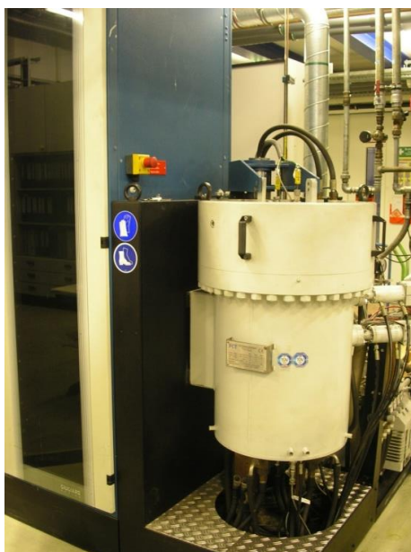
Slika 5.16. - Peć za sinter HIP oznake DS2 Ofen
