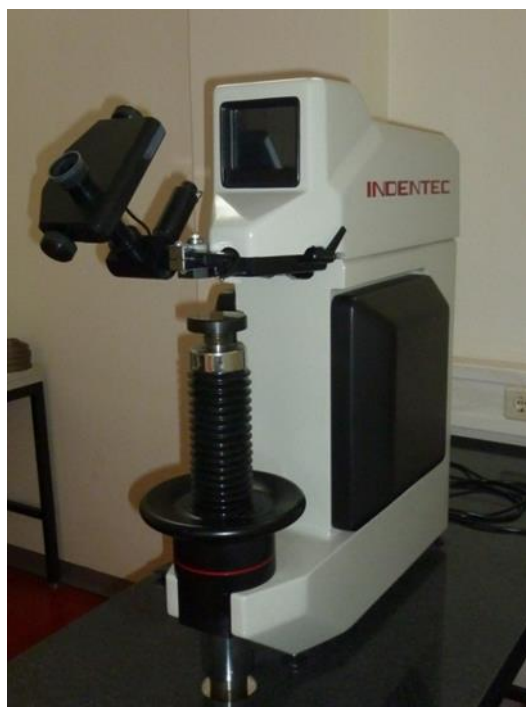
Slika 5.40. - Referentni etalon tvrdoće proizvođača Indentec
