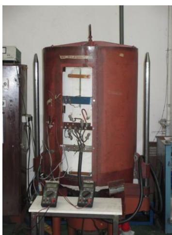
Slika 5.10. - Peć za predsinteriranje proizvođača Alfa tim d.o.o. korištena pri postupku sinteriranja u vodiku
