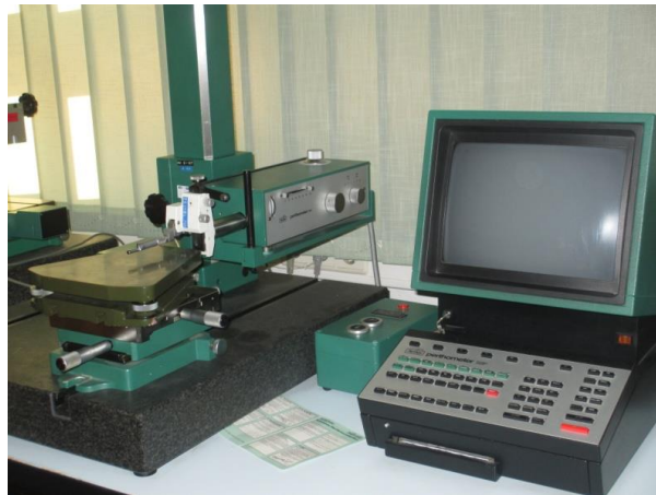
Slika 5.52. - Uređaj za ispitivanje hrapavosti površina [5]
