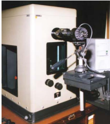
Slika 5.54. - Interferencijski mikroskop za provjeru ravnoće površine [5]
