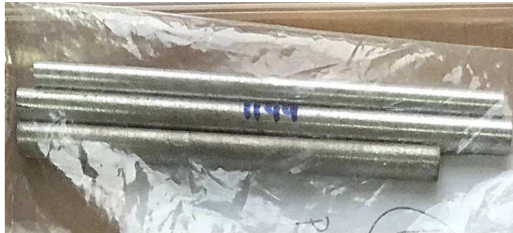
Slika 75. Strojno obrađeni uzorci nakon ekstrudiranja
