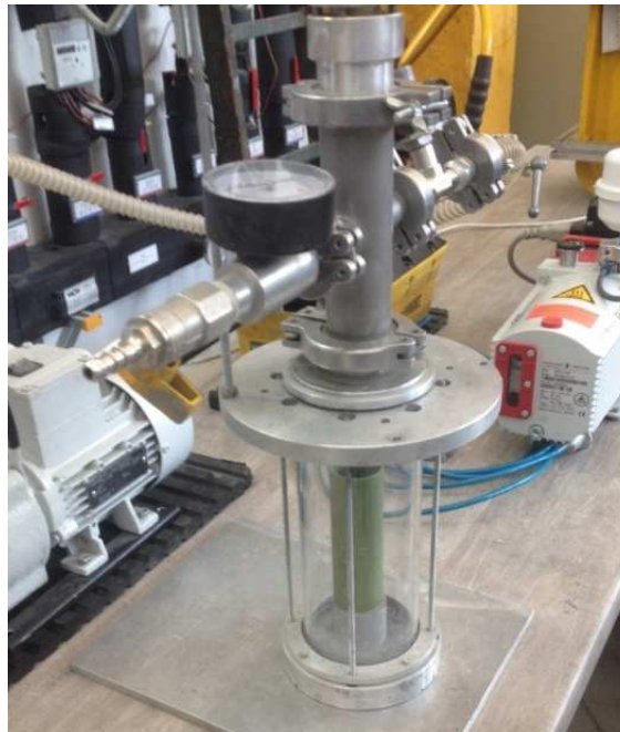
Slika 29. Evakuacija zraka iz poliuretanske kapsule u vakuumskoj komori
