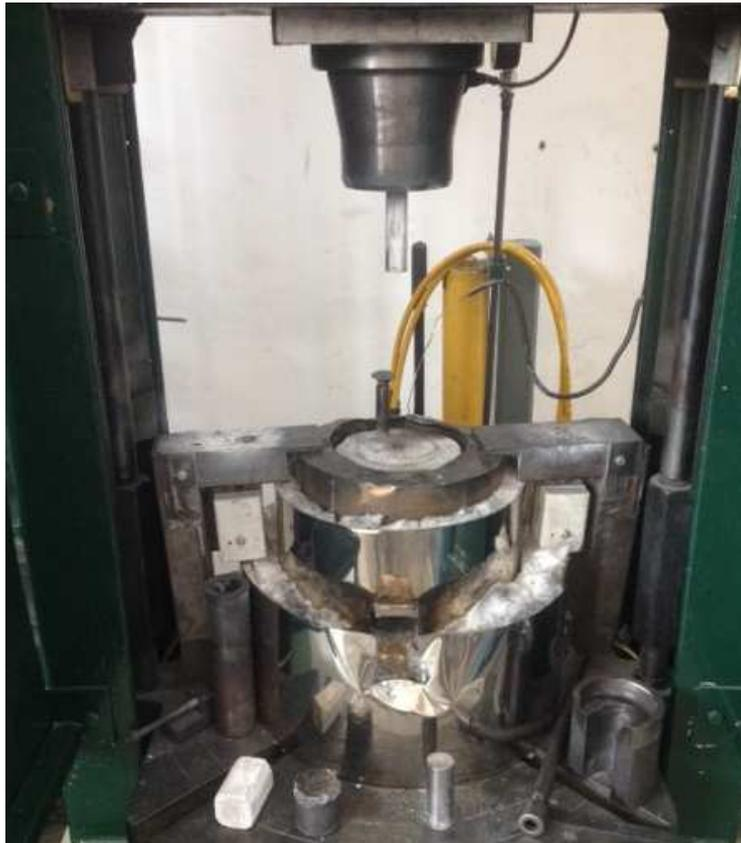
Slika 72. Preša i kalup za vruće ekstrudiranje uzoraka
