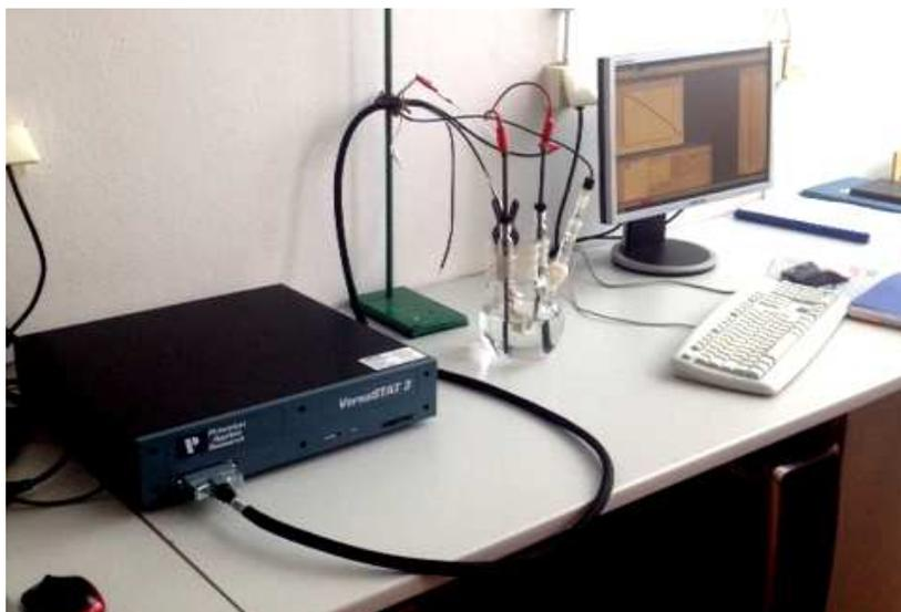
Slika 64. Uređaj za elektrokemijsko ispitivanje Potentiostat/Galvanostat, Model 273 EG&E
