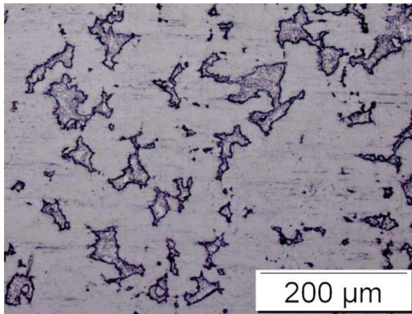
Slika 38. Mikrostruktura uzorka Ti10Mg – početno stanje
