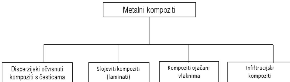
Slika 2. Klasifikacija kompozita s metalnom matricom [3]
