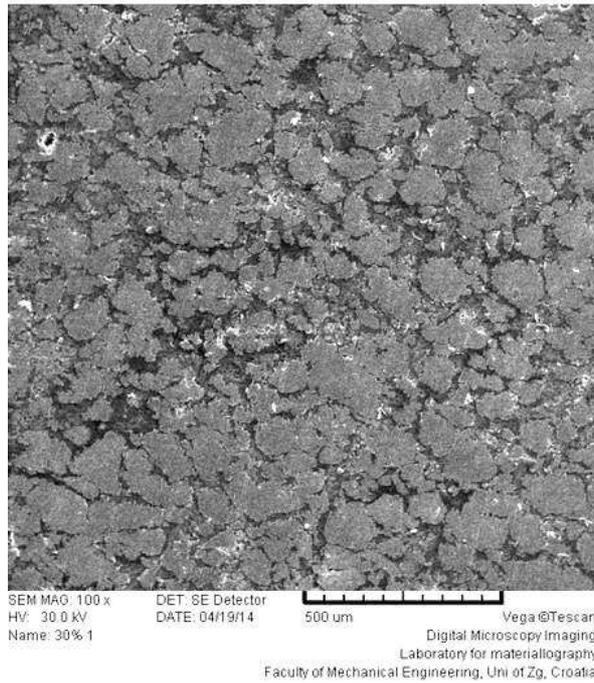
Slika 48. Površina uzorka Ti30Mg nakon korozijskog ispitivanja
