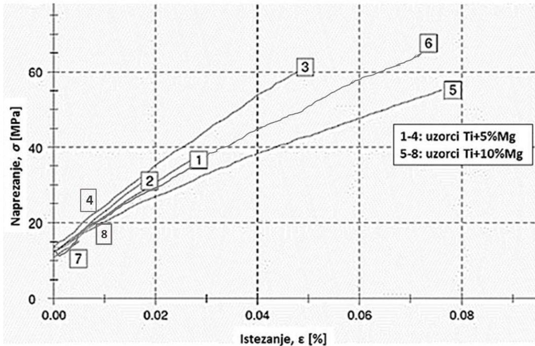
Slika 70. Dijagram naprezanje/istezanje za uzorke Ti5MgII i Ti10MgII
