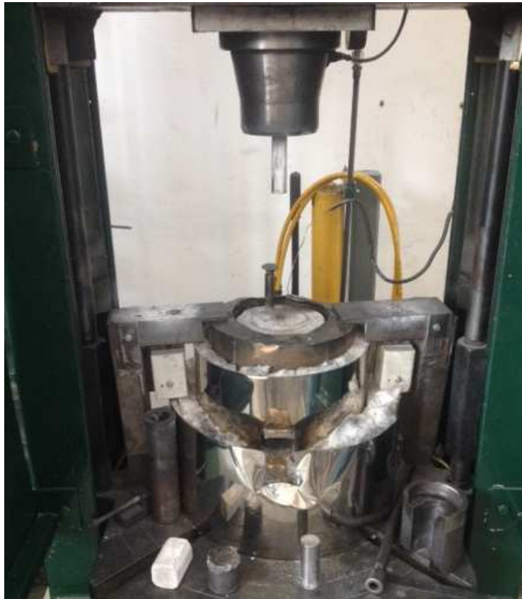
Slika 72. Preša i kalup za vruće ekstrudiranje uzoraka
