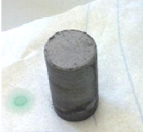
Slika 31. Izgled sirovca dobivenog hladnim izostatskim prešanjem
