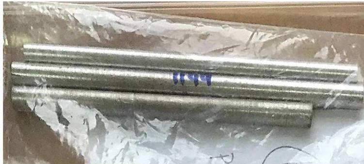
Slika 75. Strojno obrađeni uzorci nakon ekstrudiranja
