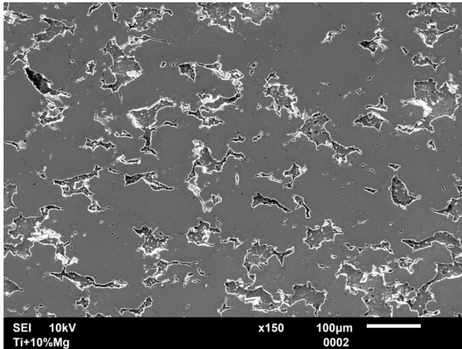
Slika 61. Mikrostruktura uzorka Ti10MgII u poliranom stanju
