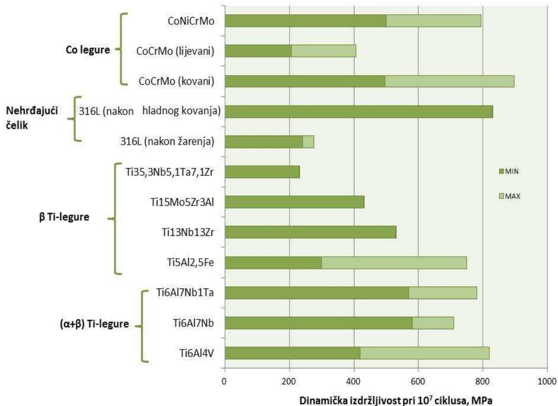
Slika 17. Usporedba dinamičke izdržljivošću raznih metalnih biomaterijala [143, 144]
