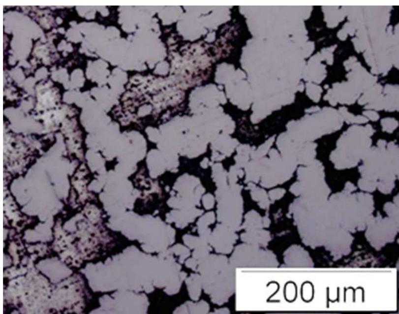
Slika 40. Mikrostruktura uzorka Ti30Mg – početno stanje
