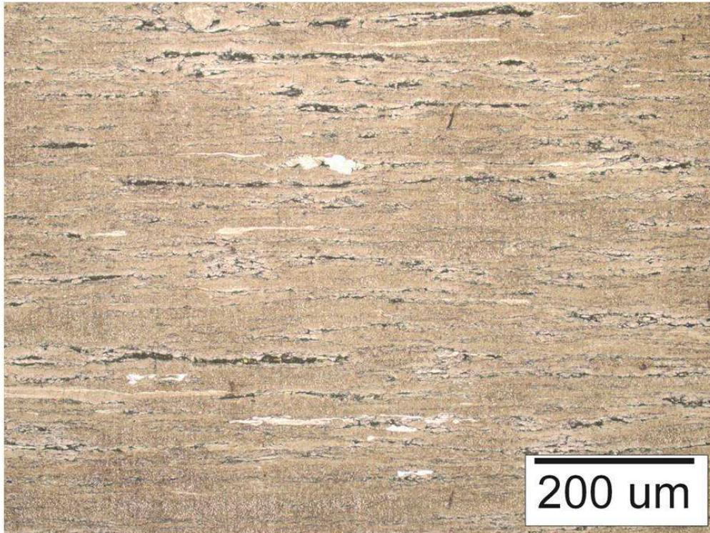
Slika 78. Mikrostruktura uzorka Ti5MgIII u uzdužnom presjeku
