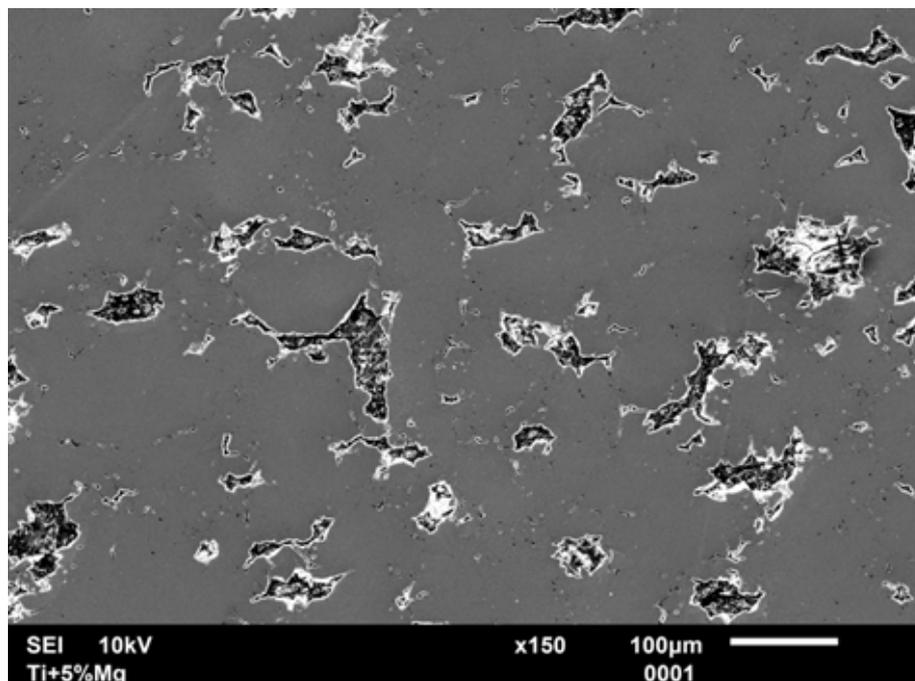
Slika 58. Mikrostruktura uzorka Ti5MgII u poliranom stanju
