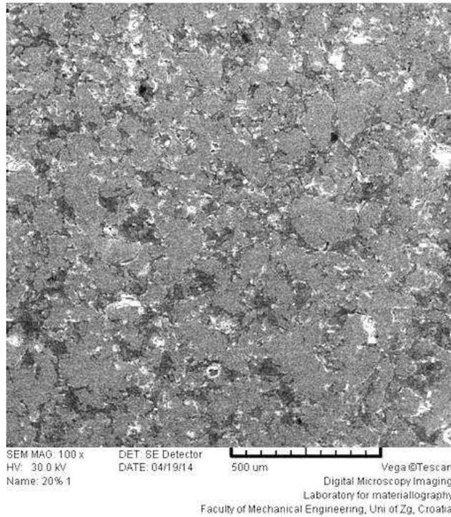
Slika 46. Površina uzorka Ti20Mg nakon korozijskog ispitivanja
