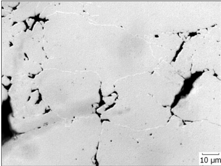
Slika 63. Mikrostruktura uzorka Ti10MgII, nagrizanje u octenoj kiselini
