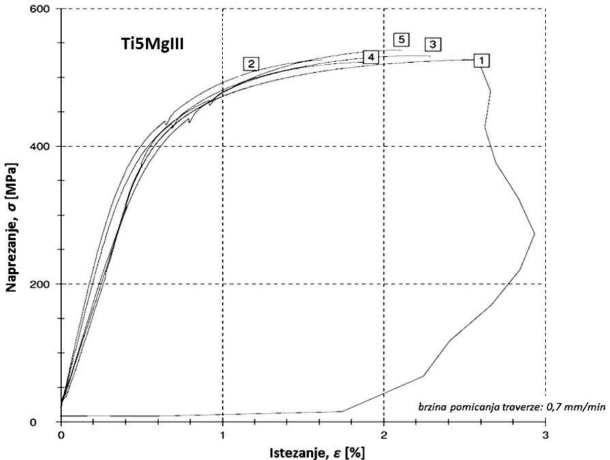
Slika 82. Dijagram naprezanje – istezanje za uzroke Ti5MgIII
