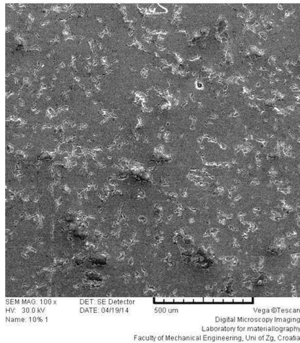
Slika 44. Površina uzorka Ti10Mg nakon korozijskog ispitivanja
