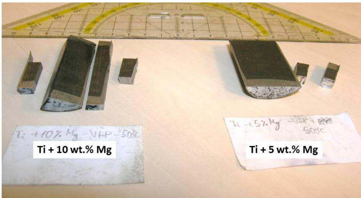
Slika 57. Uzorci Ti10MgII i Ti5MgII nakon konsolidacije
