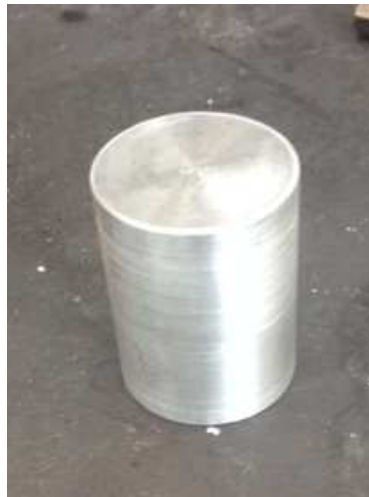
Slika 71. Izgled strojno obrađenog sirovaca prije vrućeg ekstrudiranja
