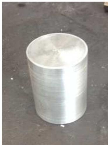
Slika 71. Izgled strojno obrađenog sirovaca prije vrućeg ekstrudiranja
