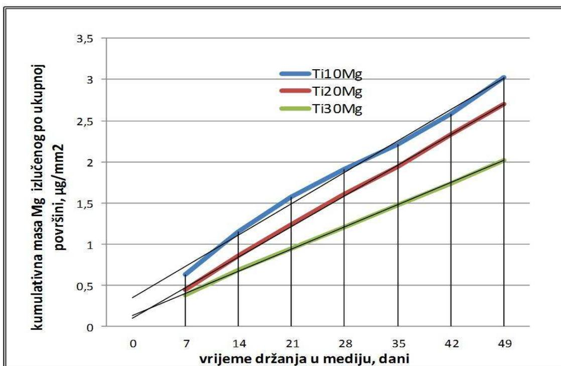
Slika 37. Prikaz kumulativne promjene mase izlučenog magnezija po ukupnoj površini uzorka tijekom izlaganja destiliranoj vodi u razdoblju od 49 dana [225]
