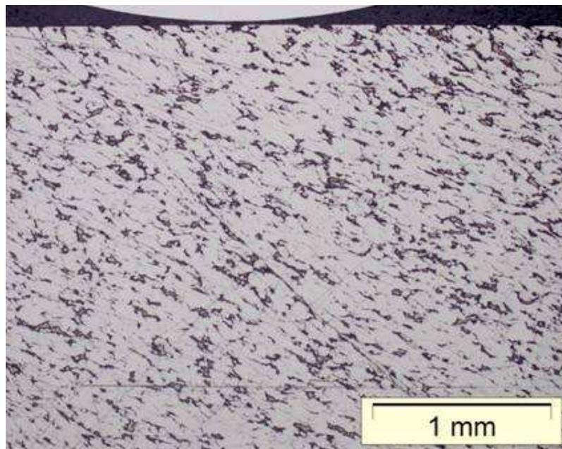
Slika 51. Mikrostruktura poprečnog presjeka uzorka Ti10Mg nakon korozivskog ispitivanja [225]
