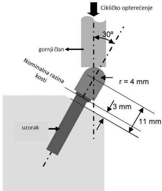
Slika 86. Shematski prikaz dinamičkog ispitivanja uzoraka [242]
