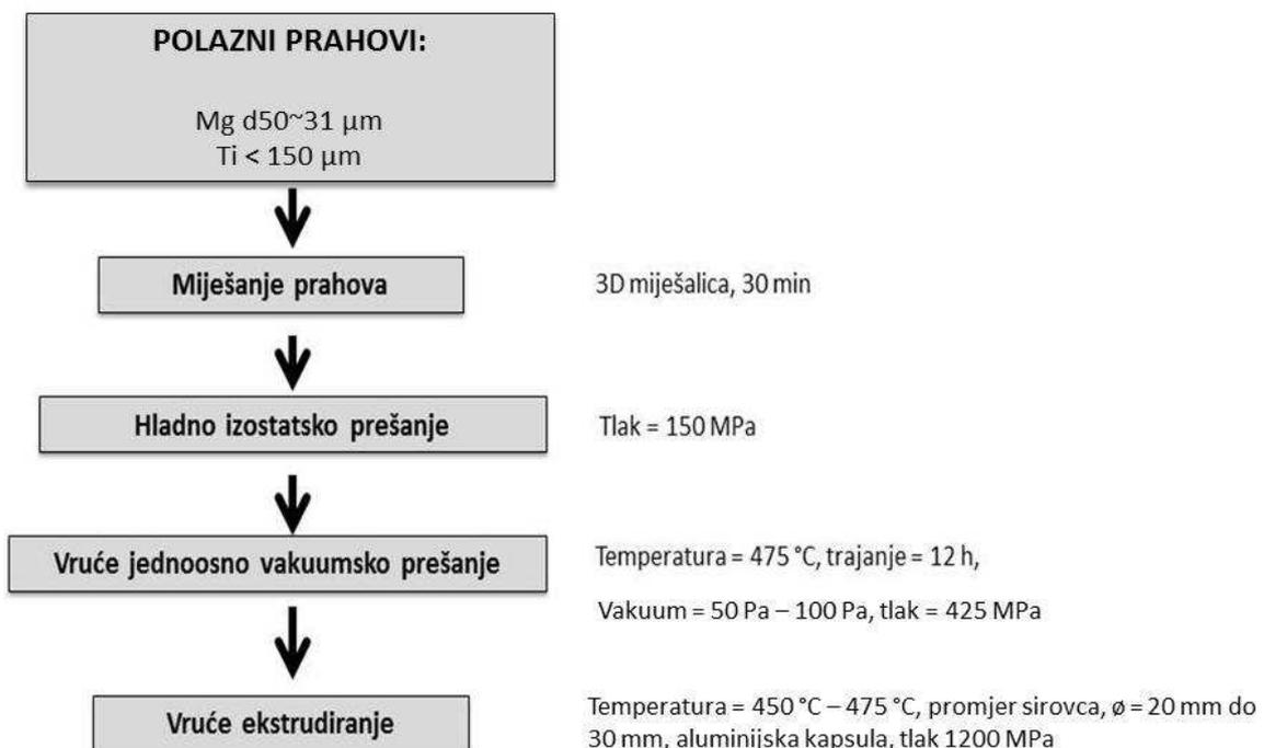
Slika 76. Pregled faza i parametara izrade uzoraka u trećoj iteraciji ispitivanja
