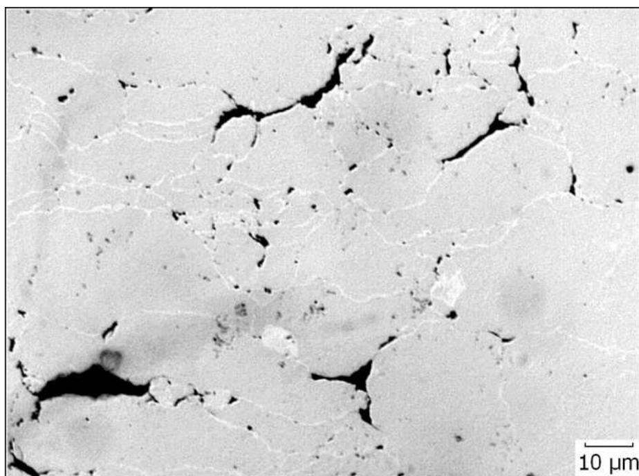
Slika 60. Mikrostruktura uzorka Ti5MgII, nagrižen u octenoj kiselini
