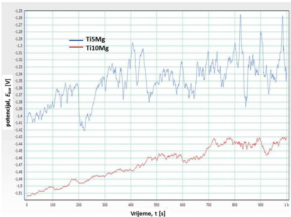
Slika 66. Elektrokorozijski potencijal uzoraka u ovisnosti o vremenu
