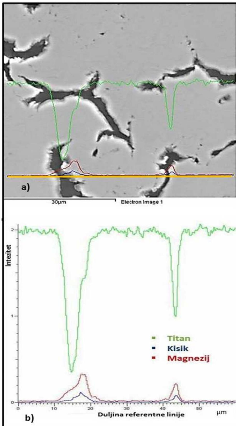
Slika 80. Inteziteti pojedinih elemenata dobivenih linijskom analizom
