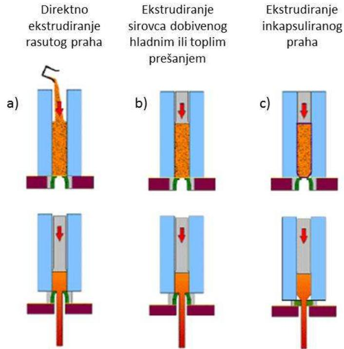
Slika 9. Različite procedure konsolidacije metalnih prahova ekstrudiranjem [82]
