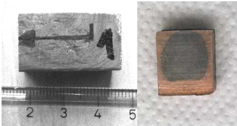
Slika 33. Izgled uzorka Ti30Mg, Ti20Mg, Ti10Mg nakon konsolidacije
