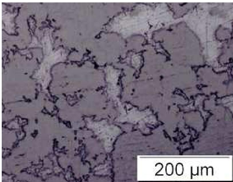
Slika 39. Mikrostruktura uzorka Ti20Mg – početno stanje
