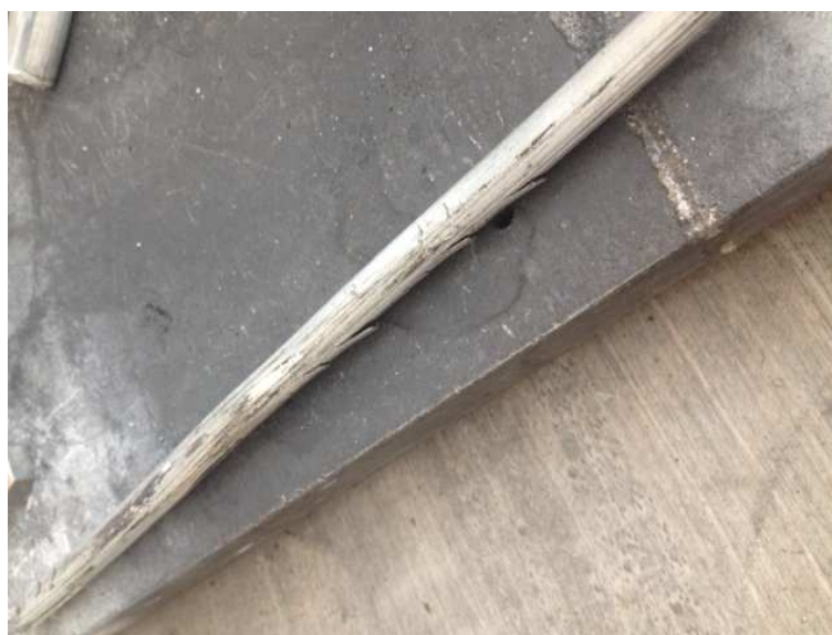
Slika 74. Profil dobiven tijekom vruće ekstruzije kompozitnog uzorka s 5 % Mg
