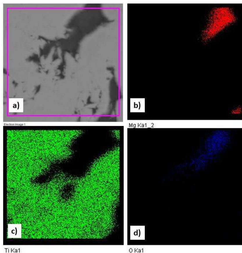
Slika 81. Mapiranje odabranog područja Ti<sub>5</sub>Mg<sub>III</sub> uzorka
