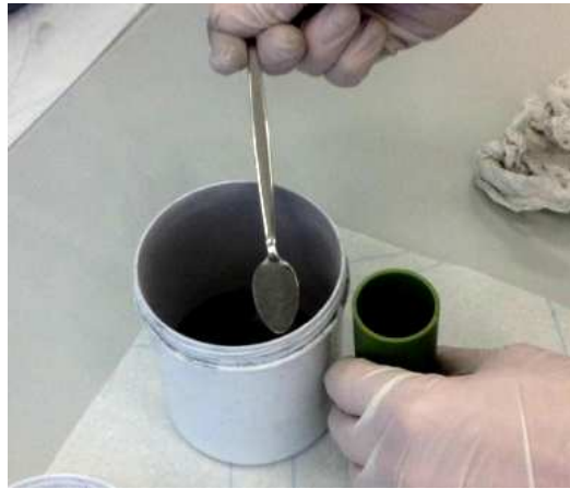
Slika 28. Prijenos smjese titanovog i magnezijevog praha u poliuretansku kapsulu
