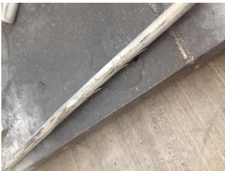
Slika 74. Profil dobiven tijekom vruće ekstruzije kompozitnog uzorka s 5 % Mg
