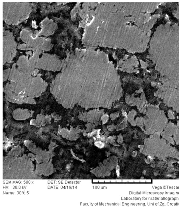
Slika 49. Detalj površina uzorka Ti30Mg nakon korozijskog ispitivanja [225]
