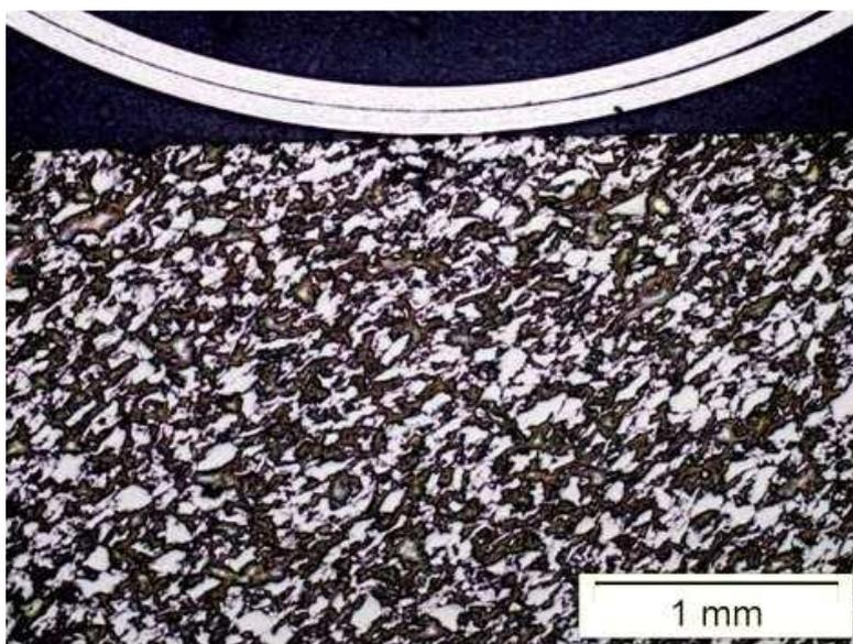
Slika 55. Mikrostruktura poprečnog presjeka uzorka Ti30Mg nakon korozijskog ispitivanja [225]
