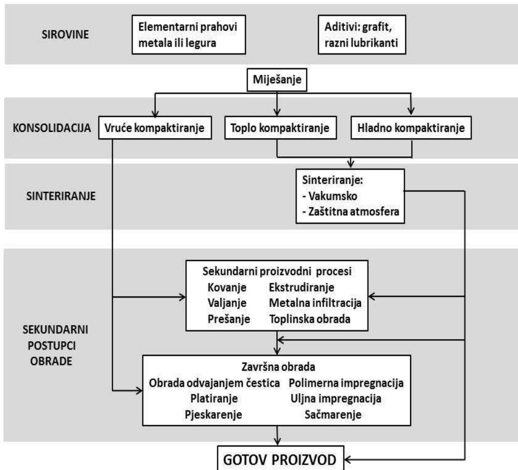
Slika 5. Shematski prikaz faza PM proizvodnje [52]
