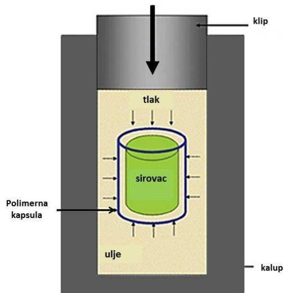
Slika 8. Shematski prikaz procesa vrućeg izostatskog prešanja [78]
