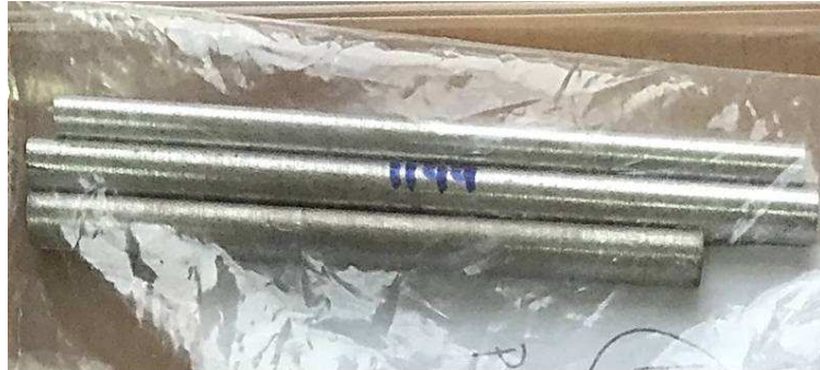
Slika 75. Strojno obrađeni uzorci nakon ekstrudiranja
