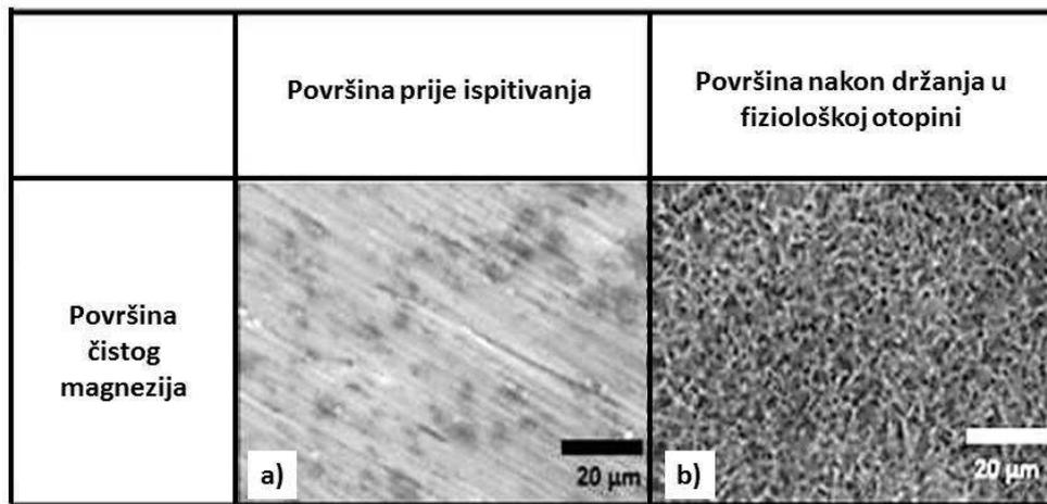
Slika 22. Površina poliranog Mg uzroka, SEM [206]:
