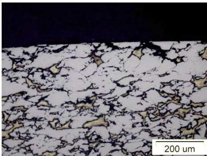
Slika 54. Mikrostruktura poprečnog presjeka uzorka Ti20Mg nakon korozijskog ispitivanja, veće povećanje [225]
