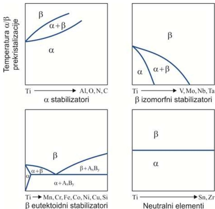
Slika 16. Dijagrami stanja za binarne Ti-legure s obzirom na vrste stabilizatora
