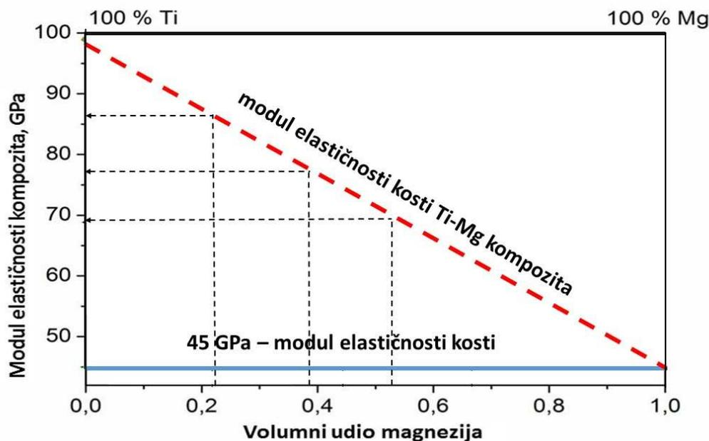
Slika 24. Dijagram ovisnosti modula elastičnosti Ti-Mg kompozita o volumnom udjelu magnezija
