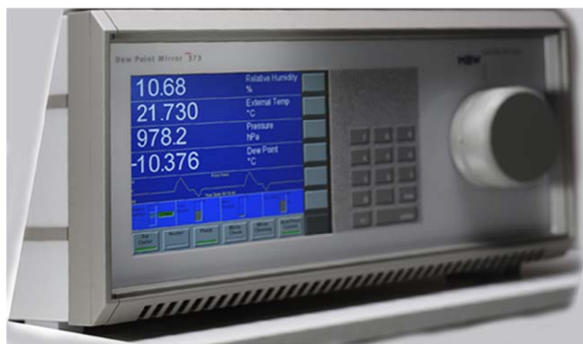
Slika 21. Higrometar točke rose MBW-373L, iz [51].
