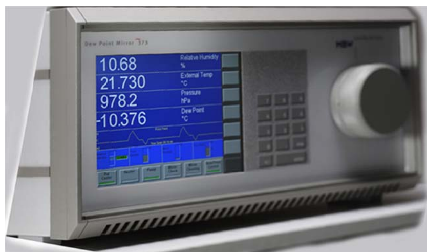
Slika 21. Higrometar točke rose MBW-373L, iz [51].
