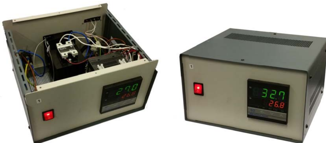
Slika 13. Regulator temperature grijača izlazne cijevi LRS-a.
