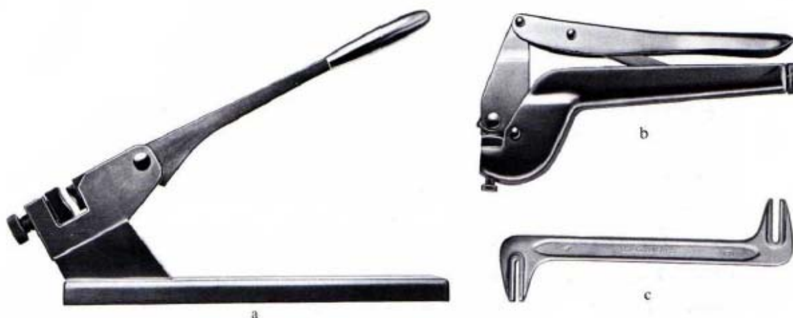
Slika 2. Uređaji za savijanje pločica za osteosintezu [1] a – preša za savijanje, b – kliješta za savijanje, c – savijač
