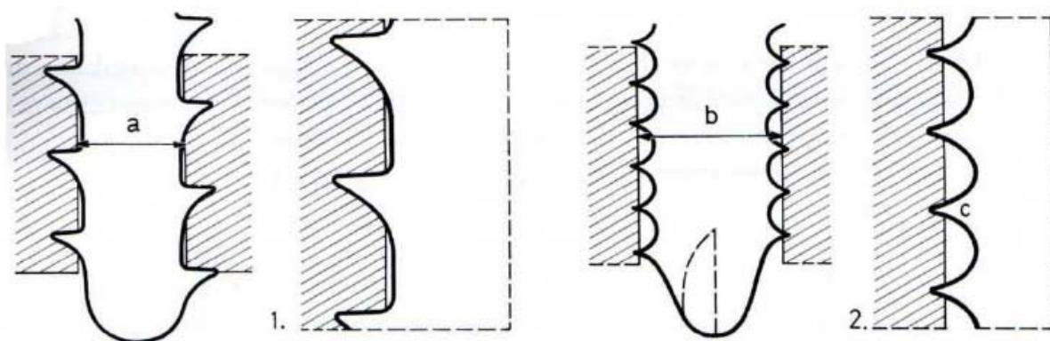
Slika 6. Primjer nareza kortikalnog vijka (1.), te običnog koštanog vijka (2.) [1]
