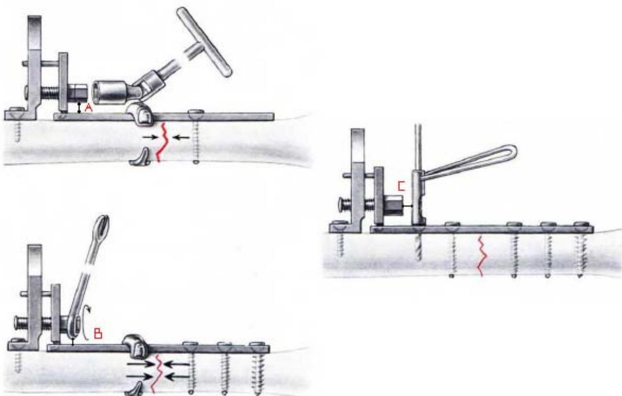
Slika 20. Dimenzioniranje priteznika s obzirom na pločicu, te uvjete u eksploraciji [1]
