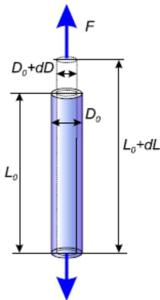
Slika 39. Deformacija ravnog vodiča pod djelovanjem opterećenja [9]
