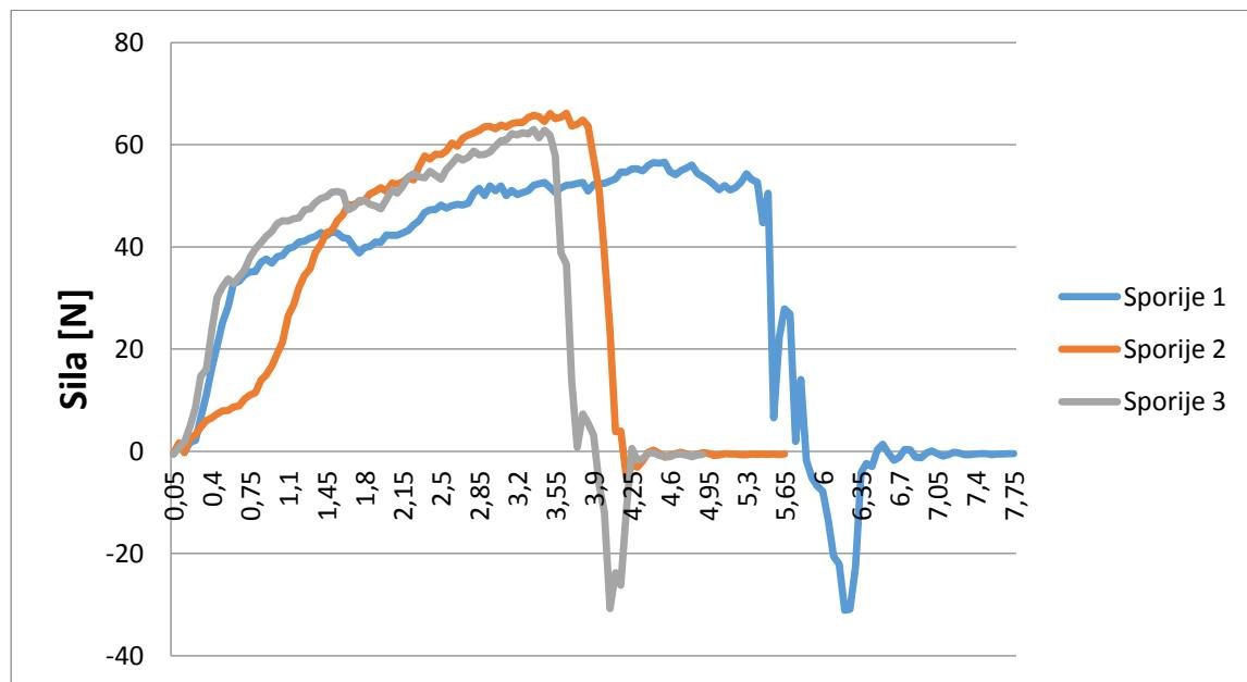
Slika 3.11. Sile uslijed bušenja kosti kirurškom bušilicom.
