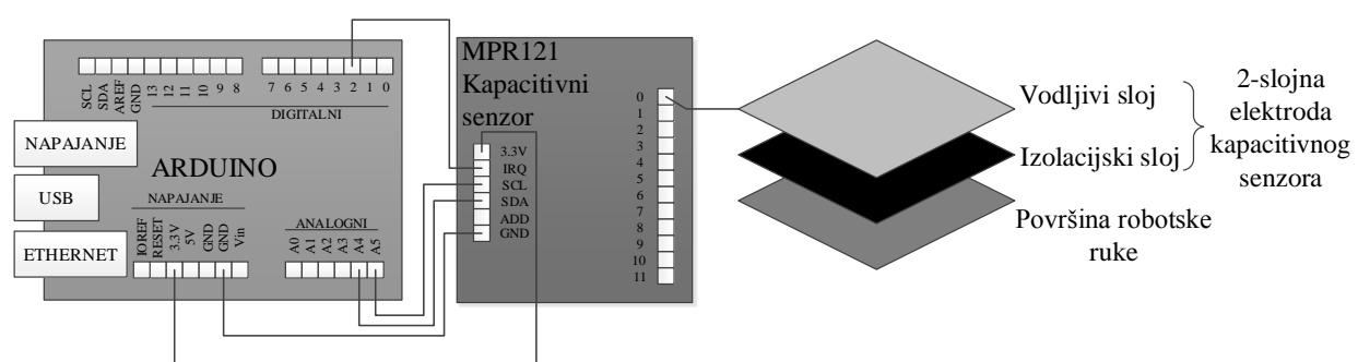
Slika 3.2. Kapacitivni senzor.
