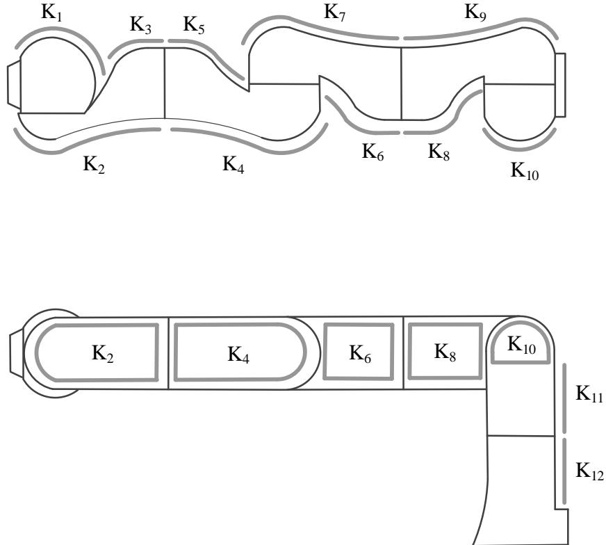
Slika 3.3. Robotska ruka s elektrodama kapacitivnog senzora.
