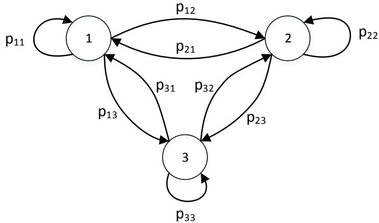
Slika 4.5. Markovljev lanac s tri stanja.
