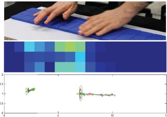
Slika 2.5. Taktilni senzor [45].
