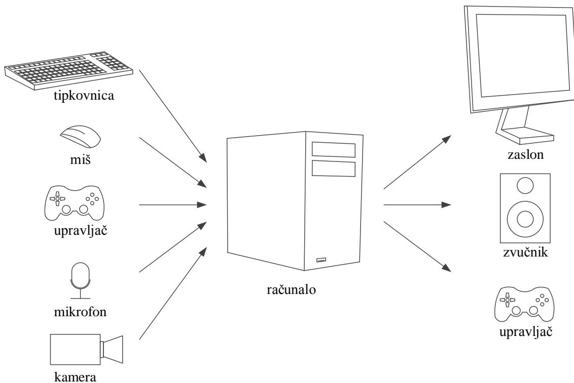
Slika 2.2. Ulazno-izlazne jedinice.
