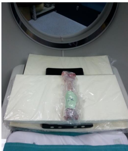
Slika 58. CT-skeniranje ovčjeg femura zajedno s kalibracijskim fantomom za gustoću kosti
