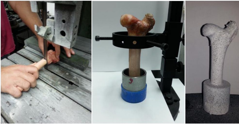
Slika 35. Priprema ovčjeg femura za mehaničko ispitivanje
