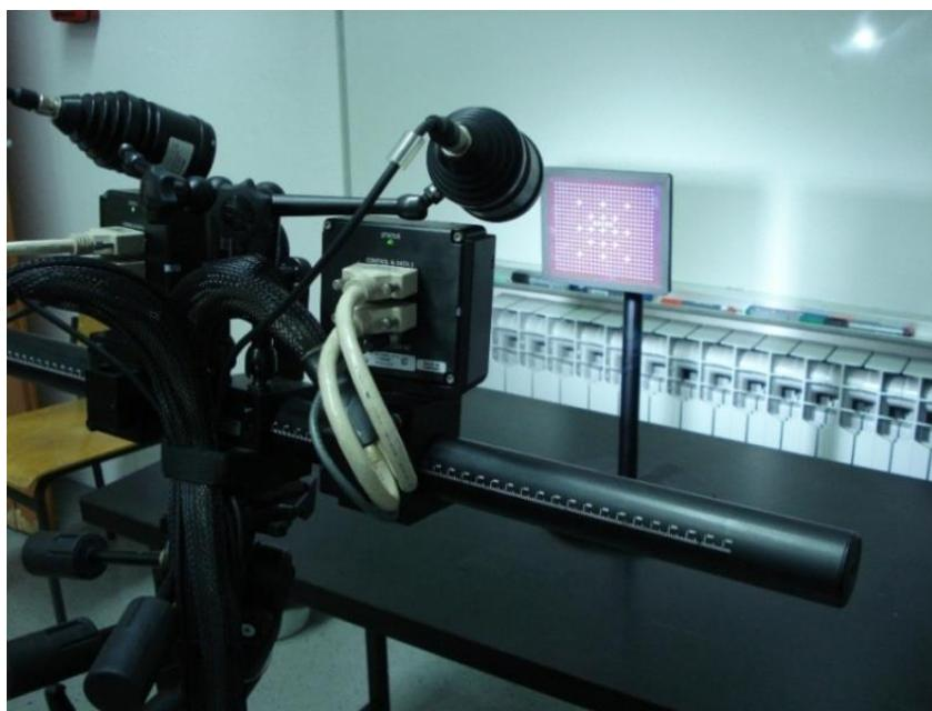
Slika 33. Kalibracija optičkog sustava *Aramis*
