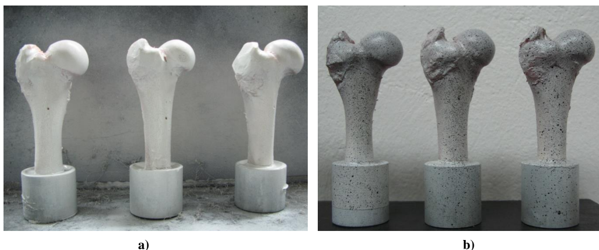
Slika 26. Nanošenje stohastičkog uzorka: a) bijela boja, b) crne točkice
