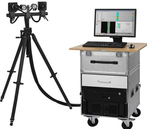
Slika 14. Optički mjerni sustav *Aramis* [86]
