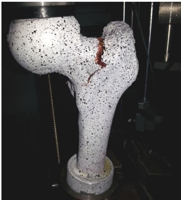
Slika 41. Lom ispitnog uzorka KF2
