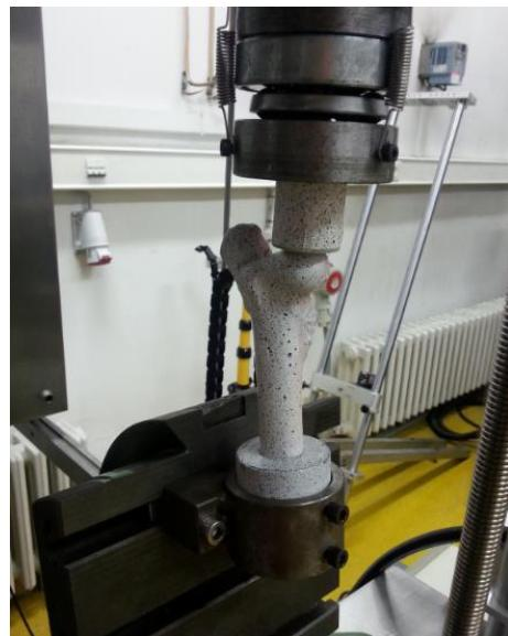
**Slika 36. Ovčji femur pozicioniran na kidalici**
