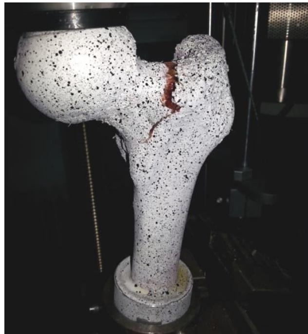
Slika 41. Lom ispitnog uzorka KF2
