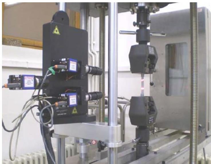
Slika 8. Mjerenje laserskim ekstenzometrom
