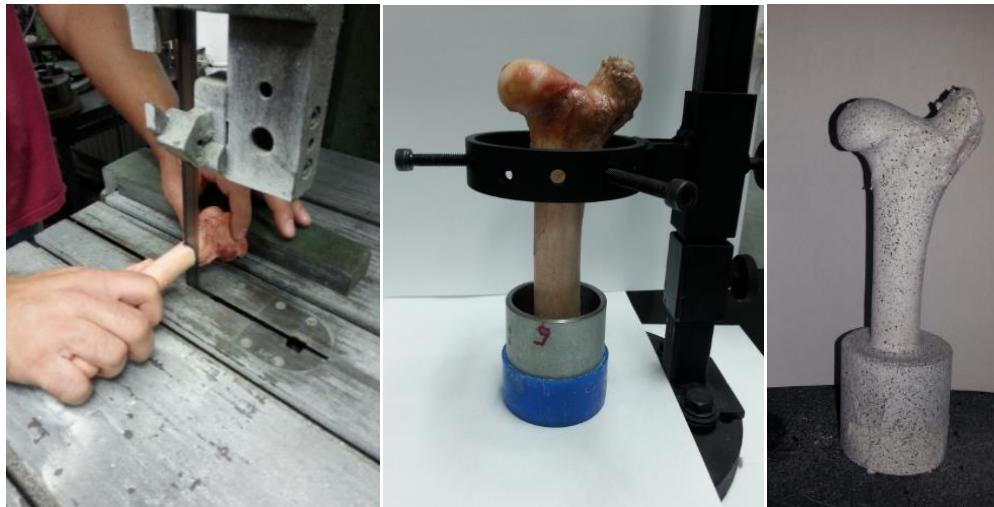
**Slika 35. Priprema ovčjeg femura za mehaničko ispitivanje**
