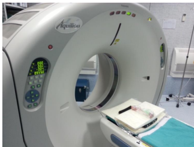
Slika 50. Skeniranje ovčjeg femura na uređaju Toshiba Aquilion MSCT
