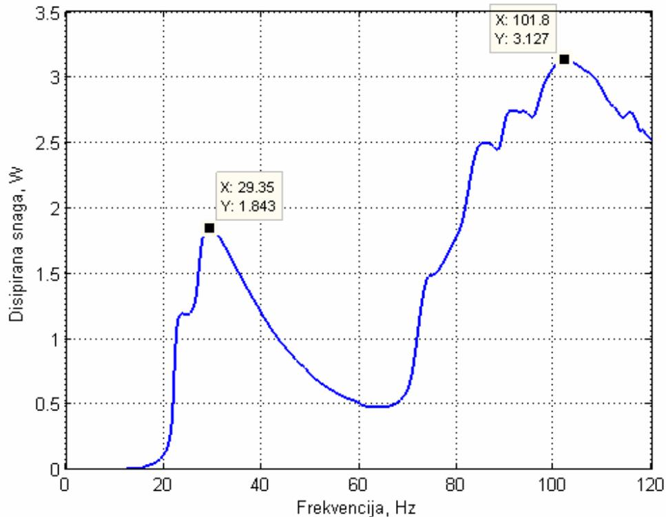
**Slika 46. Eksperimentalno snimljena krivulja disipirane snage ispitnog prigušivača**
