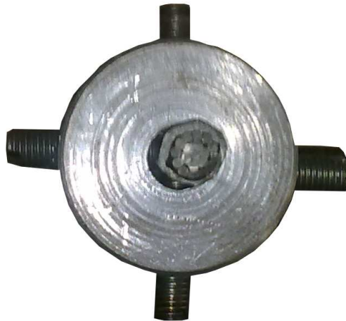
Slika 44. Uteg pričvršćen na glasničko uže
