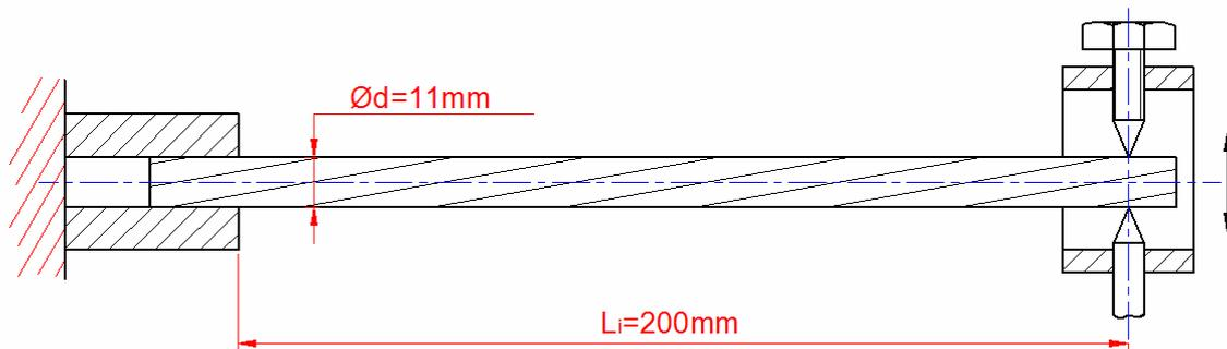
**Slika 31. Shema eksperimentalnog postava za ispitivanje prigušenja užeta**
