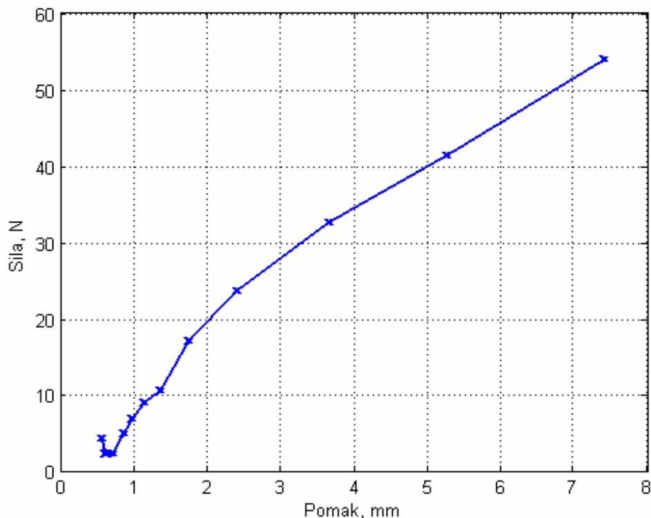
Slika 38. Krivulja sila-pomak dobivena iz mjerenja pri amplitudi brzine 100mm/s
