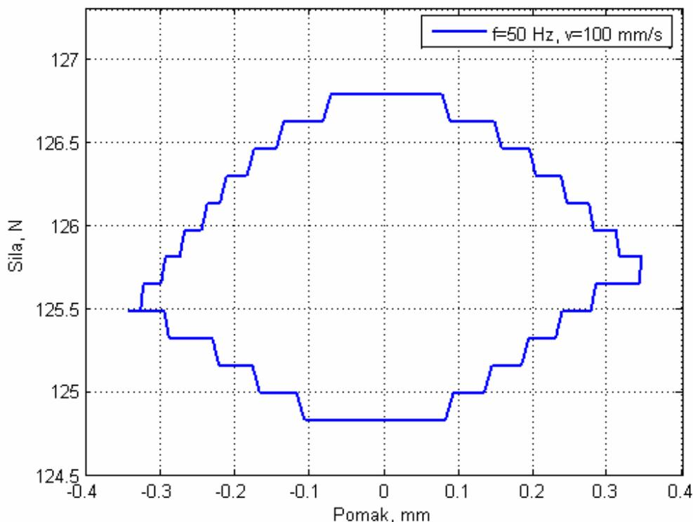
Slika 36. Petlja histerese za frekvenciju 50 Hz i amplitudu brzine 100 mm/s
