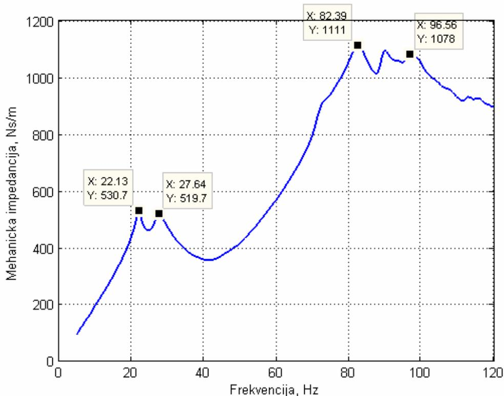
**Slika 45. Eksperimentalno snimljena krivulja impedancije ispitnog prigušivača**
