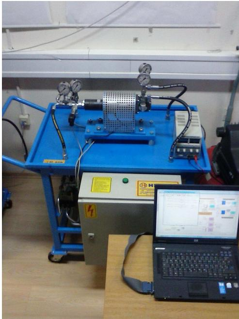
Slika 6.2: Fotografija eksperimentalnog postava rotacijskog elektrohidrauličkog servo sustava.
