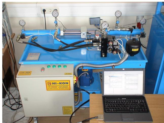
Slika 6.4: Fotografija eksperimentalnog postava translacijskog elektrohidrauličkog servo sustava.
