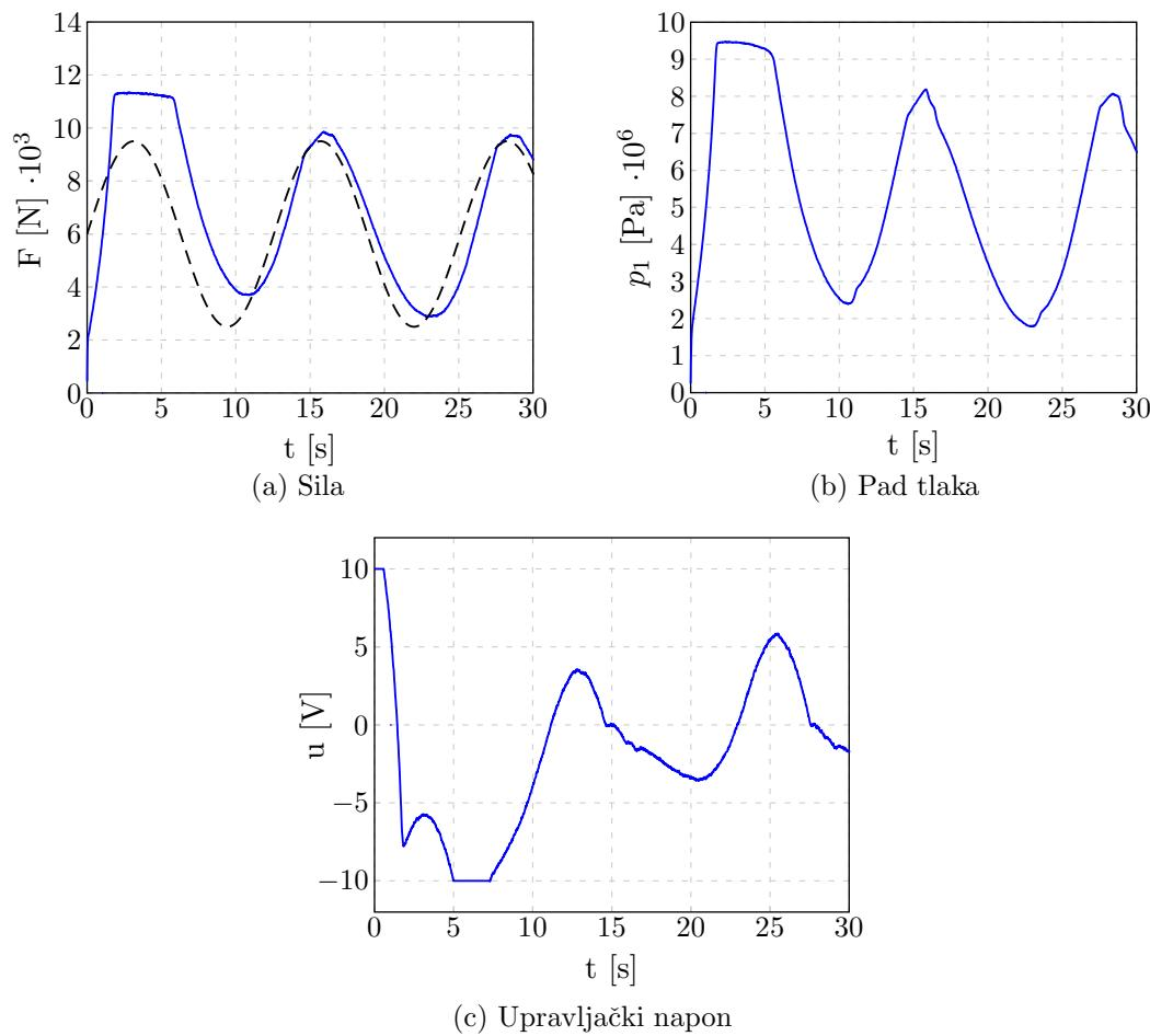
Slika 6.31: Eksperimentalni rezultati upravljanja silom primjenom PI regulatora: variabile stanja i upravljački napon u ovisnosti o vremenu.
