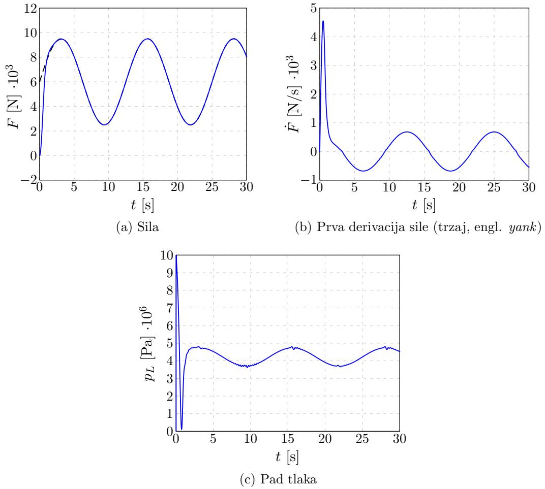
Slika 6.25: Simulacijski rezultati upravljanja silom: varijable stanja u ovisnosti o vremenu.
