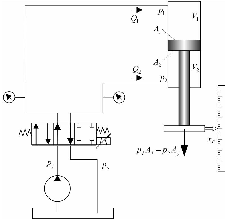
Slika 6.9: Shematski dijagram elektrohidrauličke preše za izvod matematičkog modela.
