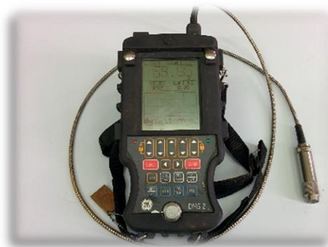
Slika 4. Ultrazvučni uređaj za mjerenje debljine s numeričkim i A prikazom
