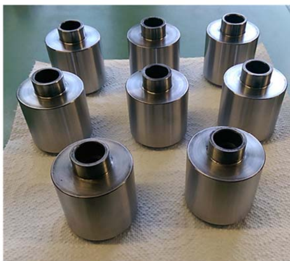
Slika 4.66 Ispitni uzorci za ispitivanje otpornosti na toplinski umor
