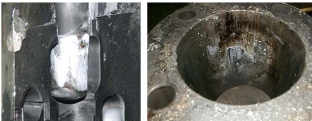
Slika 2.12 Pojava reakcijskog nataljivanja kod kalupa za tlačni lijev aluminija
