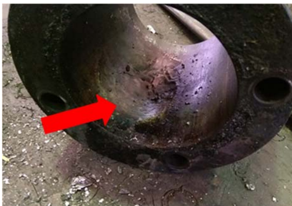
Slika 2.9 Erozijska uljavnog sustava kalupa za tlačni lijev
