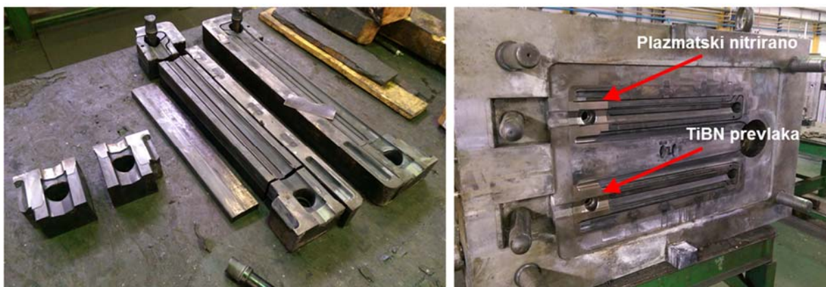
a) b) Slika 4.82 a) rastavljeni kalup za tlačni lijev radijatora od aluminijske legure ORION 600 b) ugradnja različito toplinski obrađenih gornjih glavčina
