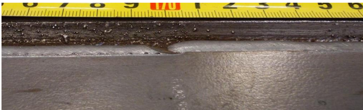
Slika 5.17 Količina kapljica u žlijebu zavora kao posljedica štrcanja kod konvencionalnog MAG zavarivanja – lijevo i CBT MAG zavarivanja – desno
