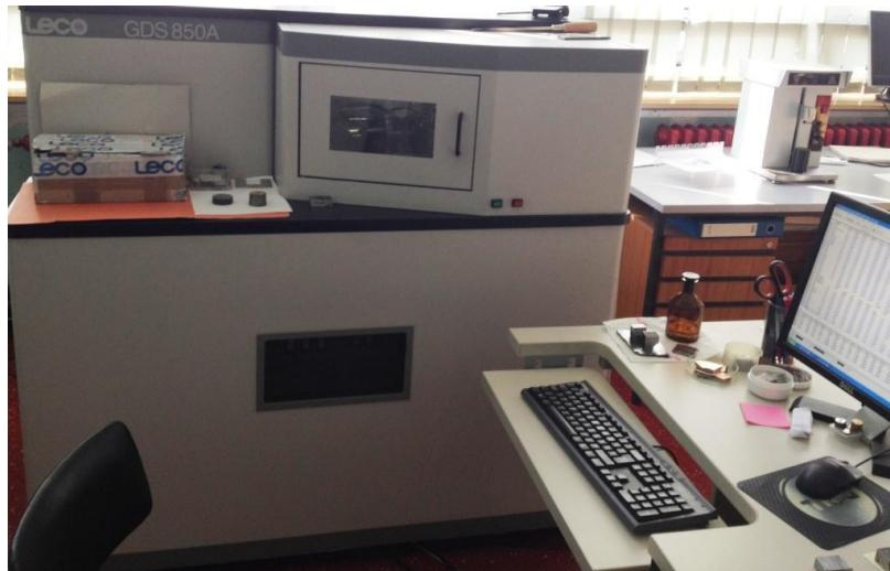
Slika 4.15 Optički emisijski spektrometar GDS 850, LECO
