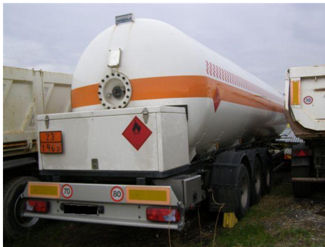
Slika 2.6. Transport UNP-a cisternom [6]
