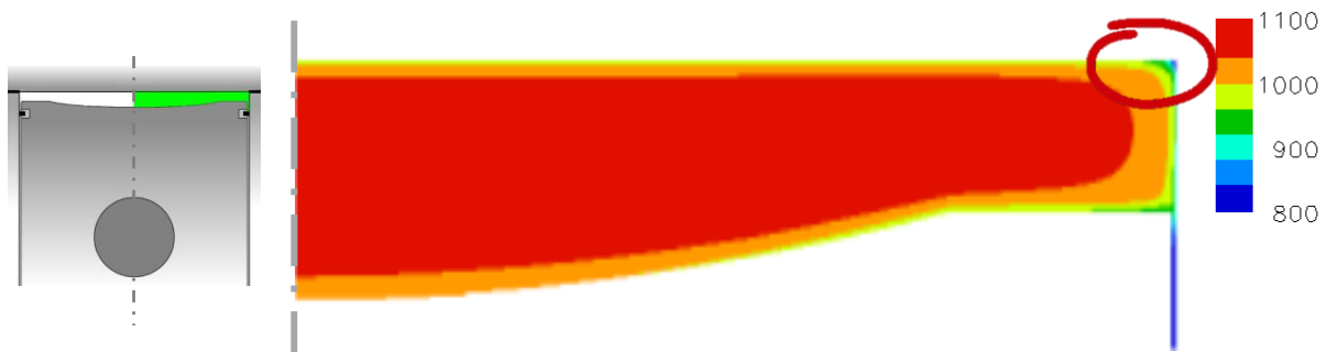
Slika 23. Temperaturna raspodjela unutar cilindra motora Cummins B – CFD simulacija [33]
