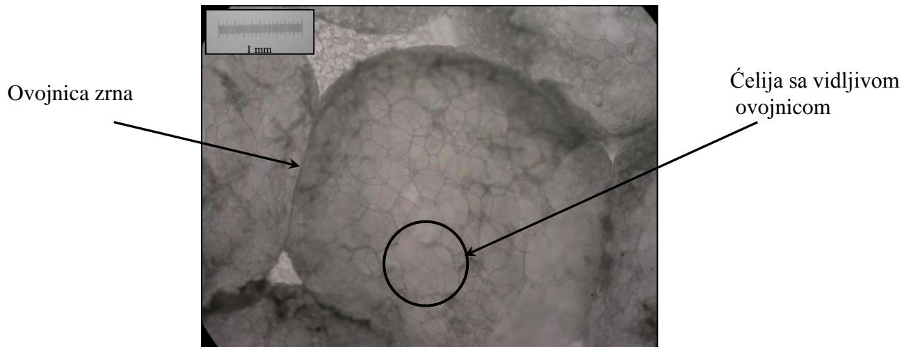
Sl.- 41. Mikrostruktura tipičnog ekspandiranoga polistirena.
