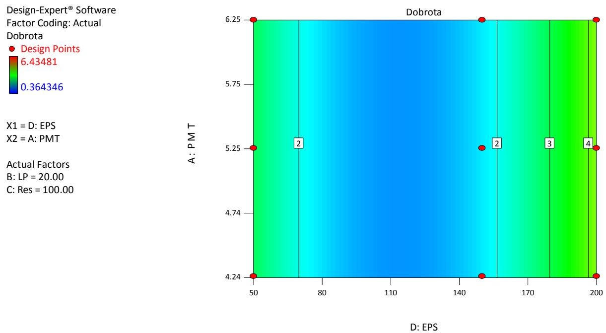
**Sl.- 69.** Konturni prikaz matematičkog modela ovisnosti odziva dobrote digitalnog zapisa radiografske slike o parametrima očitanja (konstantni su B:LP = 20 W/m<sup>2</sup> i C:Res = 100 μm).
