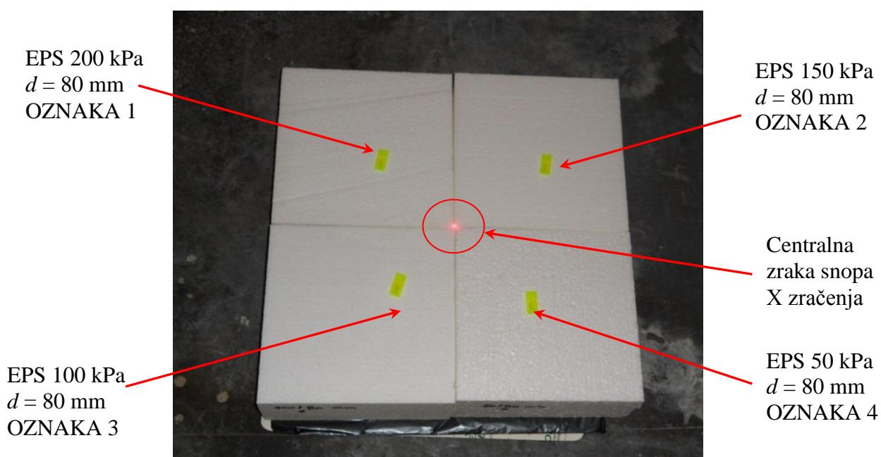
**Sl.- 54.** Postav ispitnih uzoraka na slikovnu ploču za pokus karakterizacije komponenata sustava očitanja.
