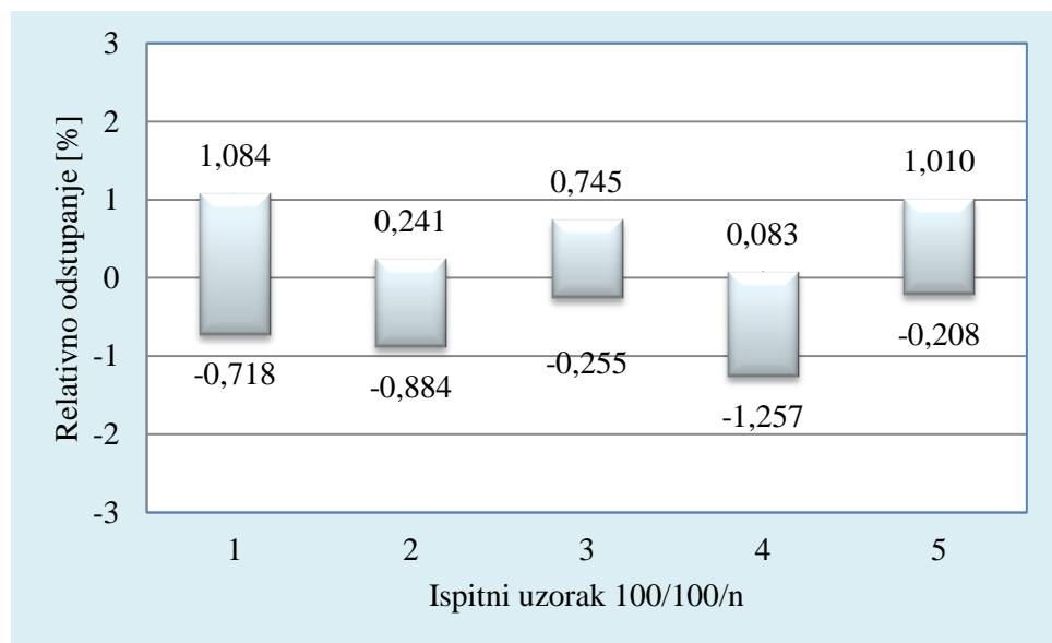
**Sl.- 85.** Relativna odstupanja,  $\Delta\rho_{\text{rel}}$ , modelom određenih strukturnih gustoća,  $\rho_n$ , uzoraka označke 100/100/n, gdje je  $n = 1$  do 5, dobivenih za pet eksponiranja, od prividnih gustoća dobivenih normiranim metodom HRN EN 1602,  $\rho_{\text{prividno}}$ .
