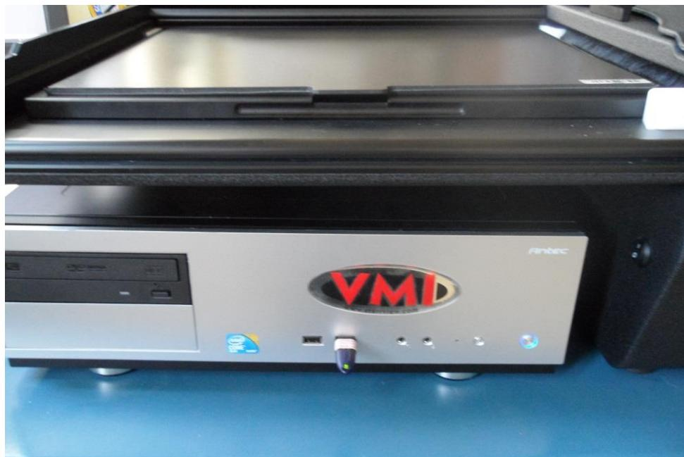
**Sl.- 36.** Prikaz elementa skenera slikovnih ploča sustava računalne radiografije VMI 5100MS u koji je umetnuta slikovna ploča i StarrView radna stanica.
