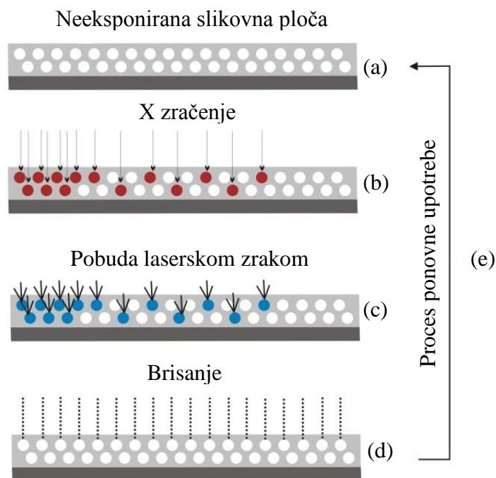
**Sl.- 1.** Proses eksponiranja, očitanja i brisanja slikovnih ploča [34].
