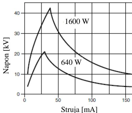
**Sl.- 33.** Ovisnost napona o struji za promjere fokusa 1 mm (donja) i 3 mm (gornja) rendgenske cijevi uređaja ISOVOLT mobil [81].
