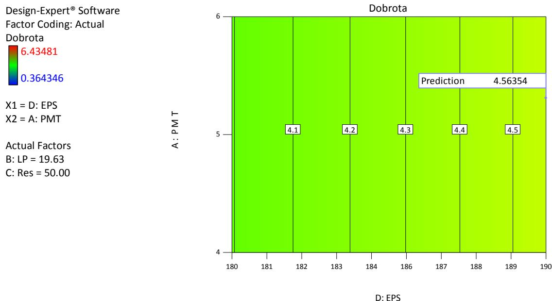
**Sl.- 74.** Konturni prikaz dobrote u ovisnosti o tlačnoj čvrstoći (D:EPS) i pojačanju fotomultiplikatorske cijevi (A:PMT) (stvarne vrijednosti snage laserske zrake B: LP = 19,63 W/m<sup>2</sup> i razlučivosti C: Res = 50 μm).
