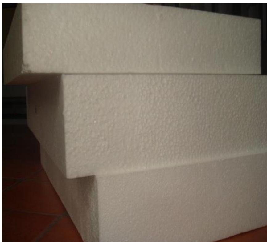
**Sl.- 27.** Toplinsko-izolacijske ploče ekspandiranoga polistirena.
