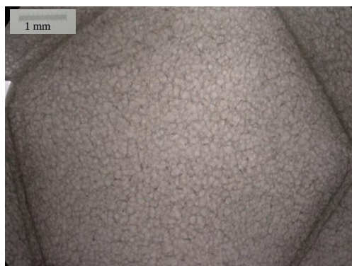
a) ekspanirani polistiren tlačne čvrstoće 50 kPa
