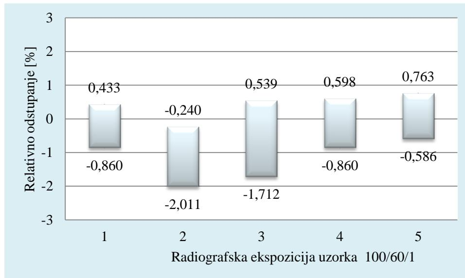
**Sl.- 80.** Relativna odstupanja,  $\Delta\rho_{\text{rel}}$ , modelom određene strukturne gustoće,  $\rho_n$ , uzorka oznake 100/60/1 od gustoće izmjerene normiranim metodom HRN EN 1602,  $\rho_{\text{prividno}}$ , za ukupno pet eksponiranja.
