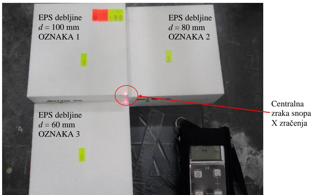
**Sl. - 43.** Postav uzorka na slikovnoj ploči tijekom karakterizacije komponenata sustava eksponiranja.
