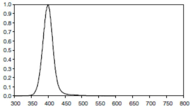
Sl.- 37. Spektar PSL odziva slikovnih ploča KODAK INDUSTREX Flex s  $\text{BaFBr}_{0,85}\text{I}_{0,15}:\text{Eu}^{2+}$  fotoosjetljivim slojem [43].
