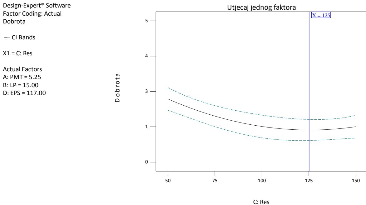
**Sl.- 72.** Prikaz ponašanja odziva dobrote u ovisnosti o razlučivosti (konstantni su A:PMT= 5,25 V, B:LP = 15 W/m<sup>2</sup> i D:EPS = 117 kPa).
