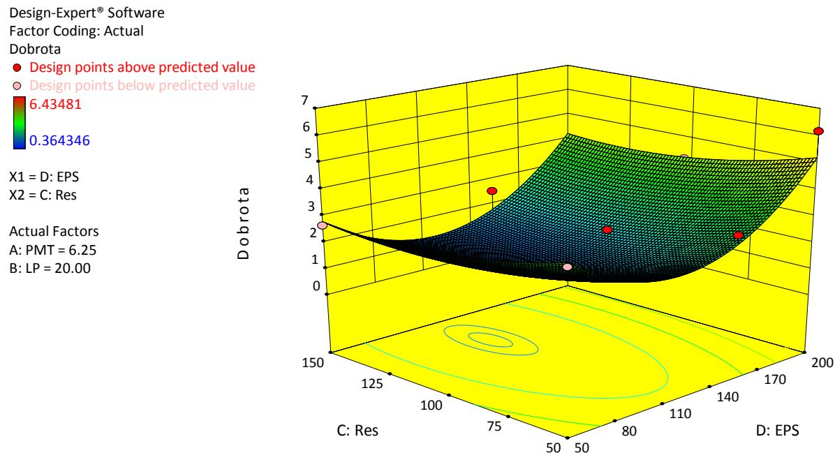
**Sl.- 68.** 3D prikaz matematičkog modela ovisnosti odziva dobrote digitalnog zapisa radiografske slike o parametrima očitanja (konstantni su A:PMT = 6,25 V i B:LP = 20 W/m<sup>2</sup>).
