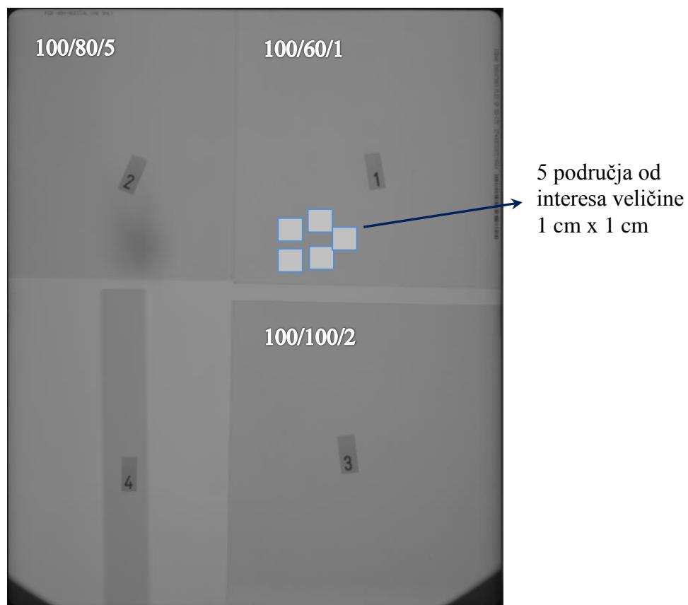
**Sl.- 82.** Digitalni zapis radiografske slike (jedna radiografska ekspozicija) pokusa za određivanje utjecaja strukture EPS-a na varijabilnost modelom određene strukturne gustoće ekspandiranoga polistirena.
