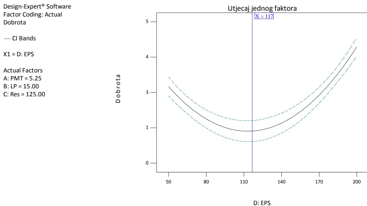
**Sl.- 71.** Prikaz ponašanja odziva dobrote u ovisnosti o tlačnoj čvrstoći uzorka (konstantni su A:PMT= 5,25 V, B:LP = 15 W/m<sup>2</sup> i C:Res = 125 μm).
