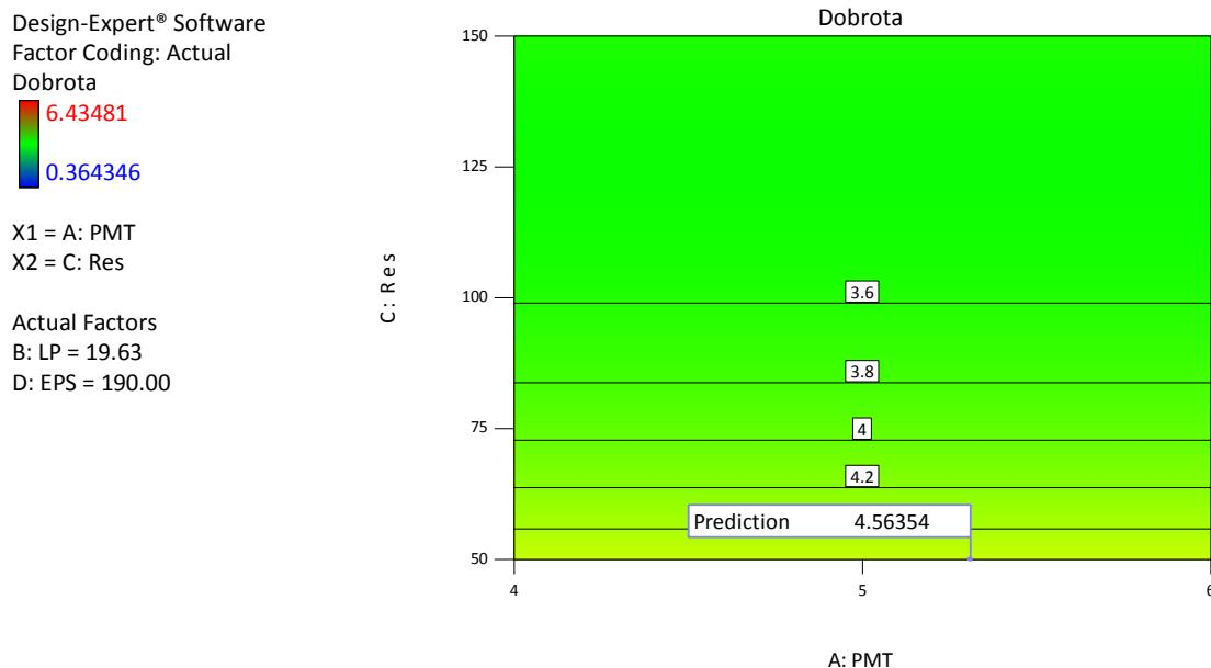
**Sl.- 75.** Konturni prikaz dobrote u ovisnosti o razlučivosti (C:Res) i pojačanju fotomultiplikatorske cijevi (A:PMT) (stvarne vrijednosti snage laserske zrake B: LP = 19,63 W/m<sup>2</sup> i tlačne čvrstoće D:EPS = 190 kPa).
