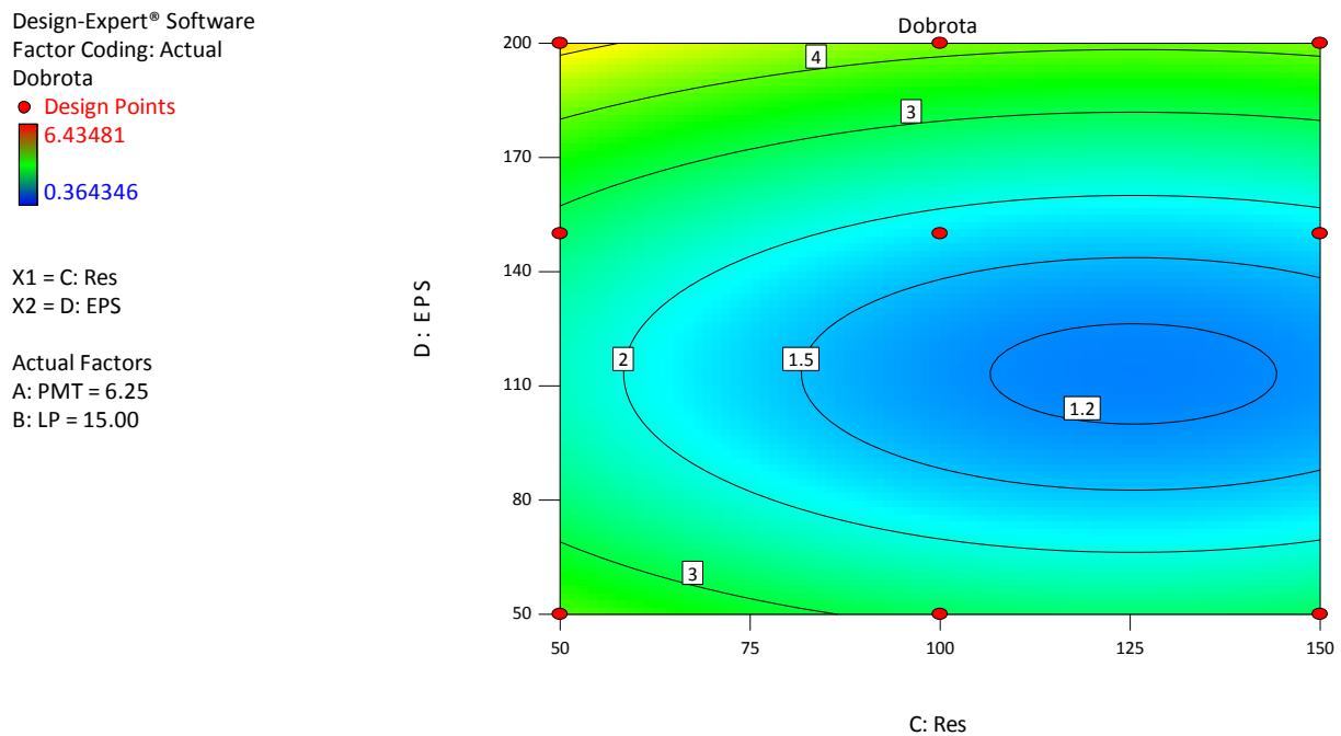
**Sl.- 67.** Konturni prikaz matematičkog modela ovisnosti odziva dobrote digitalnog zapisa radiografske slike o parametrima očitanja (konstantni su A:PMT = 6,25 V i B:LP = 15 W/m<sup>2</sup>).
