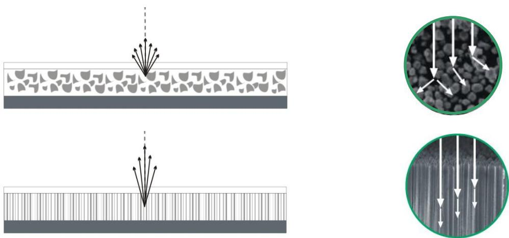
Sl.- 5. Aktivni sloj slikovne ploče neusmjereni strukture (gore) i usmjereni strukture (dolje).
