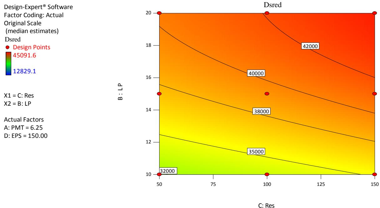
**Sl.- 62.** Konturni prikaz matematičkog modela ovisnosti intenziteta zacrnjenja piksela digitalnog zapisa radiografske slike o parametrima očitanja (konstantni su A:PMT = 6,25 V i D:EPS = 150 kPa).
