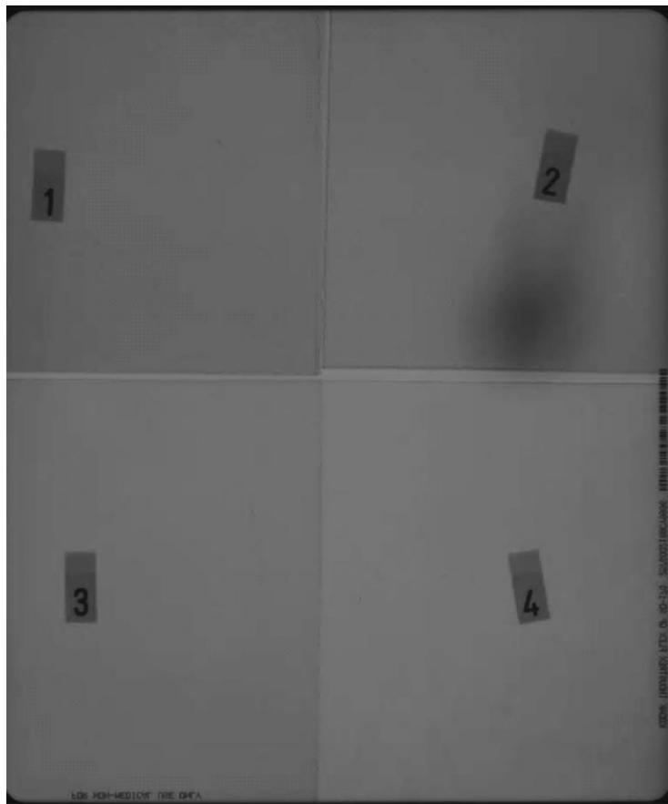
**Sl.- 55.** Digitalni zapis radiografske snimke (parametri eksponiranja: napon na rendgenskoj cijevi 15 kV, vrijeme 120 s, struja 3,5 mA i parametri očitanja: napon pojačanja PMT 4,25 V, gustoća snage (intezitet zračenja lasera)  $10 \text{ W/m}^2$  i razlučivost  $50 \mu\text{m}$ ).
