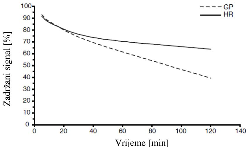
Sl.- 7. Zadržavanje latentne slike u vremenu  $\text{BaFBr}_{0,85}\text{I}_{0,15}:\text{Eu}^{2+}$  slikovnih ploča [43].
