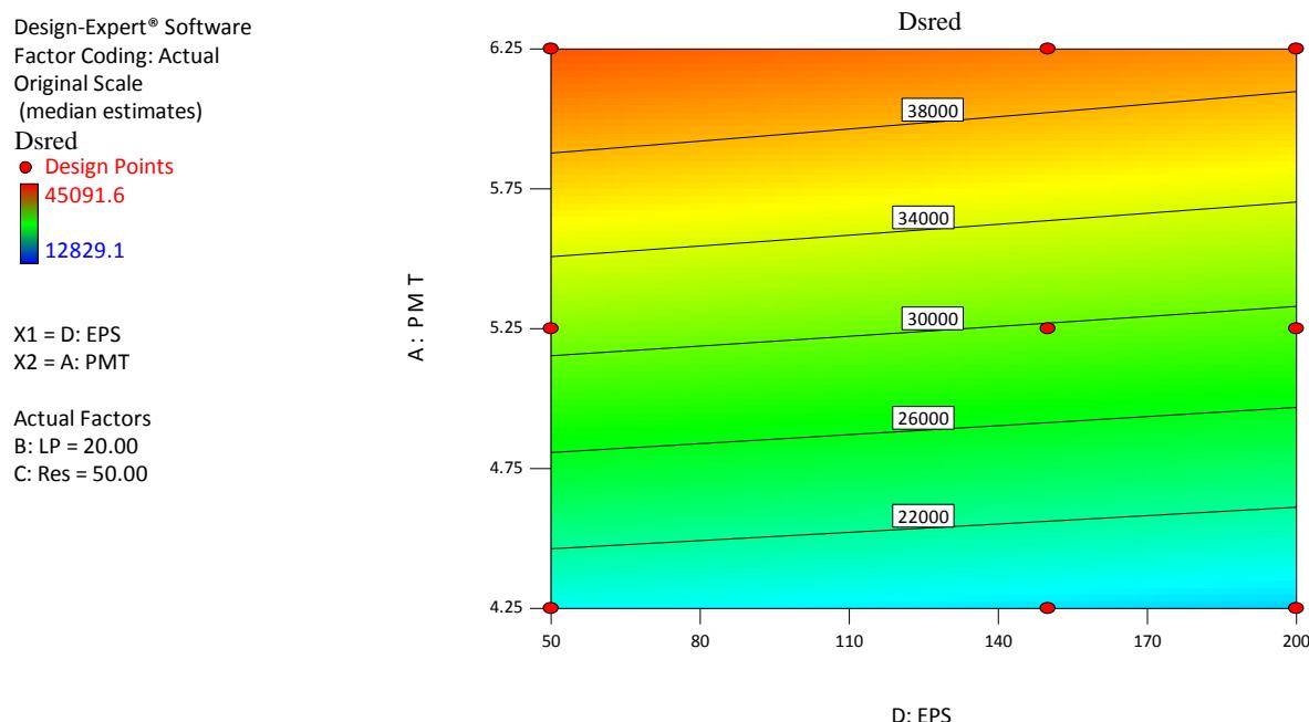
**Sl.- 61.** Konturni prikaz matematičkog modela ovisnosti intenziteta zacrnjenja piksela digitalnog zapisa radiografske slike o parametrima očitanja (konstantni su B:LP = 20 W/m<sup>2</sup> i C:Res = 50  $\mu\text{m}$ ).
