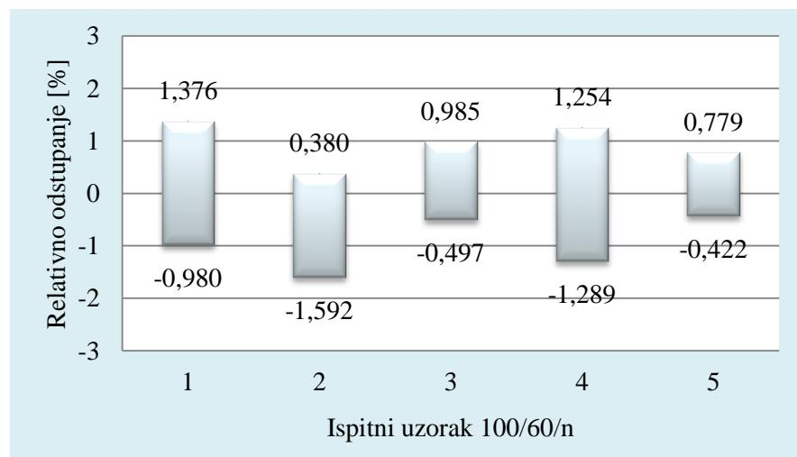
**Sl.- 83.** Relativna odstupanja,  $\Delta\rho_{\text{rel}}$ , modelom određenih strukturalnih gustoća,  $\rho_n$ , uzoraka označke 100/60/n, gdje je  $n = 1$  do 5, dobivenih za pet eksponiranja, od prividnih gustoća dobivenih normiranim metodom HRN EN 1602,  $\rho_{\text{prividno}}$ .
