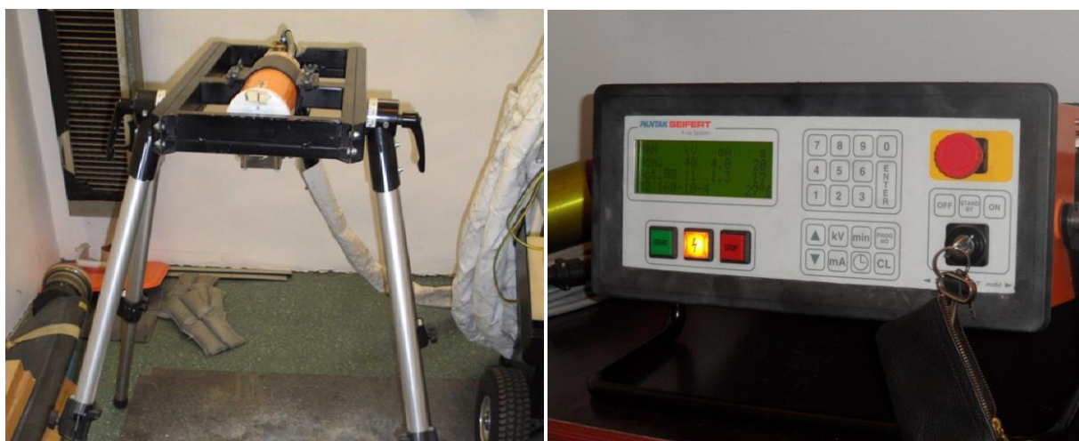
Sl.- 32. Rendgenski uređaj ISOVOLT mobil s rendgenskom cijevi ISOVOLT 160 M2 0.4/1.5 (lijevo) s upravljačkom jedinicom (desno).
