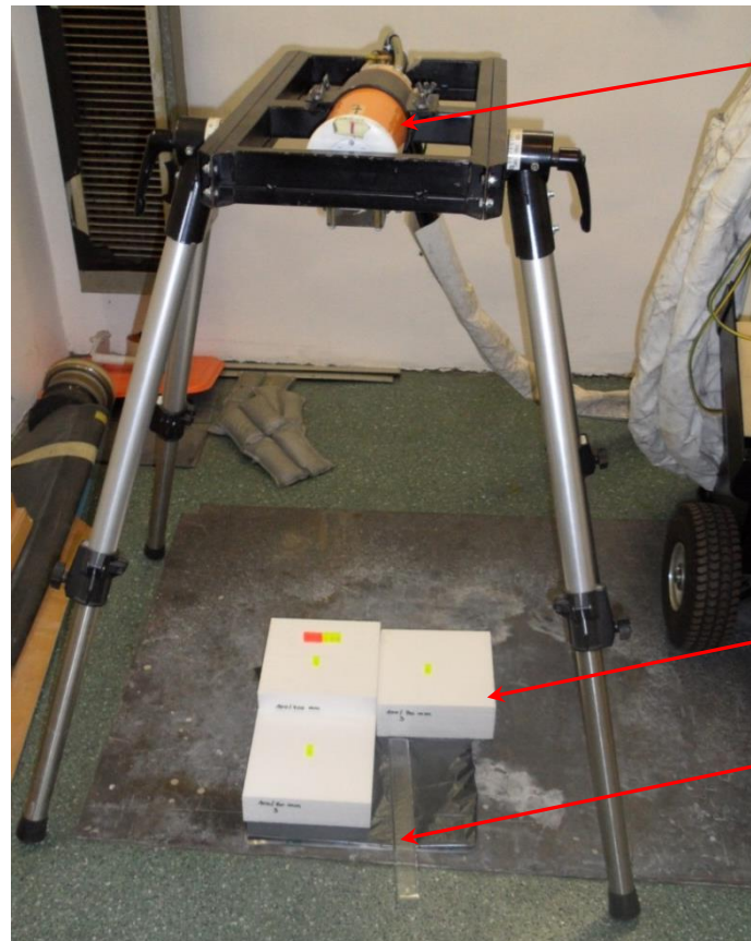
Sl.- 42. Postav ispitnih uzoraka i rendgenska cijev.
