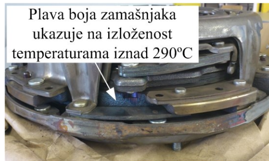
Slika 8-26: Fotografija 37k spojke
