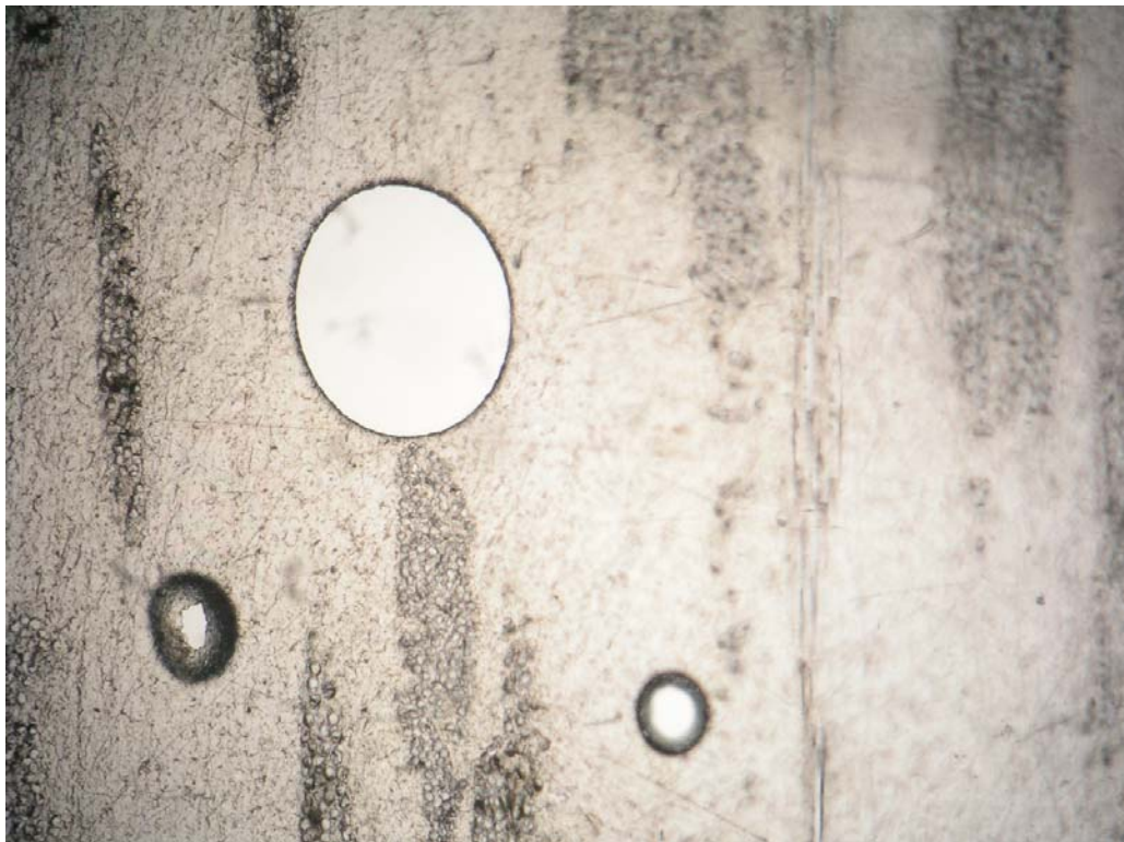
Slika 5. Mikrostruktura laminata od nezasićene poliesterske smole i staklenih vlakana, snimak 5
