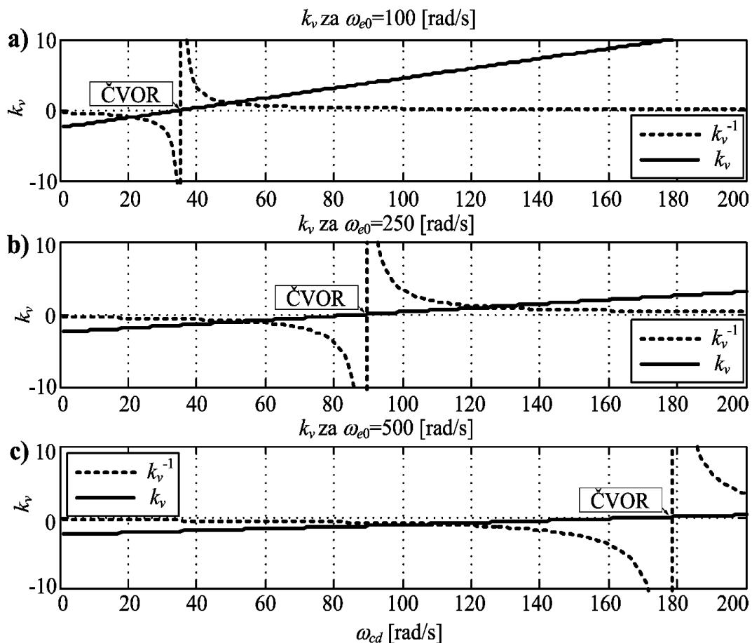
Slika 3-19: 4MHT varijatorski prijenosni omjer za brzine SUI motora (a)  $\omega_{e0} = 100 \text{ rad/s}$ , (b)  $\omega_{e0} = 250 \text{ rad/s}$  i (c)  $\omega_{e0} = 500 \text{ rad/s}$ .
