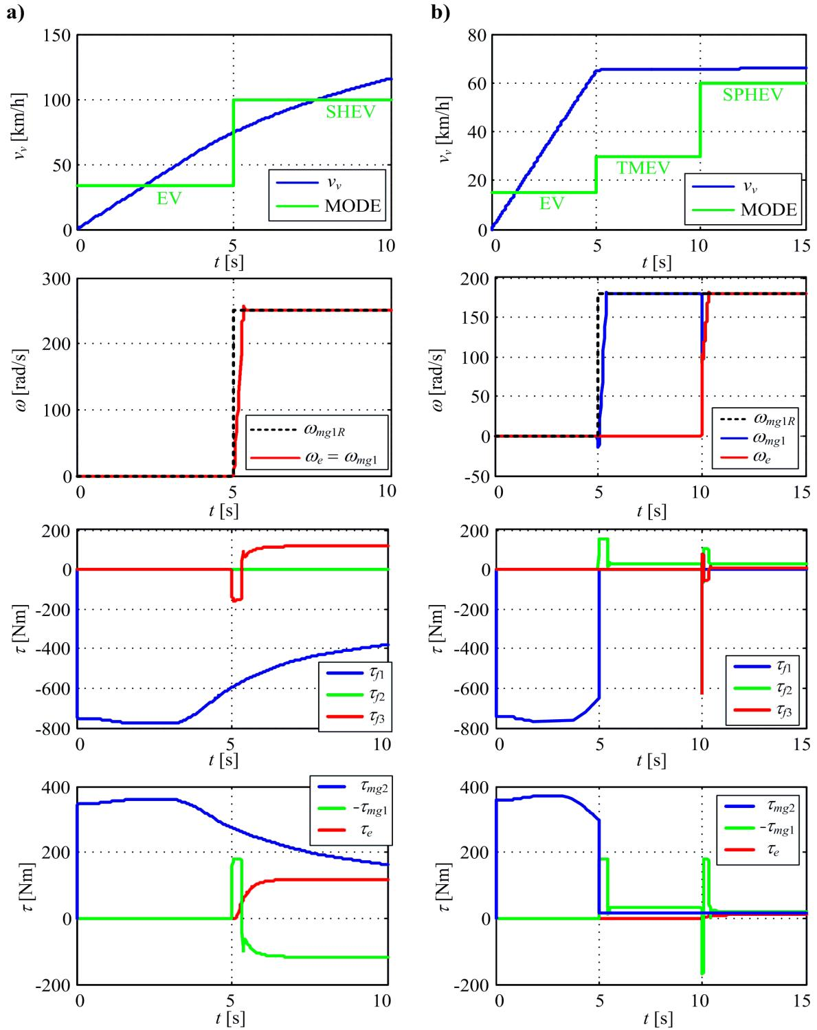
Slika 5-4: Vremenski odzivi brzine vozila  $v_v$ , brzine vrtnje M/G1 i SUI motora ( $\omega_{mg1}$  i  $\omega_e$ ), okretni momenti pojedine spojke i okretni momenti pojedinog stroja prilikom zaleta vozila (a) iz EV u SHEV i (b) iz EV u TMEV zatim u SPHEV način rada.
