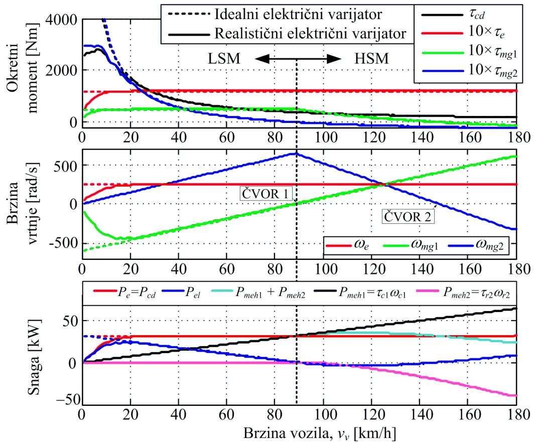
Slika 3-11: *Statičke karakteristike idealnog (isprekidane linije) i realističnog (pone linije) režima električnog varijatora 2MHT pogona pri optimalnoj brzini i maksimalnom momentu SUI motora.*
