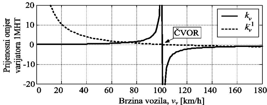
Slika 3-2: *IMHT varijatorski prijenosni omjer za brzinu SUI motora iznosa  $\omega_e = 250$  rad/s.*
