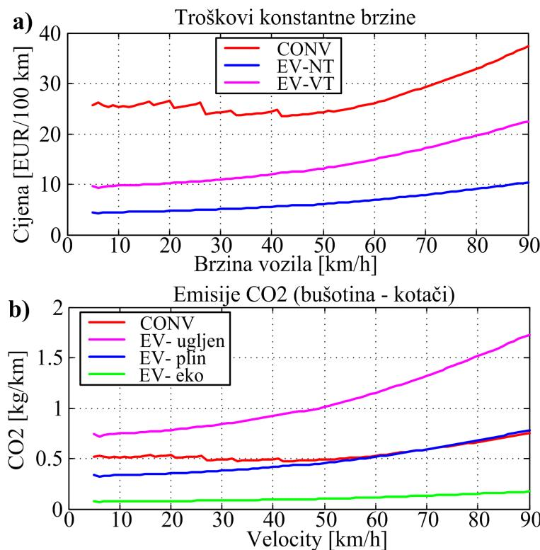
Slika 6-12: Usporedba cijene pogonske energije po prijeđenom kilometru (a) i emisija CO<sub>2</sub> od bušotine do kotača za konvencionalno (CONV) i električno vozilo (EV) za vožnju konstantnom brzinom.
