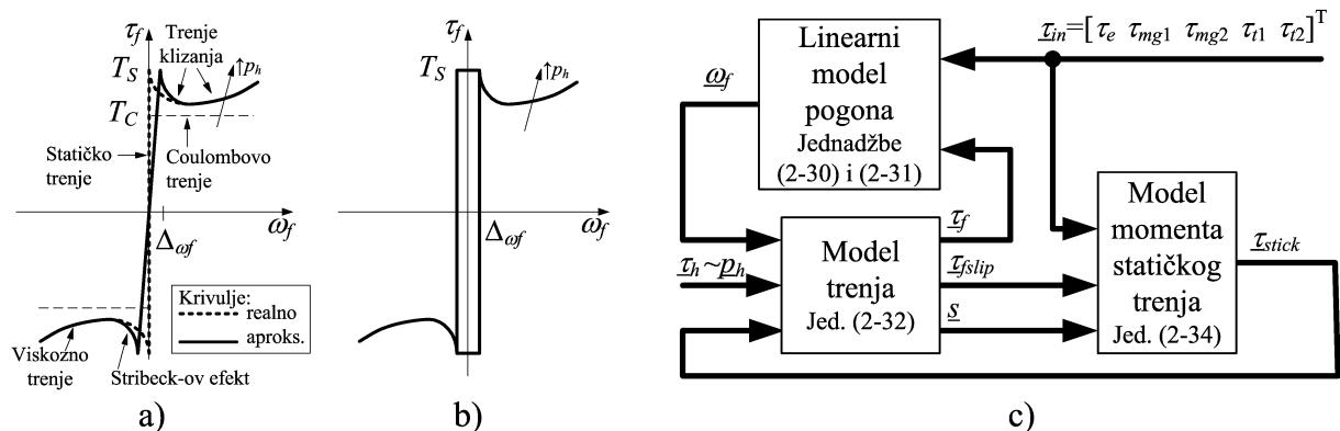
Slika 2-16: Klasični model trenja (a), Karnopp-ov model trenja (b), i struktturni blokovski dijagram cjelokupnog modela pogona temeljenog na Karnopp-ovom modelu trenja (c).
