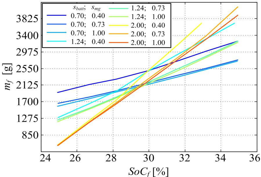
Slika 6-18: Karakteristike globalno-optimalne potrošnje goriva u ovisnosti o krajnjem stanju napunjenoosti baterije i dimenzijskim parametrima pogona.
