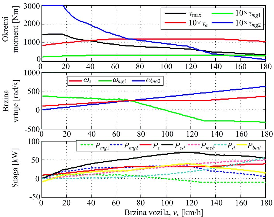
Slika 3-7: Statičke karakteristike 1MHT pogona u punom hibridnom režimu rada pri optimalnoj brzini i maksimalnom momentu SUI motora.
