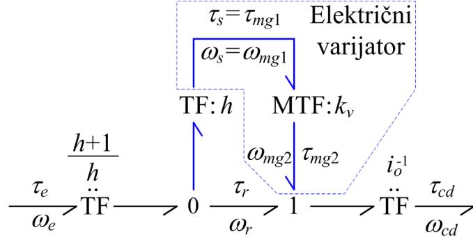
Slika 3-1: *Ilustrativni vezni dijagram varijatorskog režima rada za 1MHT pogon uz naznačen električni tok snage (plavo).*
