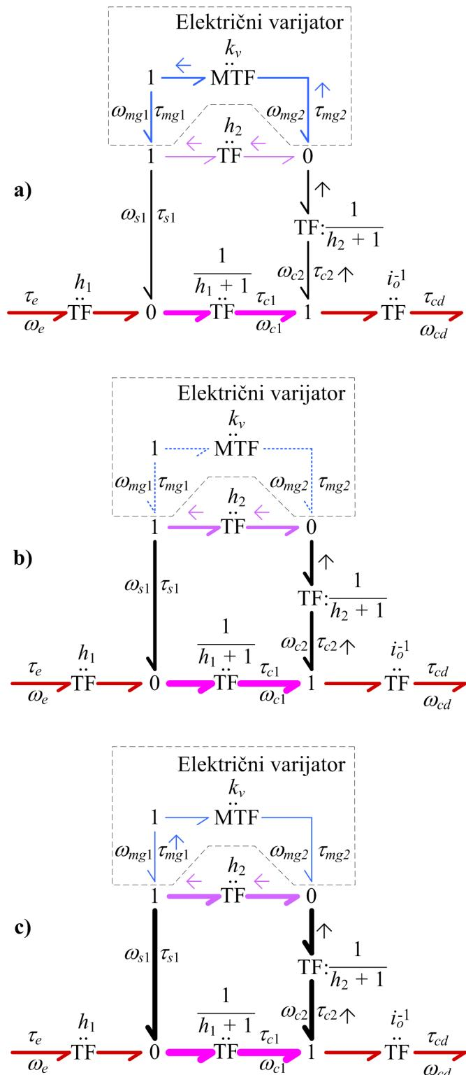
Slika 3-10: Analiza toka snage za 2MHT kao električni varijator: (a) srednje brzine vozila (90-140 km/h), (b) druga čvorisna točka (155 km/h) i (c) velike brzine vozila (160-180 km/h).
