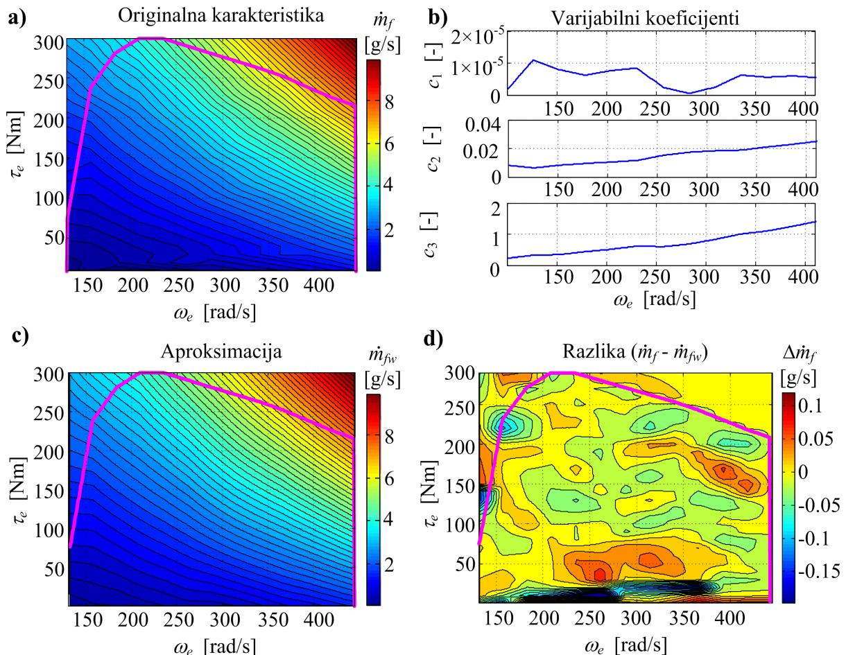
Slika 6-16: *Originalna karakteristika maksimalnog okretnog momenta i potrošnje goriva 92 kW Dieselovog motora (a), koeficijenti aproksimacije (b), aproksimirana karakteristika (c) i pogreška aproksimacije (d).*
