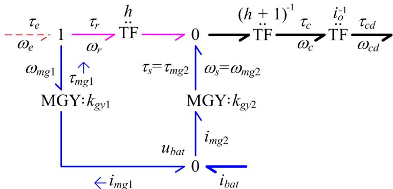
Slika 3-20: Ilustracija toka snage 4MHT pogona za TMEV način rada.
