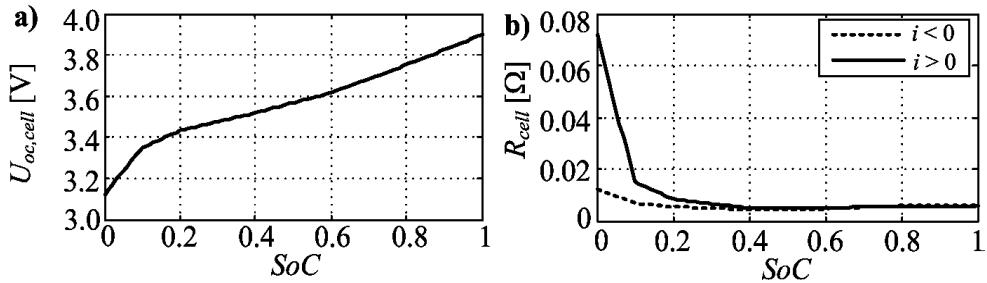
Slika 6-9: Karakteristike napona otvorenog kruga jedne čelije Li-Ion baterije u ovisnosti o SoC
