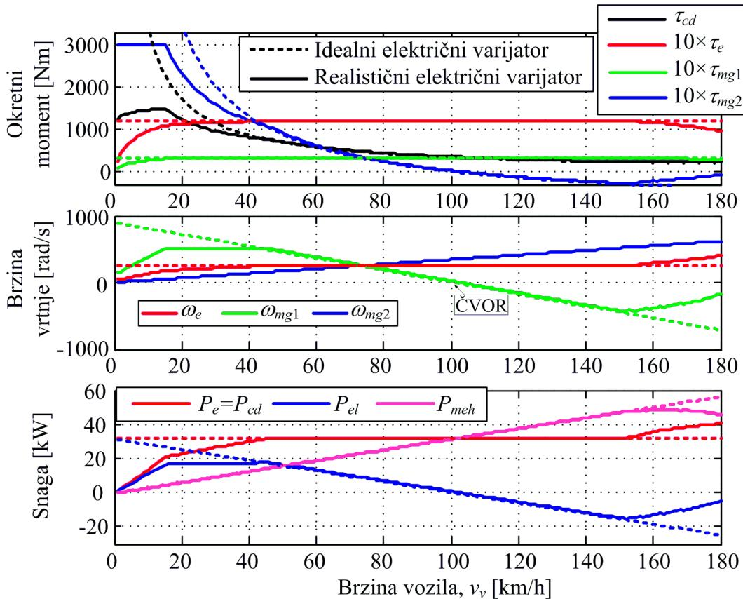
Slika 3-4: Statičke karakteristike idealnog (ispredidane linije) i realističnog (pone linije) rezima električnog varijatora 1MHT pogona pri optimalnoj brzini i maksimalnom momentu SUI motora.
