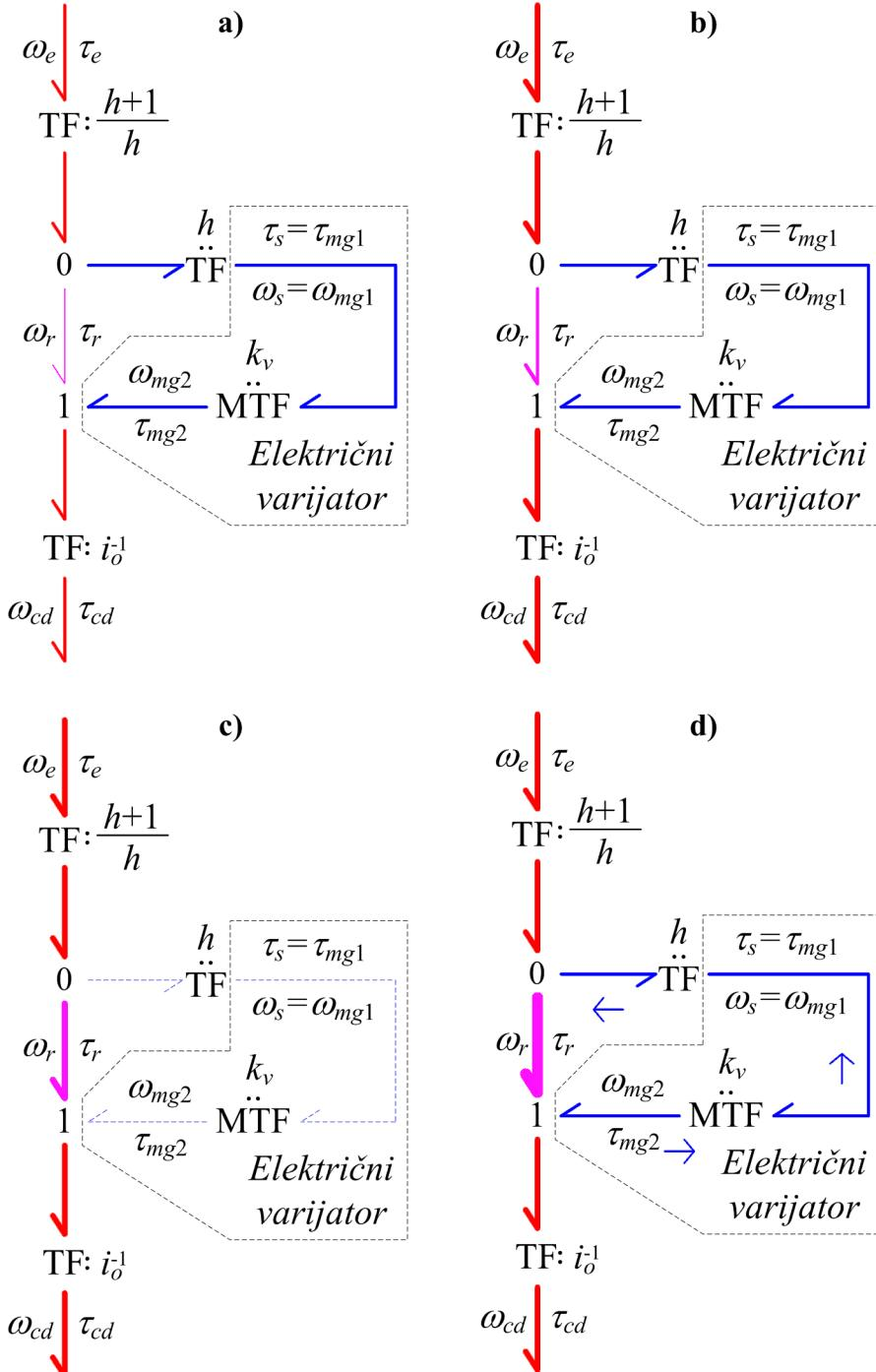
Slika 3-3: Analiza toka snage za 1MHT kao električni varijator: (a) male brzine vozila (0-20 km/h), (b) srednje brzine vozila (20-100 km/h), (c) brzina čvorisne točke (100 km/h) i (d) velike brzine vozila (100-180 km/h).
