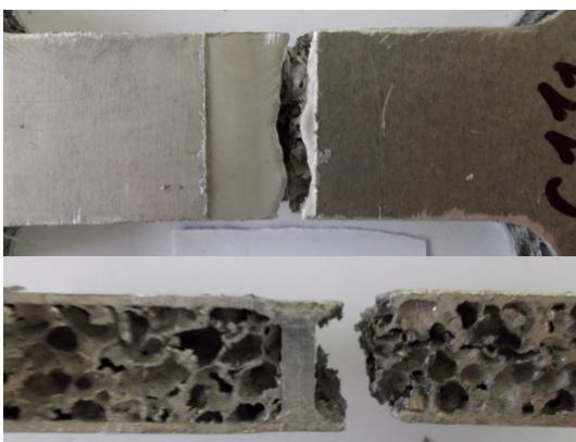
Slika 6.47. Prijelom epruvete C111
