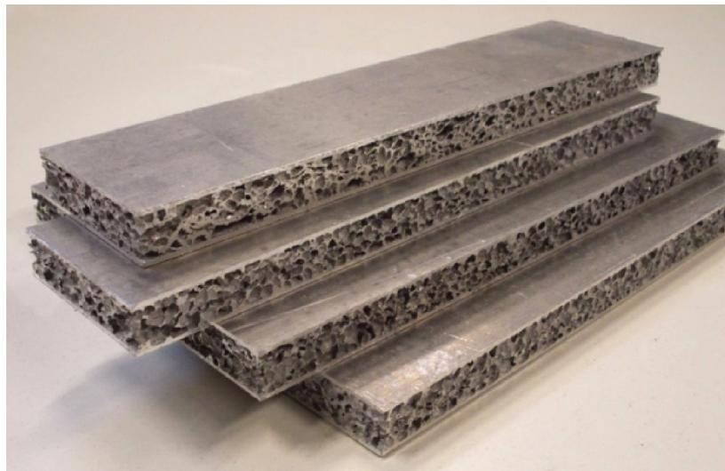
Slika 2.13. Aluminijski sendvič paneli s aluminijskom pjenom kao jezgrom
