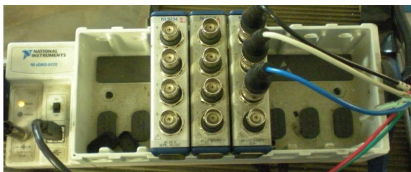
Slika 5.15. National Instruments kućište cDAQ-9172 s priključenim modulom 9215
