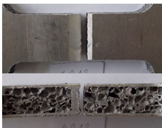
Slika 6.42. Prijelom epruvete B212
