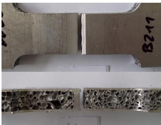
Slika 6.41. Prijelom epruvete B211
