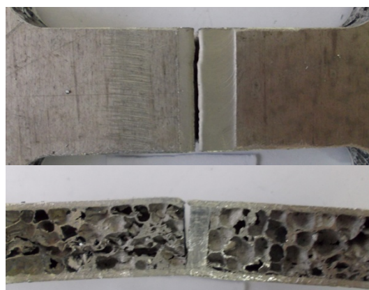
Slika 6.44. Prijelom epruvete B092
