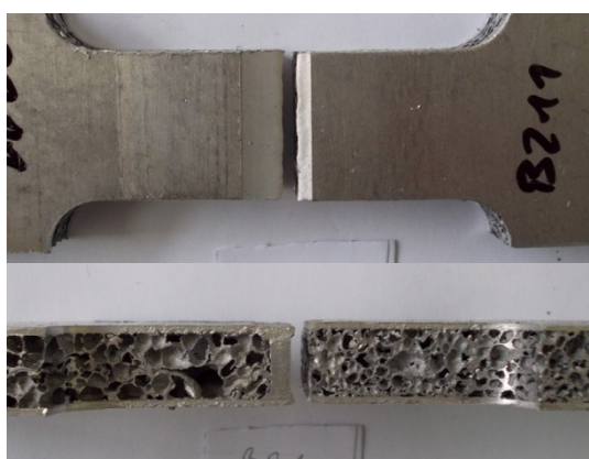
Slika 6.41. Prijelom epruvete B211
