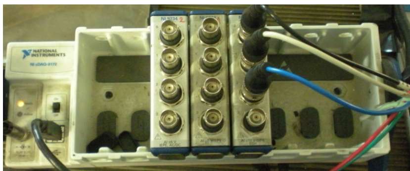
Slika 5.15. National Instruments kućište cDAQ-9172 s priključenim modulom 9215
