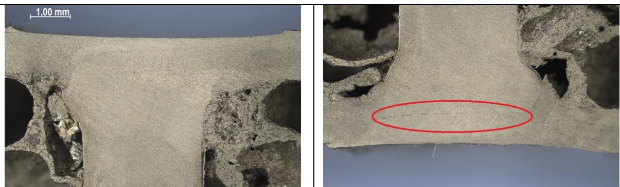
Spoj A07; brzina zavarivanja = 23 mm/min; kut nagiba alata =  $3^\circ$
