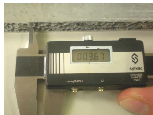
Slika 5.2. Mjerjenje promjera pora digitalnim pomičnim mjerilom
