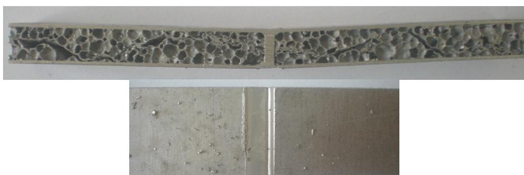
Slika 6.65. Prijelom epruvete A124
