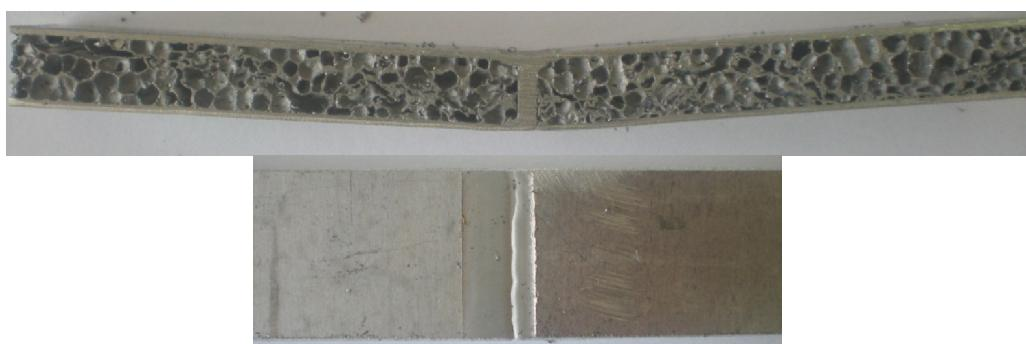
Slika 6.67. Prijelom epruvete B093
