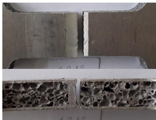
Slika 6.42. Prijelom epruvete B212
