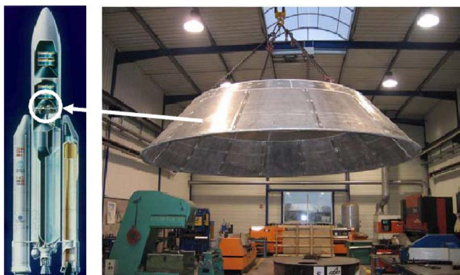
Slika 4.20. Prototip konusnog potpornja unutar tijela rakete „Ariane 5“ [27]
