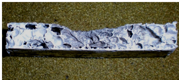
Slika 4.15 Urušavanje ćelijaste strukture kao rezultat prekomjernog dovođenja topline TIG zavarivanjem.
