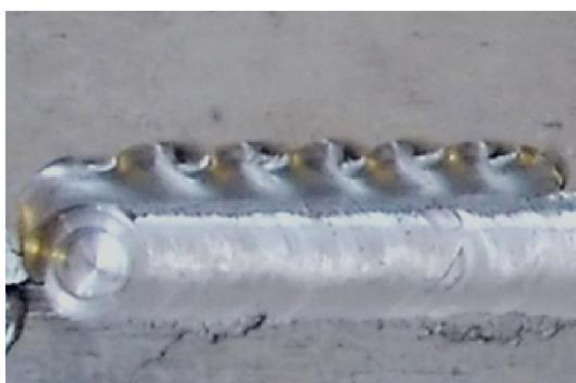
Slika 3.20. Primjer zavara s prekomjernim istiskivanjem materijala
