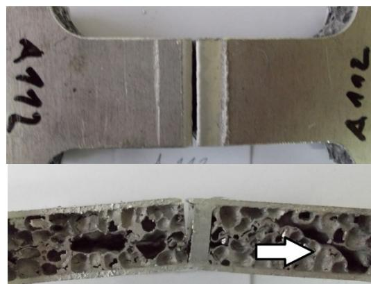
Slika 6.32. Prijelom epruvete A112
