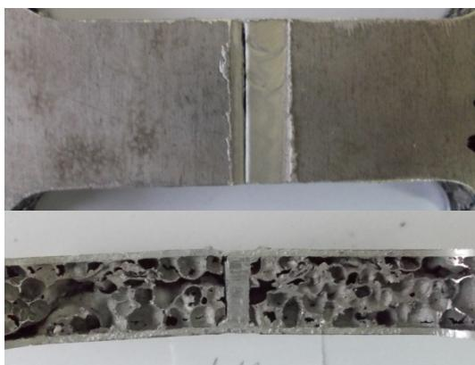
Slika 6.33. Prijelom epruvete A131
