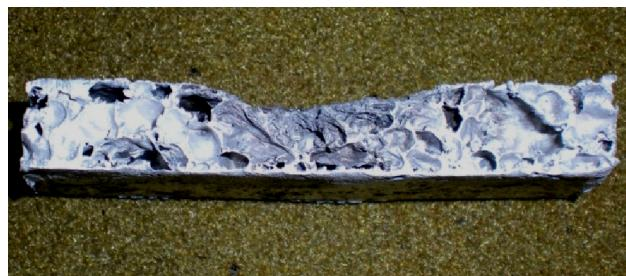
Slika 4.15 Urušavanje čelijaste strukture kao rezultat prekomjernog dovođenja topline TIG zavarivanjem.
