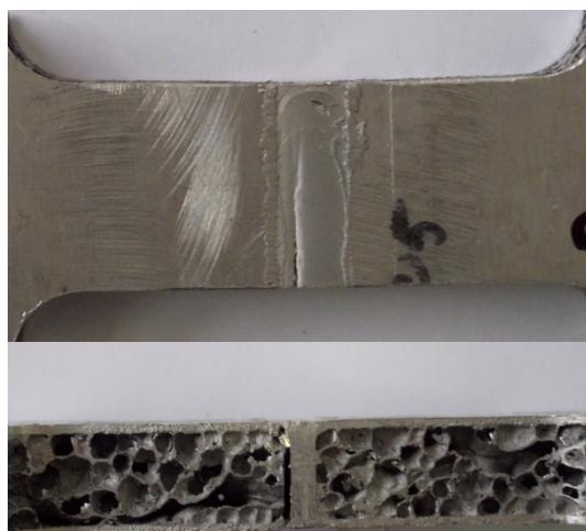
Slika 6.38. Prijelom epruvete B152
