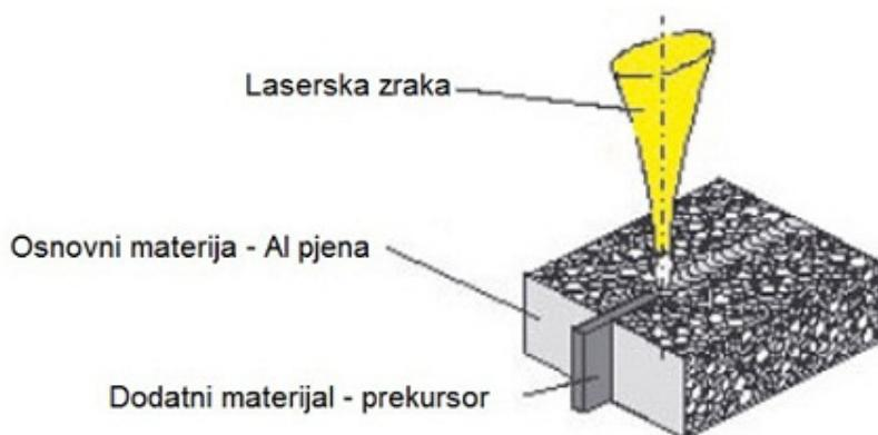
Slika 4.16. Princip laserskog zavarivanja aluminijске pjene s dodatnim materijalom – prekursorom [113]
