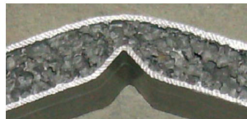
Slika 4.9. Deformacija uzorka nakon ispitivanja [105]
