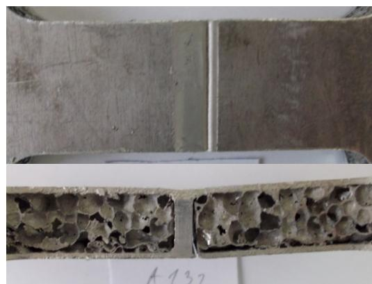
Slika 6.34. Prijelom epruvete A132
