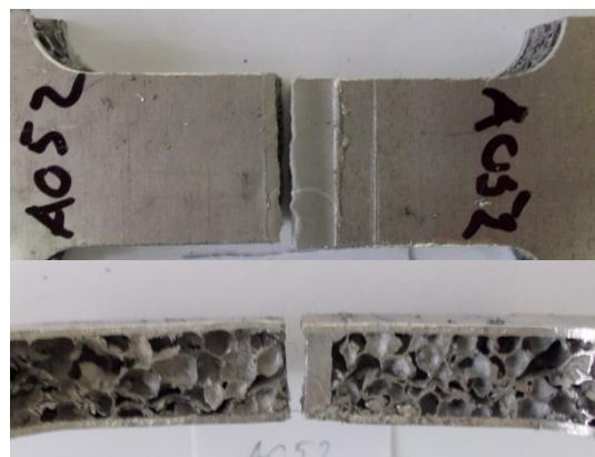
Slika 6.30. Prijelom epruvete A052
