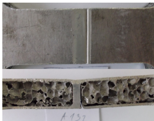
Slika 6.34. Prijelom epruvete A132
