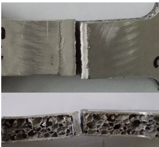
Slika 6.37. Prijelom epruvete B151
