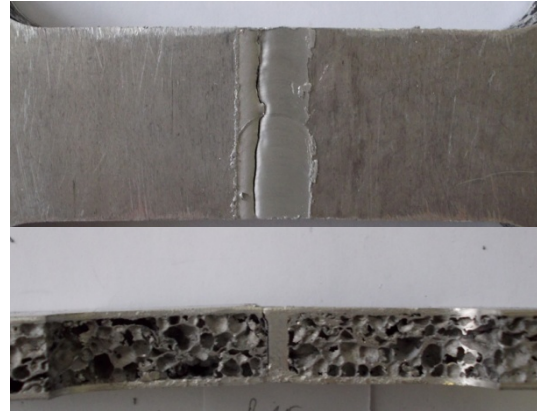
Slika 6.40. Prijelom epruvete B172
