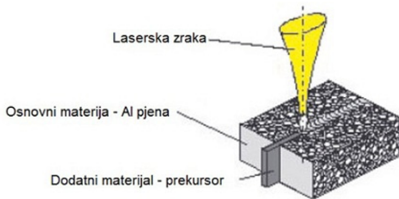
Slika 4.16. Princip laserskog zavarivanja aluminijske pjene s dodatnim materijalom – prekursorom [113]
