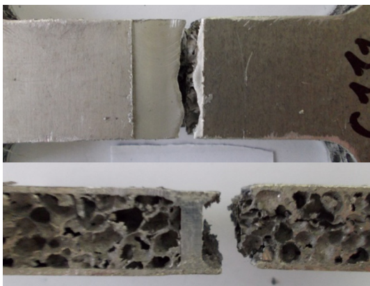
Slika 6.47. Prijelom epruvete C111
