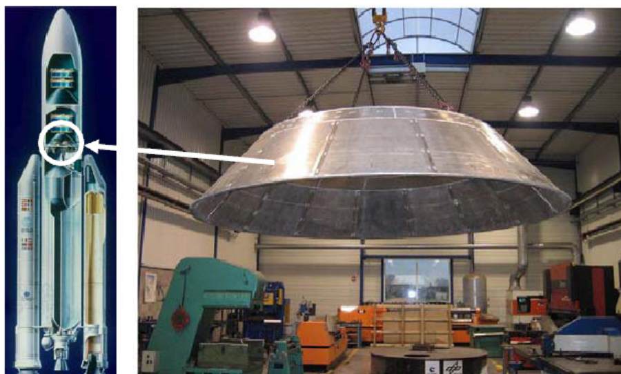
Slika 4.20. Prototip konusnog potpornja unutar tijela rakete „Ariane 5“ [27]
