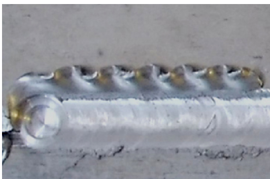
Slika 3.20. Primjer zavara s prekomjernim istiskivanjem materijala
