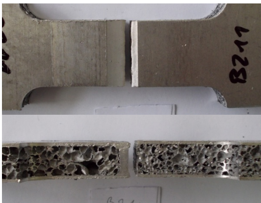
Slika 6.41. Prijelom epruvete B211
