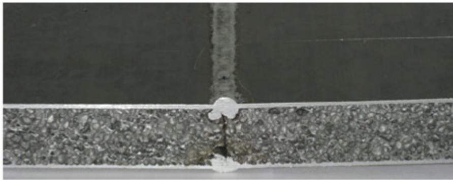
Slika 4.21. Zavareni spoj aluminijskih sendvič panela izveden TIG zavarivanjem [105]
