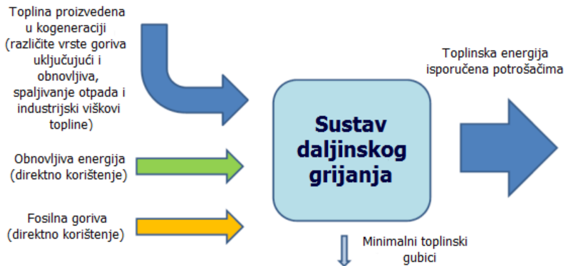
Slika 3.1. Temeljna ideja modernog sustava daljinskog grijanja [31]
