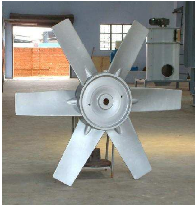
Slika 1.1 Rotor aksijalnog ventilatora
